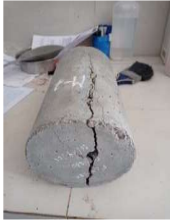
Figura 22. Falla de rotura del espécimen de concreto.
