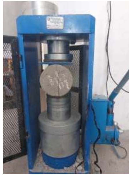
Figura 18: falla de fractura ensayo a la tracción f'c=210 Kg/cm 2 y f'c.=280 Kg/cm 2
