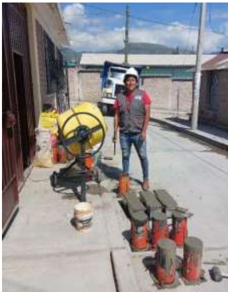
Figura 03: Elaboración de las probetas y vigas de concreto para f'c=210 \text{ Kg/cm}^2 y f'c.=280\text{Kg/cm}^2 .
