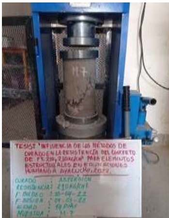
Figura 18. Falla de rotura de concreto.
