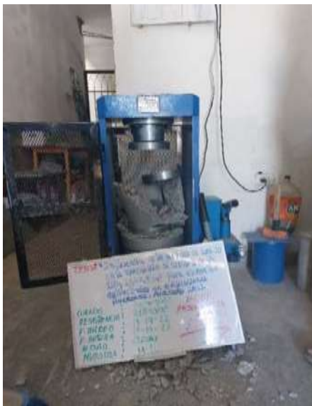
Figura 19: Falla de rotura de concreto, Ensayo de la resistencia a la compresión de concreto f'c=210 \text{ Kg/cm}^2 y f'c.=280\text{Kg/cm}^2
