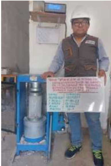
Figura 17: Ensayo de la resistencia a la compresión de concreto f'c=210 \text{ Kg/cm}^2 y f'c.=280\text{Kg/cm}^2
