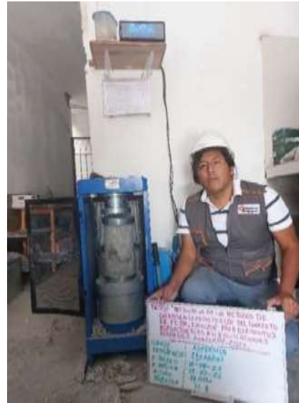
Figura 18: Ensayo de la resistencia a la compresión de concreto f'c=210 \text{ Kg/cm}^2 y f'c.=280\text{Kg/cm}^2
