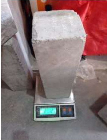
Figura 13: pesado y medición de vigas de concreto de f'c=210 \text{ Kg/cm}^2 y f'c.=280\text{Kg/cm}^2 .
