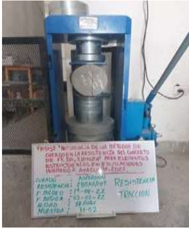
Figura 21. Ensayo a la resistencia de tracción.
