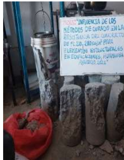
Figura 20: Falla de rotura de concreto f'c=210 \text{ Kg/cm}^2 y f'c.=280\text{Kg/cm}^2 .
