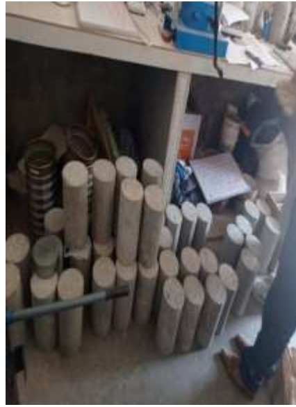
Figura 10: extracción de las probetas concreto curadas, para ser pesados y medidos.
