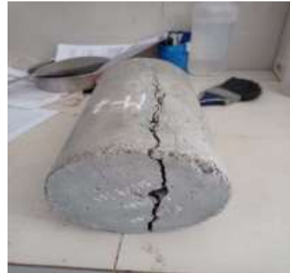
Figura 38. Falla de rotura resistencia a Tracción.
