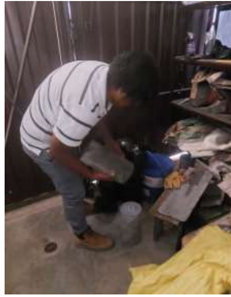
Figura 08: Extracción de curado de plástico de concreto f'c=210 \text{ Kg/cm}^2 y f'c.=280\text{Kg/cm}^2 .
