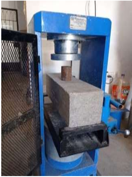
Figura 17: Ensayo de la resistencia a la flexión, carga aplicada a un tercio de la viga de concreto f'c=210 \text{ Kg/cm}^2 y f'c.=280\text{Kg/cm}^2
