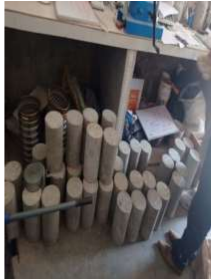
Figura 14: extracción de las probetas concreto curadas, para ser pesados y medidos.
