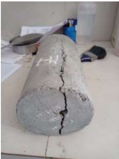
Figura 19: fractura de concreto ensayo a la tracción f'c=210 Kg/cm 2 y f'c.=280 Kg/cm 2 .
