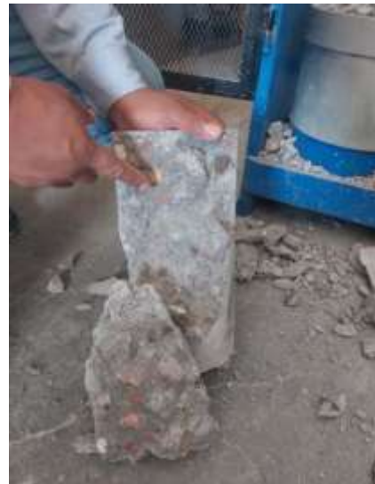
Figura 32. Falla de rotura resistencia a compresión.
