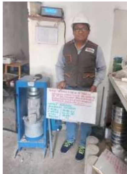
Figura 16: Ensayo de la resistencia a la compresión de concreto f'c=210 \text{ Kg/cm}^2 y f'c.=280\text{Kg/cm}^2 .
