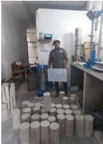
Figura 15: testigos a fracturar ensayo a la compresión de f'c=210 \text{ Kg/cm}^2 y f'c.=280\text{Kg/cm}^2 .
