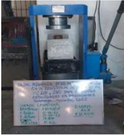
Figura 43. Ensayo resistencia a la Flexión.
