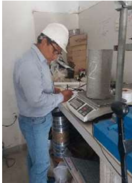
Figura 11: Proceso del pesaje de testigo de concreto para el concreto f'c=210 Kg/cm 2 y f'c.=280 Kg/cm 2 .
