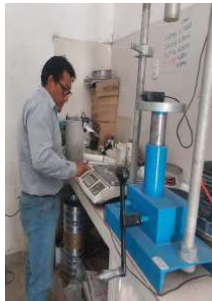
Figura 12: Proceso de medición del diámetro y longitud de concreto f'c=210 Kg/cm 2 y f'c.=280 Kg/cm 2 .
