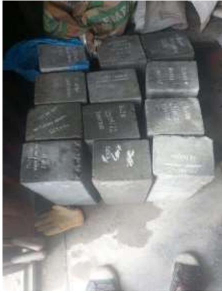
Figura 09: Extracción de curado de plástico de vigas de concreto f'c=210 Kg/cm 2 y f'c.=280 Kg/cm 2 .
