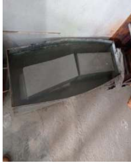
Figura 06: curado de vigas de concreto
