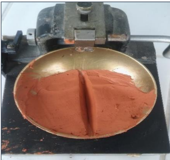
Figura N° 19: Ensayo de Limite Liquido de Arcilla de Pucapacha
