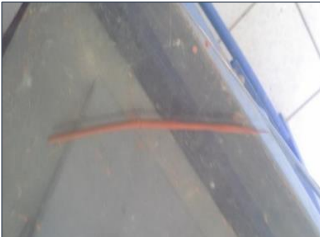
Figura N° 20: Ensayo de Limite de Plasticidad de Arcilla de Pucapacha
