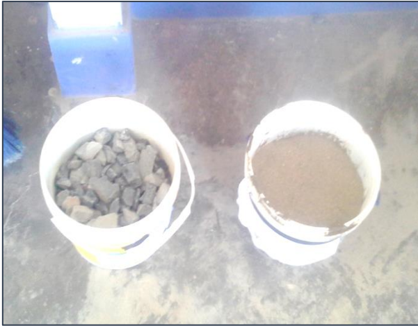
Figura N° 18: Ensayo de Gravedad Especifica y Absorción de Arena Gruesa y Piedra Chancada
