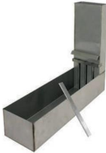
Figura 5. Prueba de la caja L, ensayo que mide la capacidad de paso que tiene el concreto autocompactante.
