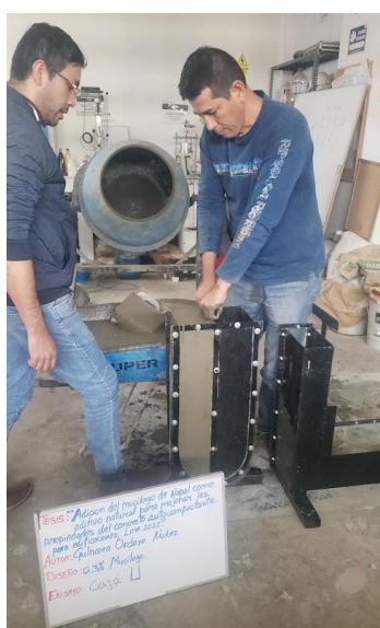
Figura 45. Ensayo de la caja U
