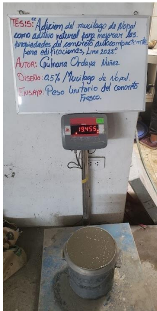
Foto 7: Pesado de mezcla para peso unitario
