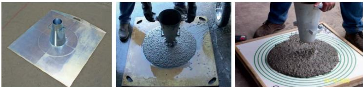
Figura 4. "Slump flow" Ensayo donde se mide el diámetro del concreto que se expande producto del vaciado de concreto en el Cono de Abrams invertido, variando entre 455 y 810 mm (entre 18 y 32 pulgadas).
