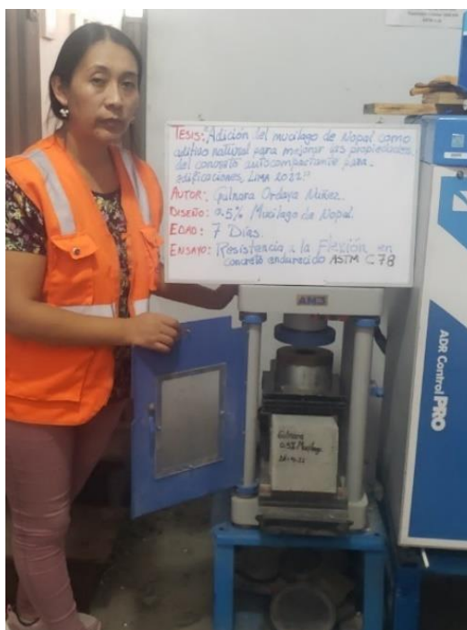
Figura 32. Ensayo de flexión
