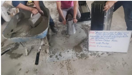
Figura 21. Ensayo de Cono de Abrams
