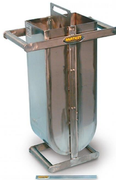
Figura 6. Prueba de la caja U, ensayo que mide la capacidad de fluidez con la altura de llenado del concreto autocompactante.
