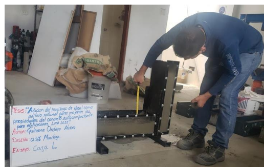
Figura 43. Determinación de la capacidad de paso
