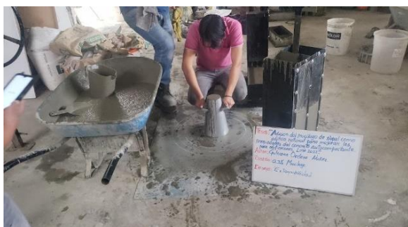
Figura 36. Ensayo de Cono de Revenimiento - cono de Abrams
