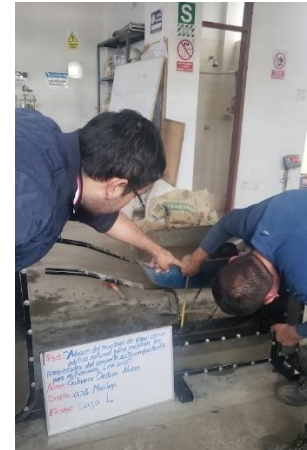
Figura 27. Medición de paso del concreto
