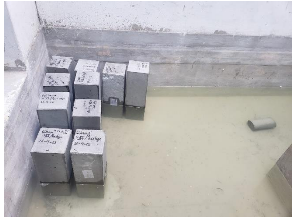
Figura 19. Curado de Vigas
