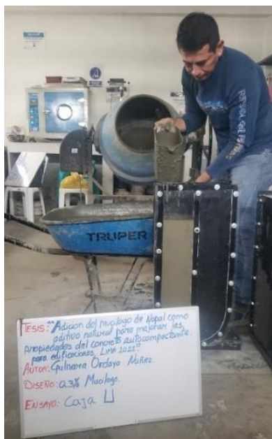
Figura 28. Ensayo caja en U
