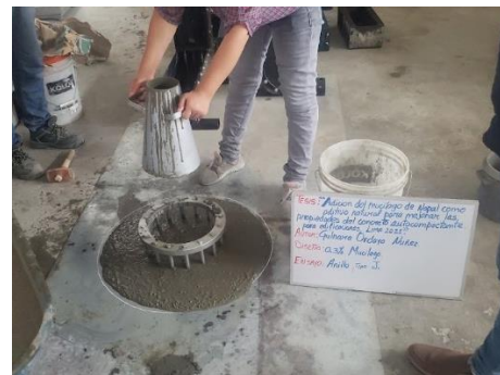
Figura 24. Ensayo de Anillo tipo J
