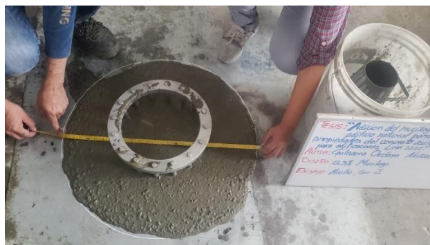
Figura 25. Medición del flujo del concreto
