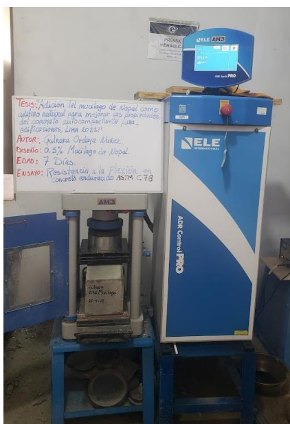
Figura 51. Ensayo de la Resistencia a la Flexión
