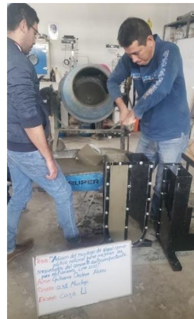
Figura 29. Abertura de paso, caja en U
