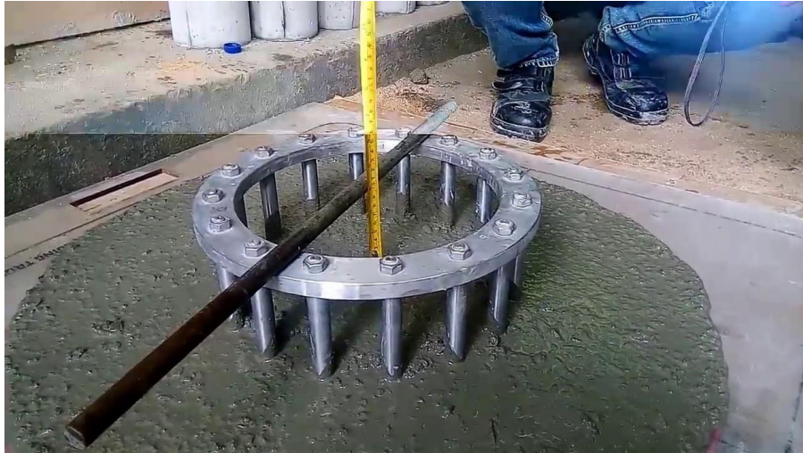
Figura 7. Prueba de anillo tipo J, ensayo que mide la capacidad de fluir a través de varillas de refuerzo y otros sistemas de resistencia al bloqueo del concreto autocompactante.
