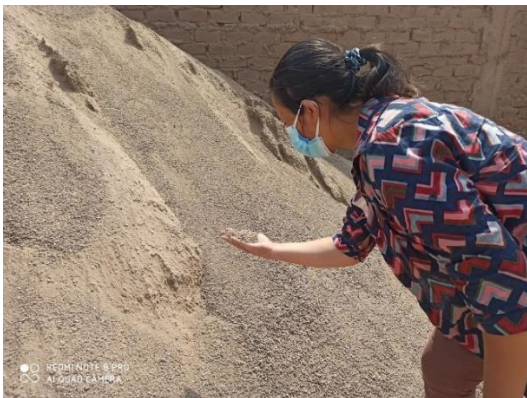
Foto 3: Revisión de material arena gruesa
