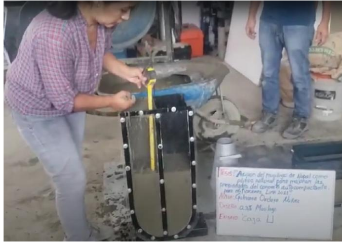
Figura 30. Medición de paso del concreto
