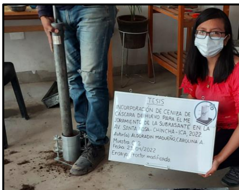
Foto 29: Golpes en el ensayo de Proctor modificado.
