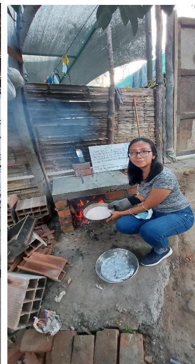
Figura 9. Calcinación de polvo de cáscara de huevo
