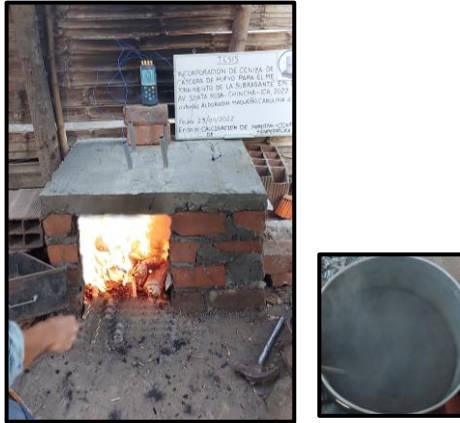
Foto 19: Obtención de la ceniza de cáscara de huevo.
