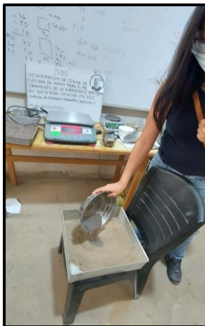
Foto 39: Incorporación de la ceniza de cáscara de huevo-dosificación 3%.
