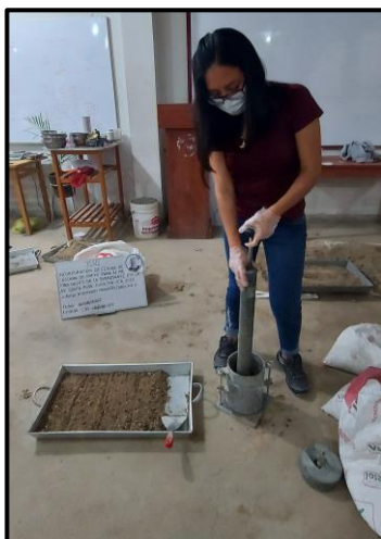
Foto 53: Ensayo de CBR con adición de 12% de CCH.
