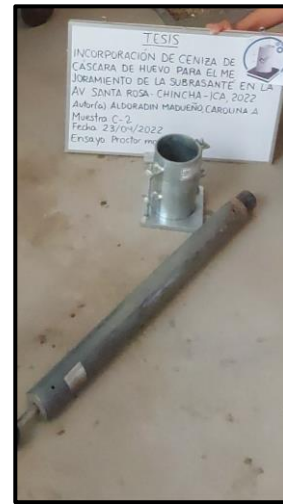
Foto 28: Ensayo de Proctor modificado-método A.
