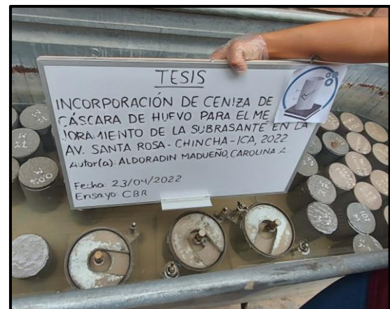
Foto 36: CBR del suelo patrón en estado sumergido.
