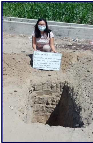
Foto 09: Paredes de la calicata 03
