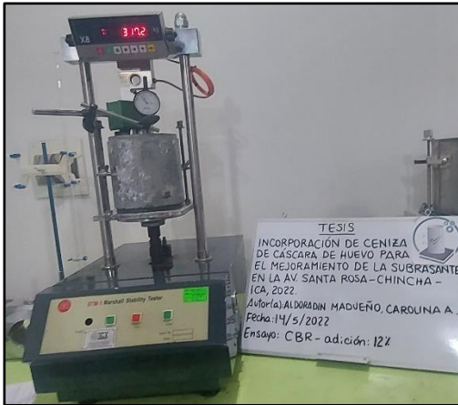
Foto 55: Se somete a la muestra con adición del 12% de CCH a la máquina semiautomática digital.
