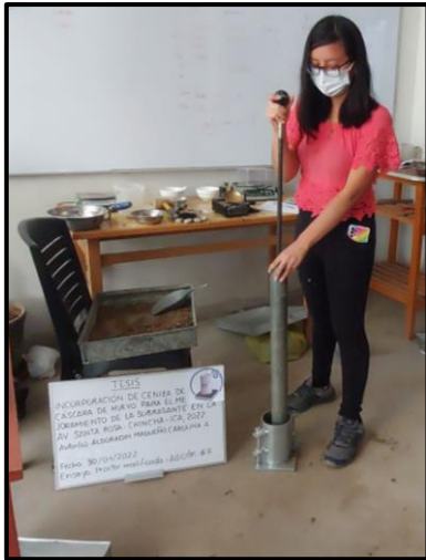
Foto 49: Ensayo de Proctor modificado+ adición de 6% de CCH.
