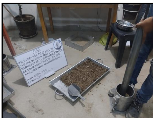
Foto 45: Incorporación de CCH al ensayo de CBR.
