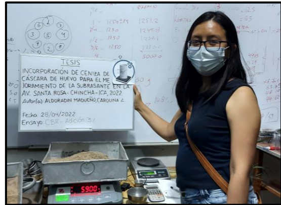
Foto 44: Ensayo de CBR con adición del 3% de CCH.
