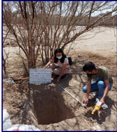
Foto 07: Medidas de la calicata 02
