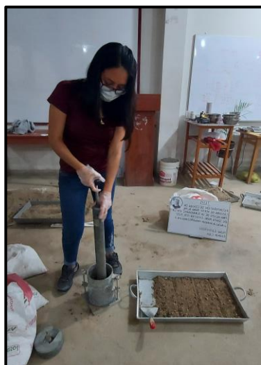
Foto 35: Compactación de cada capa.
