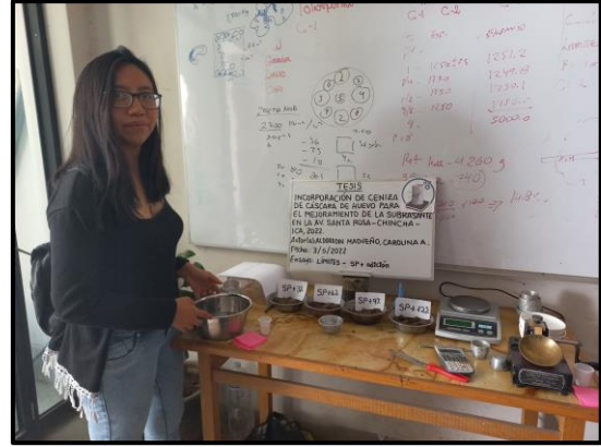
Foto 26: Muestra +CCH en dosificaciones de 3%, 6%, 9% y 12%.
