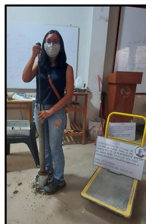
Foto 42: Compactación con él martillo.
