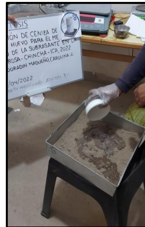
Foto 40: Incorporación del agua al suelo patrón +3% de CCH.
