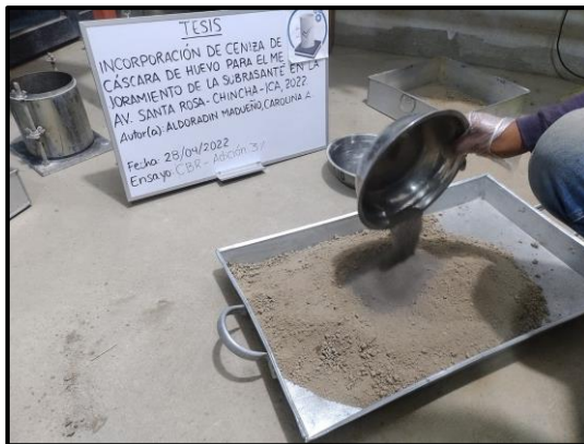
Foto 45: Incorporación de CCH al ensayo de CBR.
