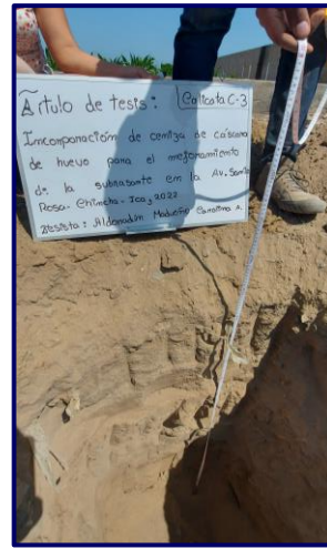
Foto 10: Profundidad de la calicata 03
