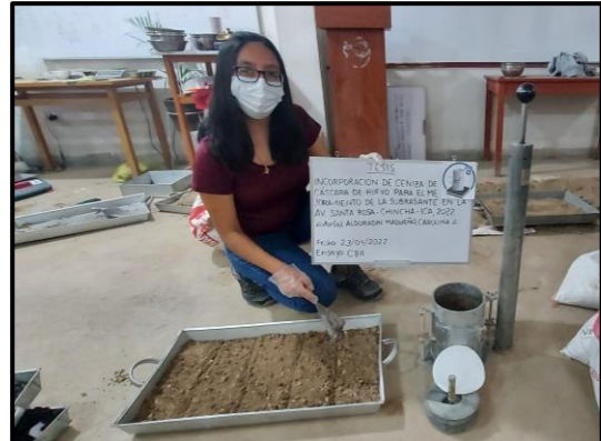
Foto 34: Muestra dividida en 5 capas iguales.
