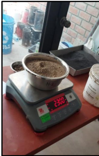
Foto 27: Peso de suelo patrón, para el ensayo de Proctor modificado.
