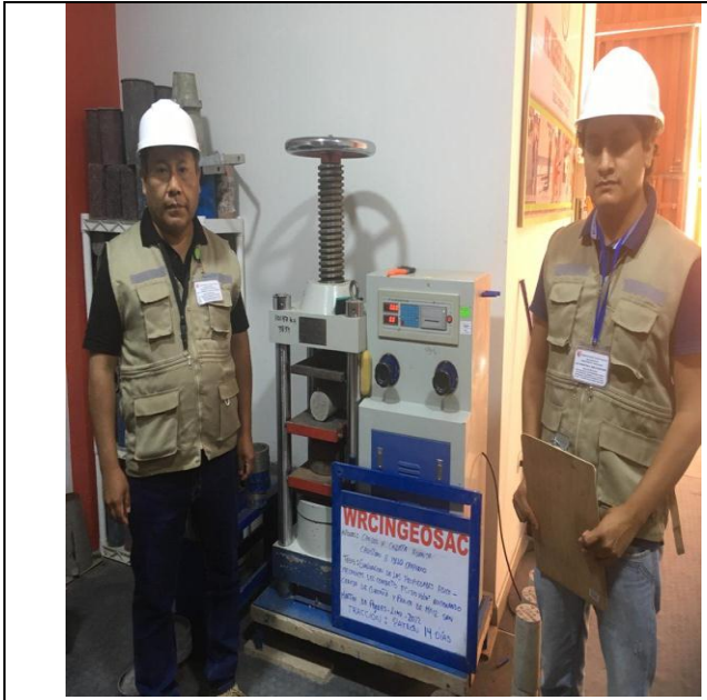
Foto 03: Ensayo de compresión de las probetas de muestra patrón y las muestras adicionando la ceniza de coronta y panca de maíz
