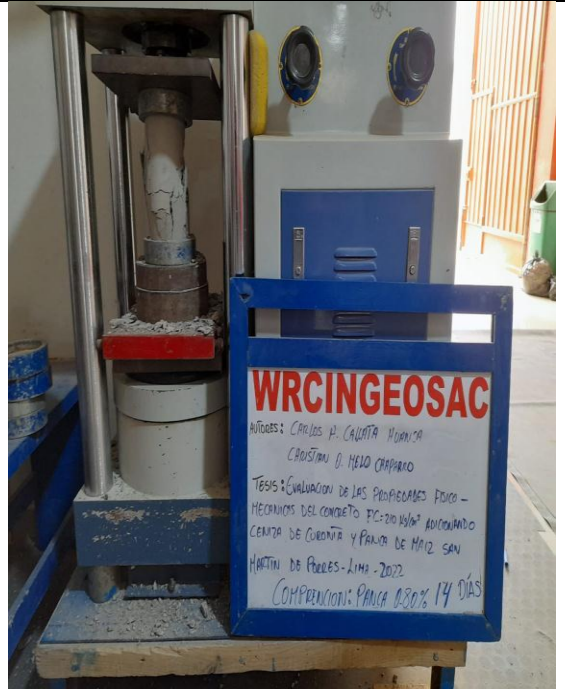
Foto 02: Rotura de las probetas de muestra patrón y las muestras adicionando la ceniza de coronta y panca de maíz
