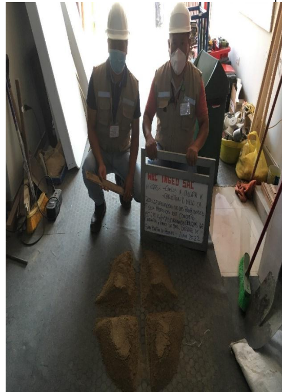
Foto 02: Cuarteo del agregado fino para ser ensayado.
