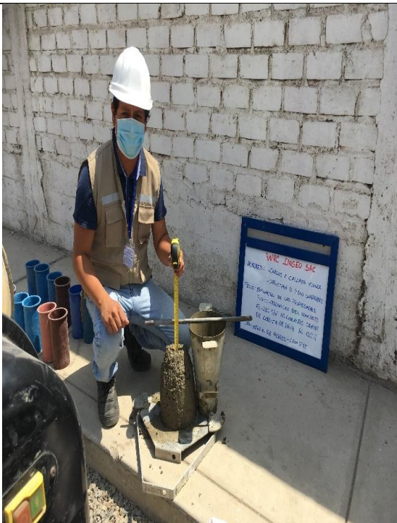
Foto 03: Ensayo de asentamiento del concreto.
