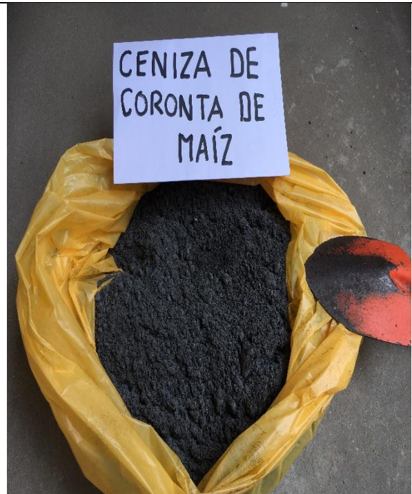
Foto 06: Calcinado artesanal de los productos coronta y panca de maíz.
