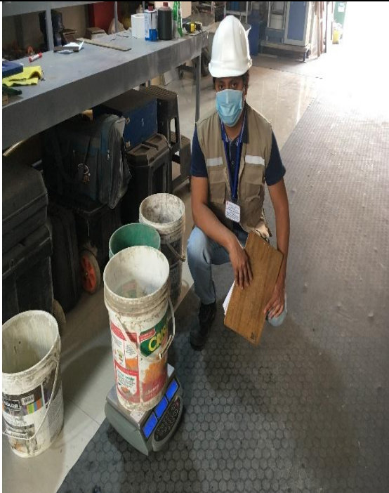
Foto 01: Preparación del concreto según la dosificación del diseño de mezcla.
