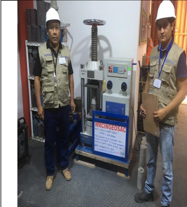
Foto 01: Ensayo de compresión de las probetas de muestra patrón y las muestras adicionando la ceniza de coronta y panca de maíz.
