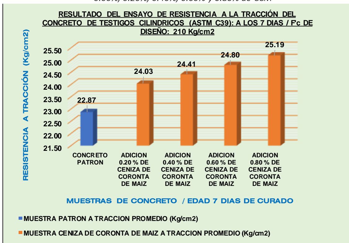
Figura 45. Gráfico de resistencia del C° a la tracción a los 7 días con adición: 0.00%, 0.20%, 0.40%, 0.60% y 0.80% de CCM
