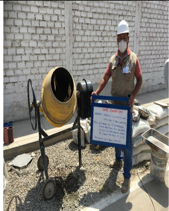
Foto 02: Mezclado de los agregados para elaboración de las muestras patrón y las muestras adicionando la ceniza de coronta y panca de maíz.
