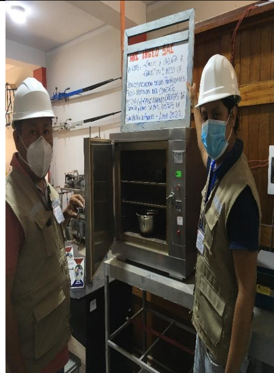
Foto 04: Secado de los agregados, para ensayos de gravedad específica, absorción, humedad, etc.
