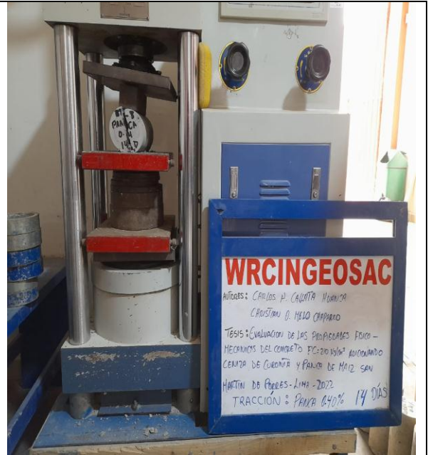
Foto 04: Rotura de las probetas de muestra patrón y las muestras adicionando la ceniza de coronta y panca de maíz.
