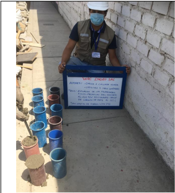
Foto 05: Vaciado de las muestras de concreto en probetas cilíndricas y prismáticas.
