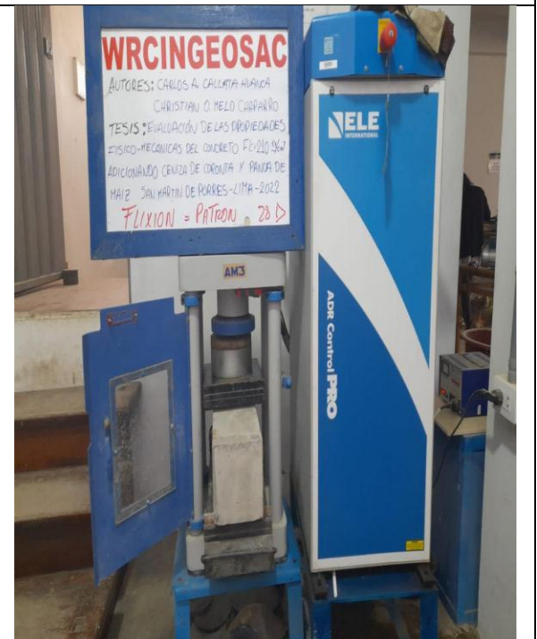
Foto 06: Rotura de las probetas de muestra patrón y las muestras adicionando la ceniza de coronta y panca de maíz.
