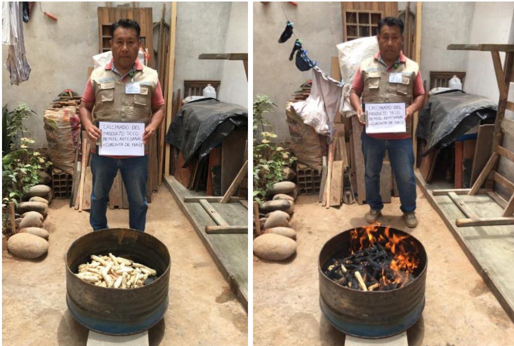
Figura 18. Calcinación artesanal de la coronta de maíz
