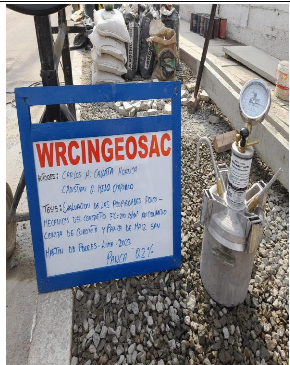
Foto 04: Ensayo del contenido de aire del concreto.
