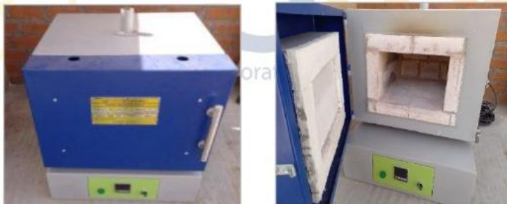
Imagen N°1: Mufia usada en la Calcinación controlada
