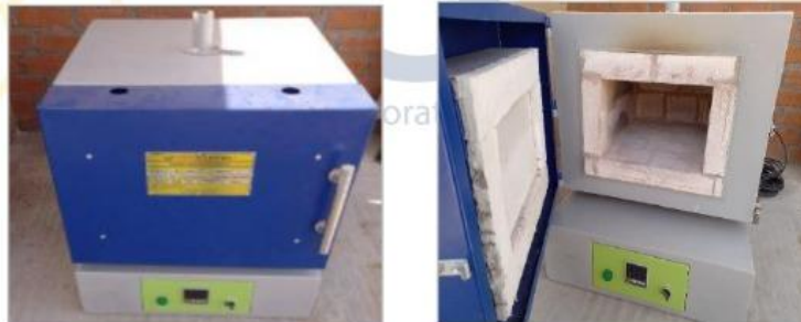
Imagen N°1: Mufla usada en la Calcinación controlada
