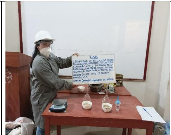
**Figura 3:** Gravedad específica de sólidos
