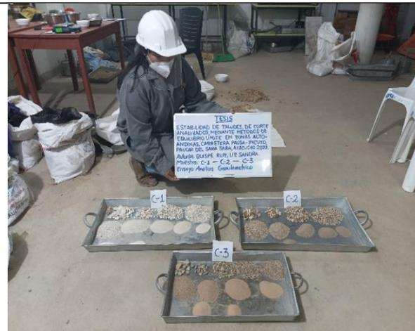
**Figura 2:** Análisis Granulométrico
