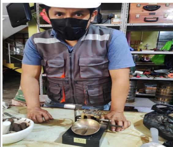
Fotografía 05: Ensayo limite liquido
