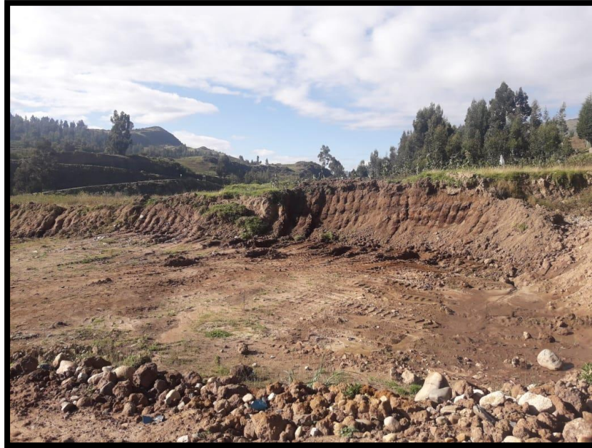
FIG.08 SE OBSERVA EN LA IMAGEN DONDE SE EXTRAHE EL MATERIAL O LA TIERRA PARA LOS LADRILLOS
