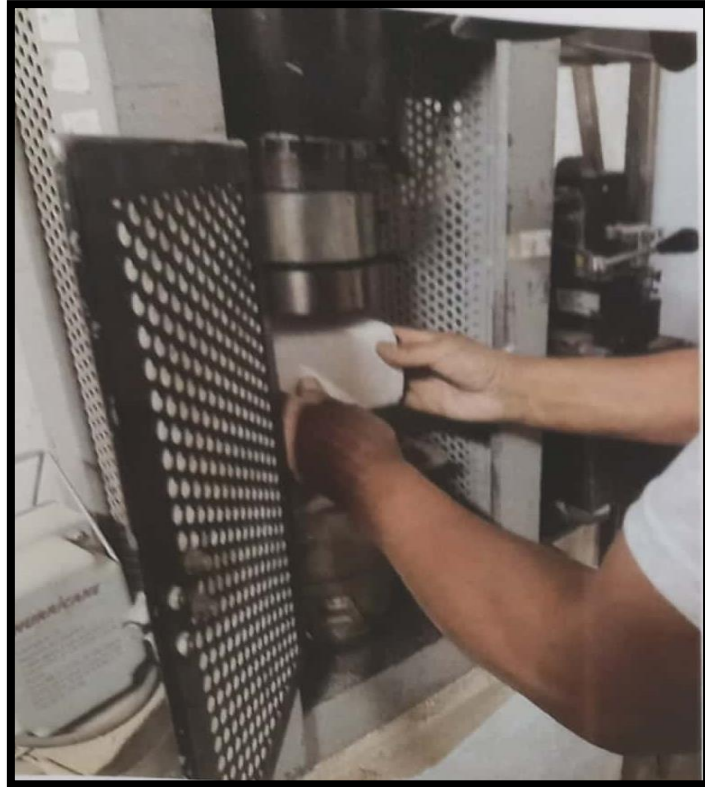
FIG.18 SE OBSERVA EN LA IMAGEN EL LADRILLO QUE SE ENCUENTRA LISTO PARA LA RUPTURA
