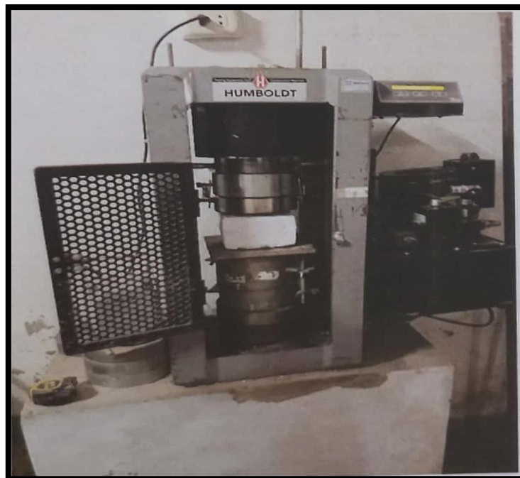
FIG.19 SE OBSERVA EN LA IMAGEN EL LADRILLO QUE SE ENCUENTRA LISTO PARA LA COMPRESIÓN
