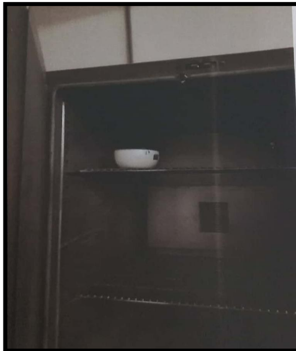
FIG.15 SE OBSERVA EN LA IMAGEN EL SECADO DE LA TIERRA EN EL HORNO
