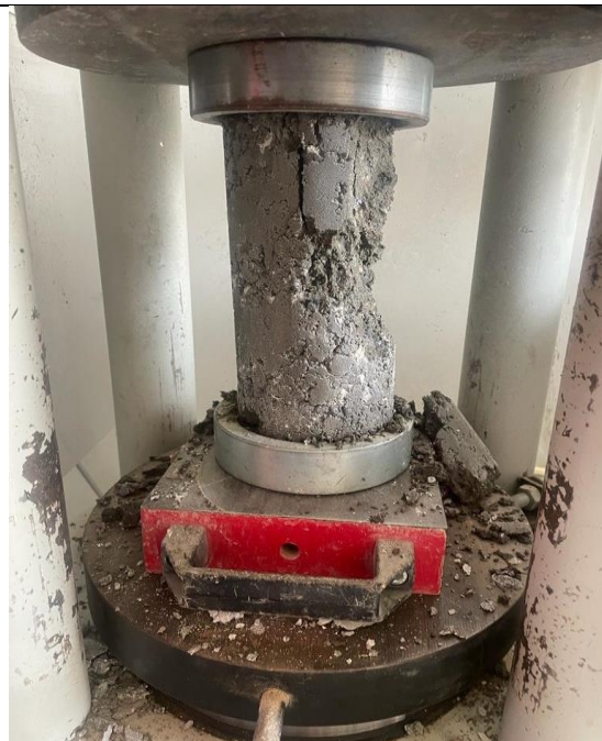
Ensayo resistencia a la compresion con platos de retencion y albuadillas de neopreno
