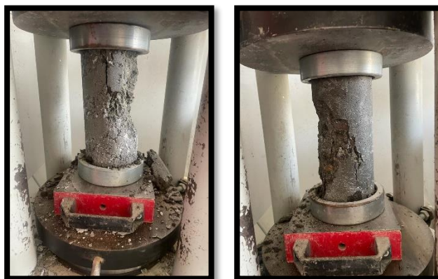
Figura 22. Ensayo de rotura de probetas
