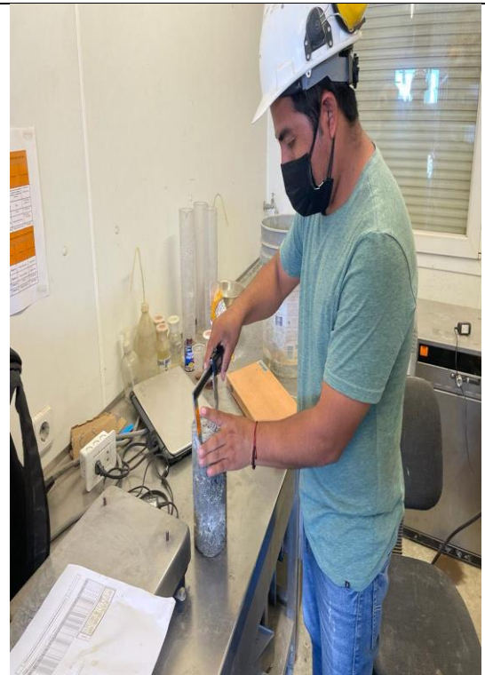
Toma de medias diametro y altura con pie de rey
