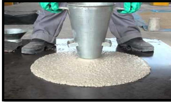
Figura 4. Ensayo de extensión de flujo.
