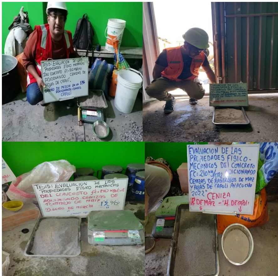
Figura 29. Dosificaciones de las cenizas de rastrojo de maíz y hojas de capulí
