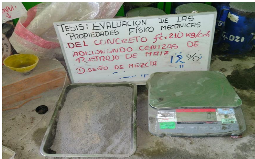
Diseño de mezcla añadiendo cenizas de rastrojo de maíz y hojas de capulí al 10 %.
