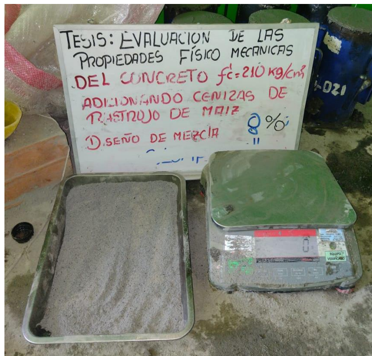
Diseño de mezcla añadiendo cenizas de rastrojo de maíz y hojas de capulí al 8 %.
