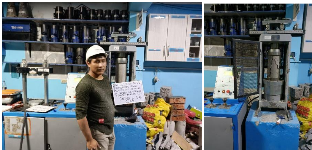
Figura 60. Ensayos de resistencia a compresión adicionando CRM a los 14 días.
