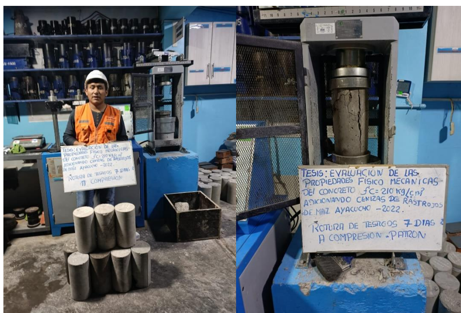
Figura 56. Ensayos de resistencia a la compresión de CRM a los 7 días.
