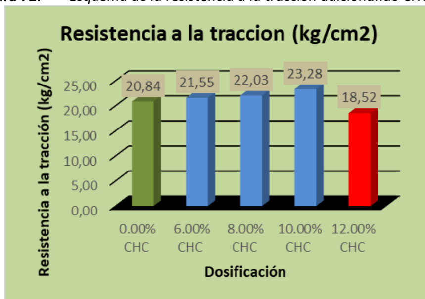
Figura 72. Esquema de la resistencia a la tracción adicionando CHC a los 7 días.
