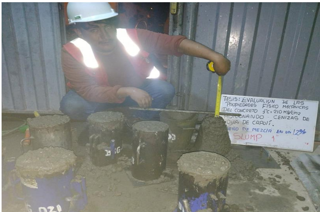
Preparación de briquetas cilíndricas.
