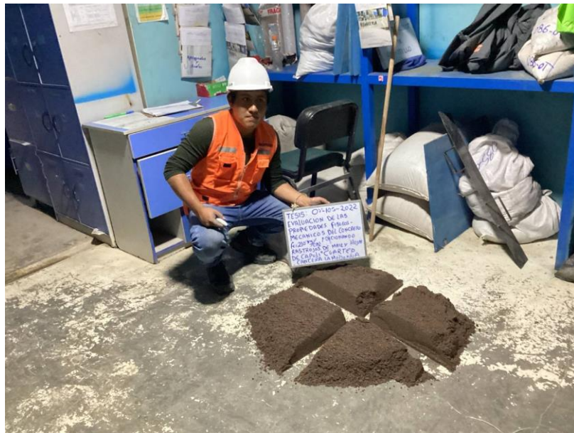
Cuarteo de agregado
