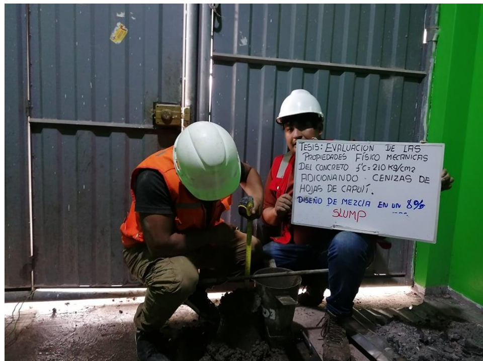
Ensayo de slump.
