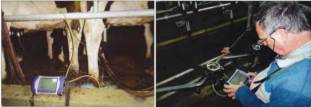
Figura 21. Chequeo dinámico (izquierda) y estático (derecha) de equipo de ordeño GRANGETTO (2012, p. 1)
