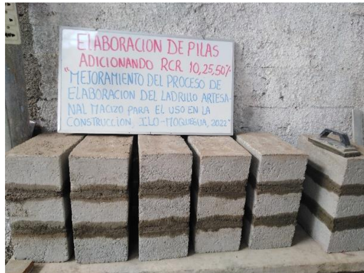
Figura 26. Elaboración de pilas adicionando 10%,25,50% concreto reciclado.
