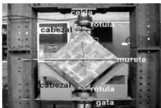
Figura 2. Ensayo a compresión diagonal en muretes.
