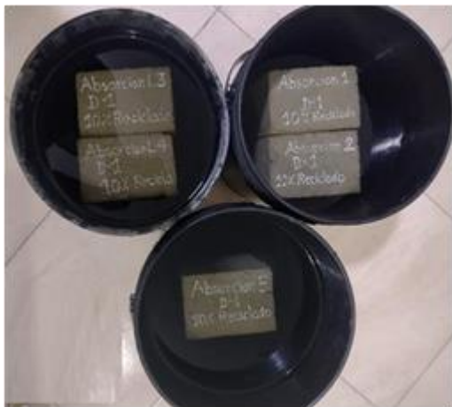
Figura 53. Ensayo de absorción a unidades de albañilería maciza
