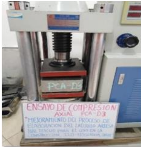
Figura 42. Ensayo a compresión axial de unidad de albañilería
