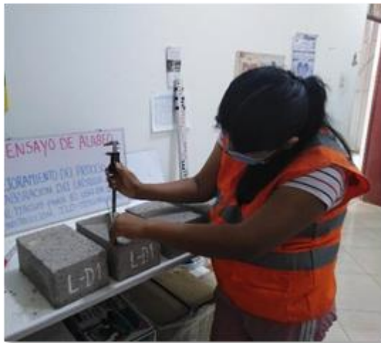
Figura 56. Ensayo de alabeo en unidades de albañilería maciza
