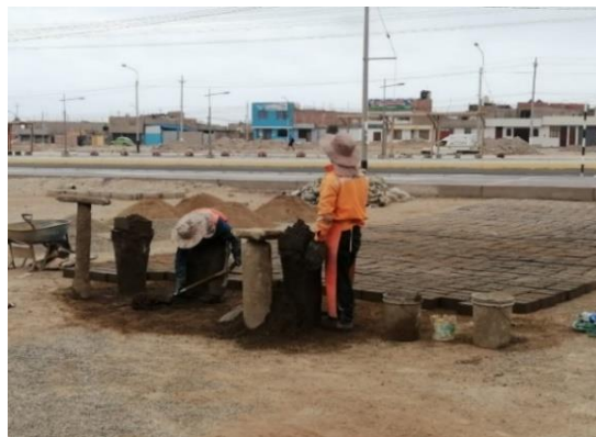
Figura 9. Elaboración de ladrillo de manera empírica en ladrillera laqui
