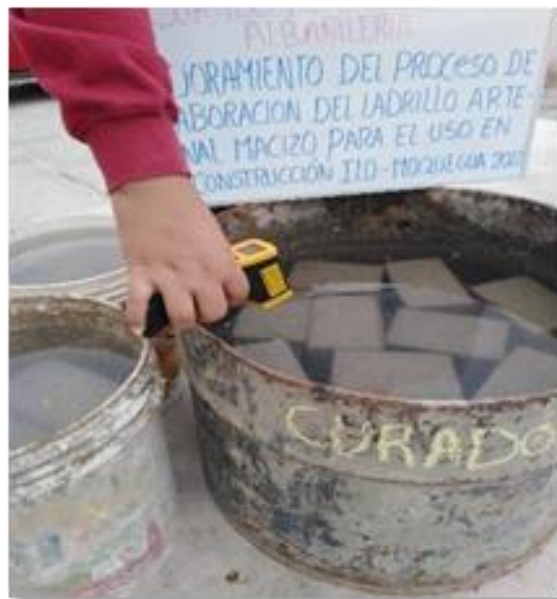
Figura 40. Medición de la temperatura
