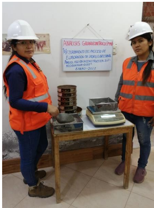
Figura 16. Ensayo de análisis granulométrico
