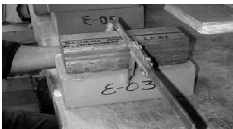
Figura 4. Ensayo de variabilidad dimensional.
