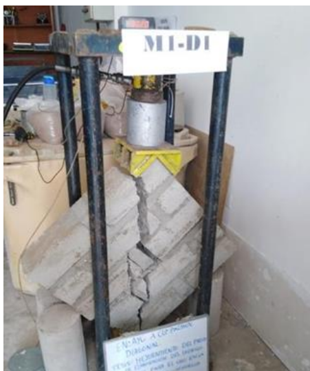
Figura 33. Ensayo de compresión diagonal a muretes
