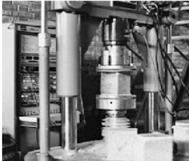
Figura 3. Ensayo de resistencia a la compresión en unidades de albañilería
