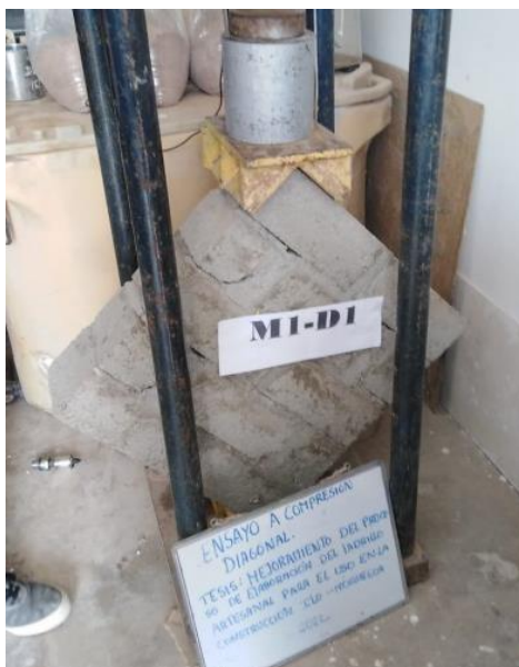
Figura 32. Ensayo a compresión diagonal en muretes
