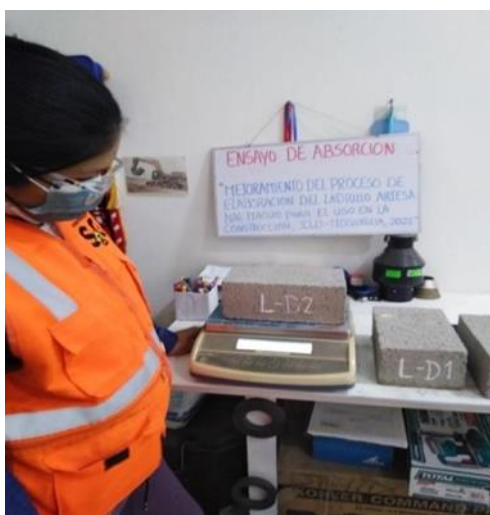
Figura 54. Peso seco de las unidades de albañilería de concreto para ensayo de absorción
