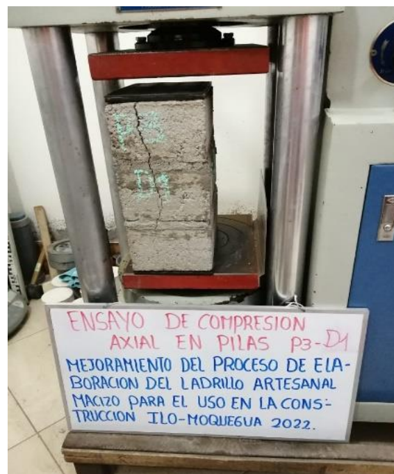
Figura 1. Ensayo a compresión en pilas de albañilería.
