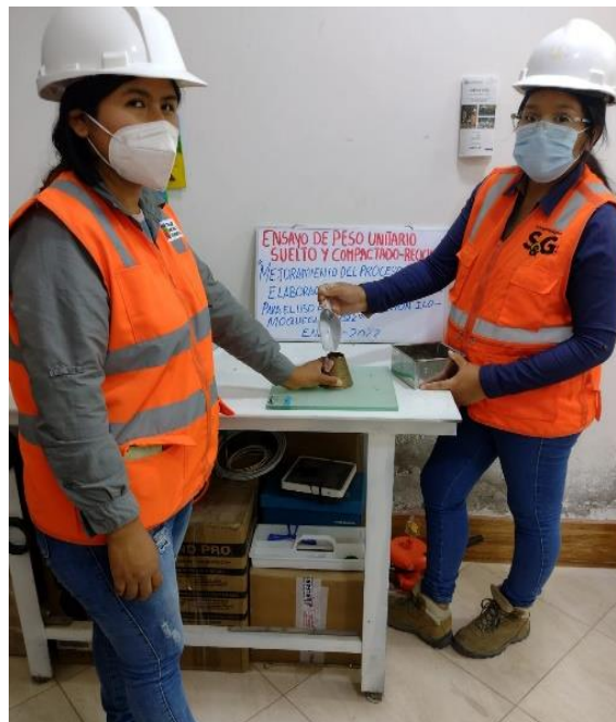
Figura 19. Ensayo de peso unitario suelto y compactado.
