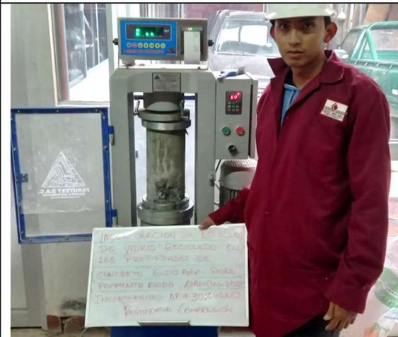
Foto 23. Maquina de ensayo a compresión.
