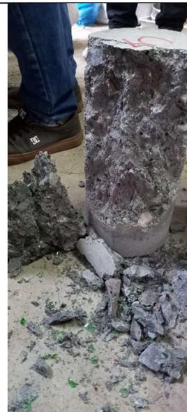
Foto 24. Rotura de concreto a compresión
