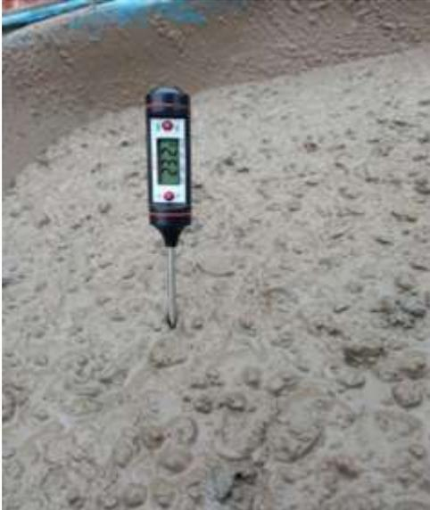
Figura 16. Temperatura del concreto patrón.
