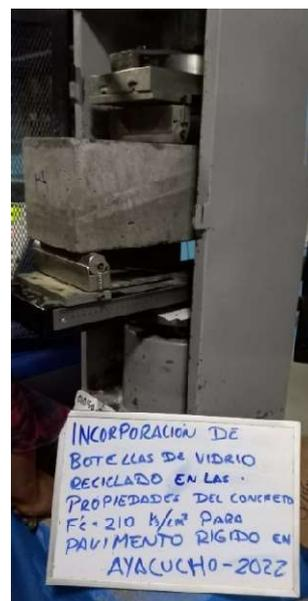
Figura 29. Ensayo a flexión de concreto.
