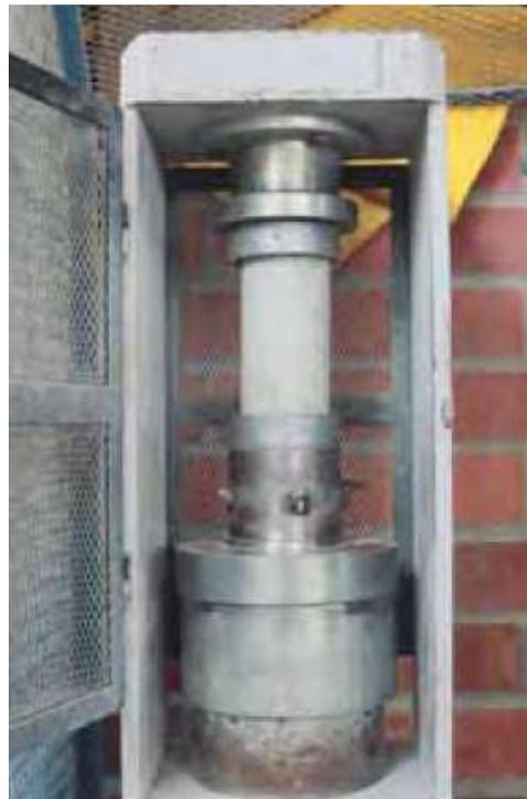
*Figura 5.* Medida de la resistencia a la compresión
