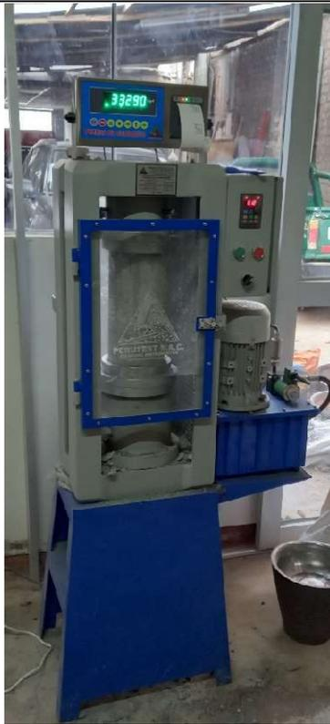
Foto 25. Resistencia a compresión
