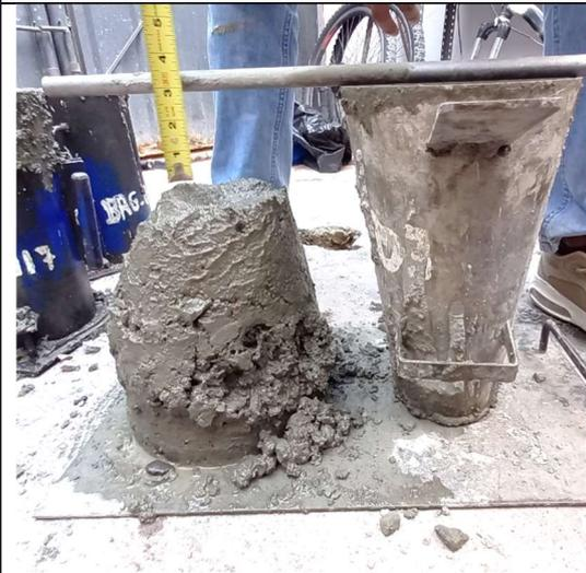
Foto 15. Consistencia del concreto
