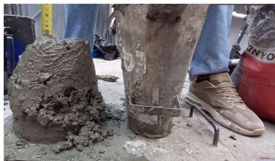
Figura 14. Resultado de asentamiento del concreto fresco.
