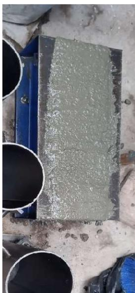
Figura 28. Preparado de viga de concreto para someter a flexión.
