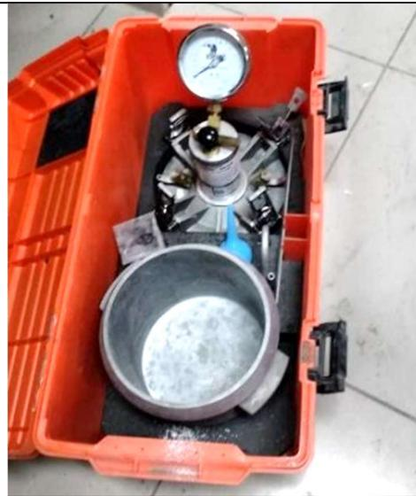
Foto 16. Equipo para realizar ensayo de contenido de aire
