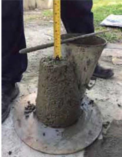
*Figura 1.* Ensayo de consistencia
