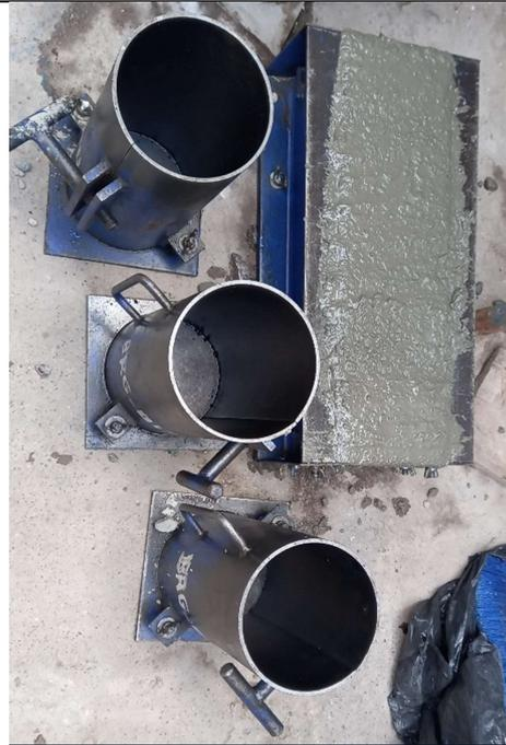
Foto 18. Elaboración de vigas de concreto
