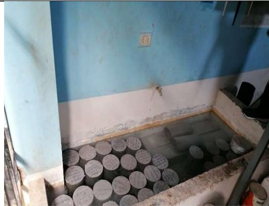
Foto 28. Curado de testigos y vigas de concreto
