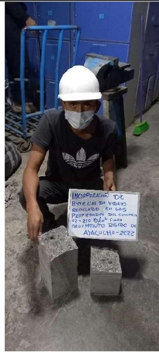
Foto 34. Testigos de concreto con incorporación de vidrio reciclado
