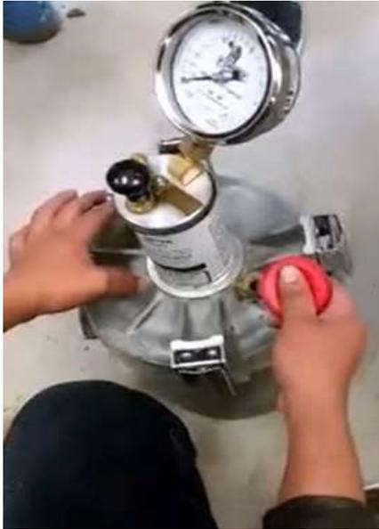
Figura 19. Ensayo contenido de aire.
