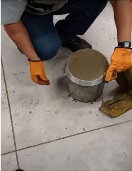
Figura 22. Ensayo contenido de aire del contenido fresco.
