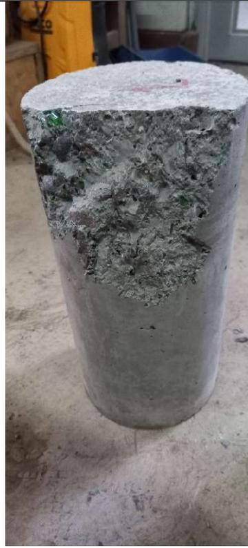
Foto 26. Resistencia a compresión
