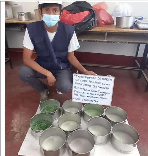
Foto 05. Granulometría del agregado fino con incorporación de vidrio reciclado
