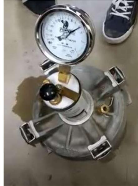
Figura 20. Ensayo contenido de aire
