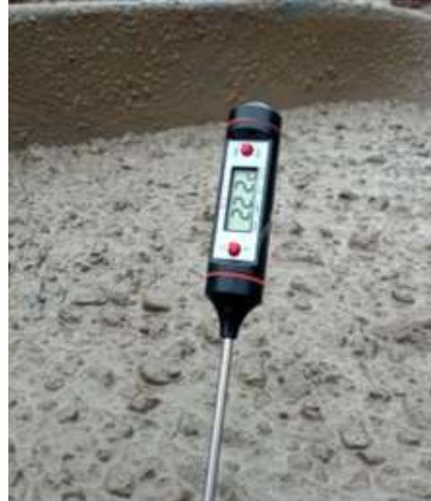
Figura 17. Temperatura del concreto con 45% de vidrio del AF.
