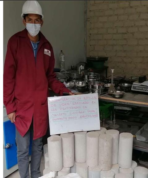
Foto 22. Testigos de concreto con incorporación de vidrio reciclado
