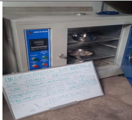
Foto 06. Contenido de humedad de agregado fino y grueso
