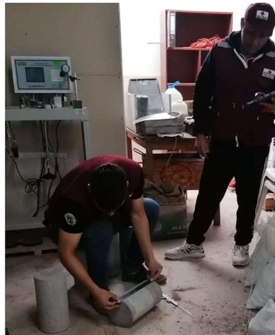
Foto 20. Toma de dimensiones del testigo
