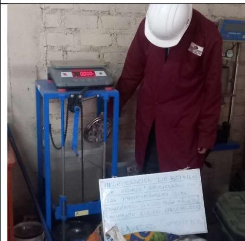
Foto 07. Gravedad específica del agregado grueso
