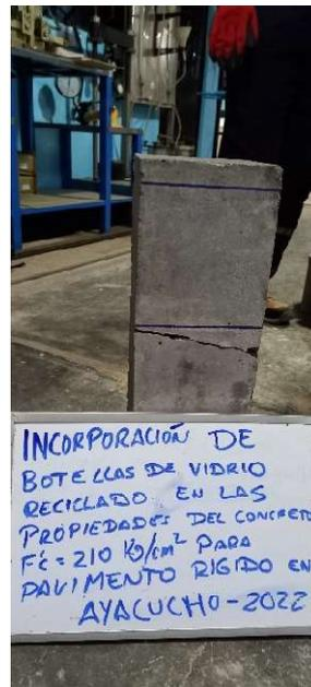
Foto 36. Rotura de concreto
