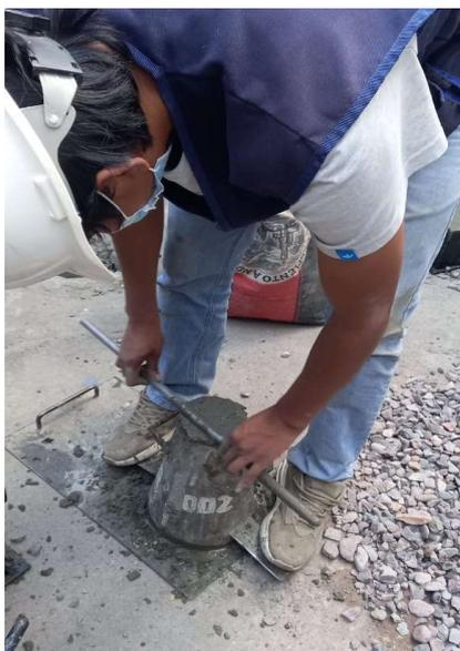
Figura 13. Muestreo de slump.
