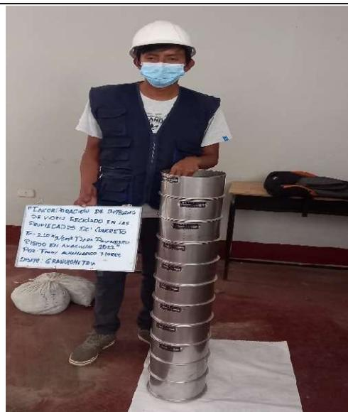
Foto 04. Granulometría del agregado grueso
