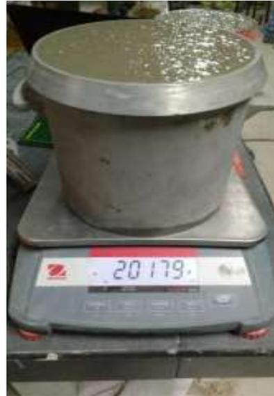
Figura 23. Ensayo contenido de aire del contenido fresco.
