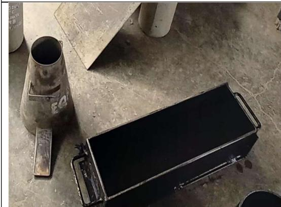
Foto 19. Molde para elaborar viga de concreto
