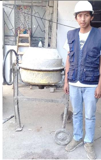
Foto 14. Equipo para la elaboración del concreto
