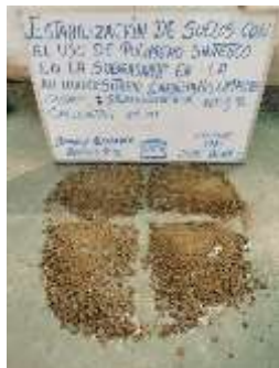
Anexo 32. Se detalla, el cuarteo de la muestra de la calicata 01, ahora añadido con el Polímero Sintético PET al 5%.
