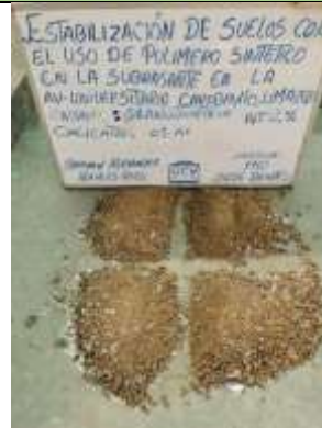
Anexo 31. Se observa, el cuarteo de la muestra de la calicata 01, ya incorporado el Polímero Sintético PET al 2%.
