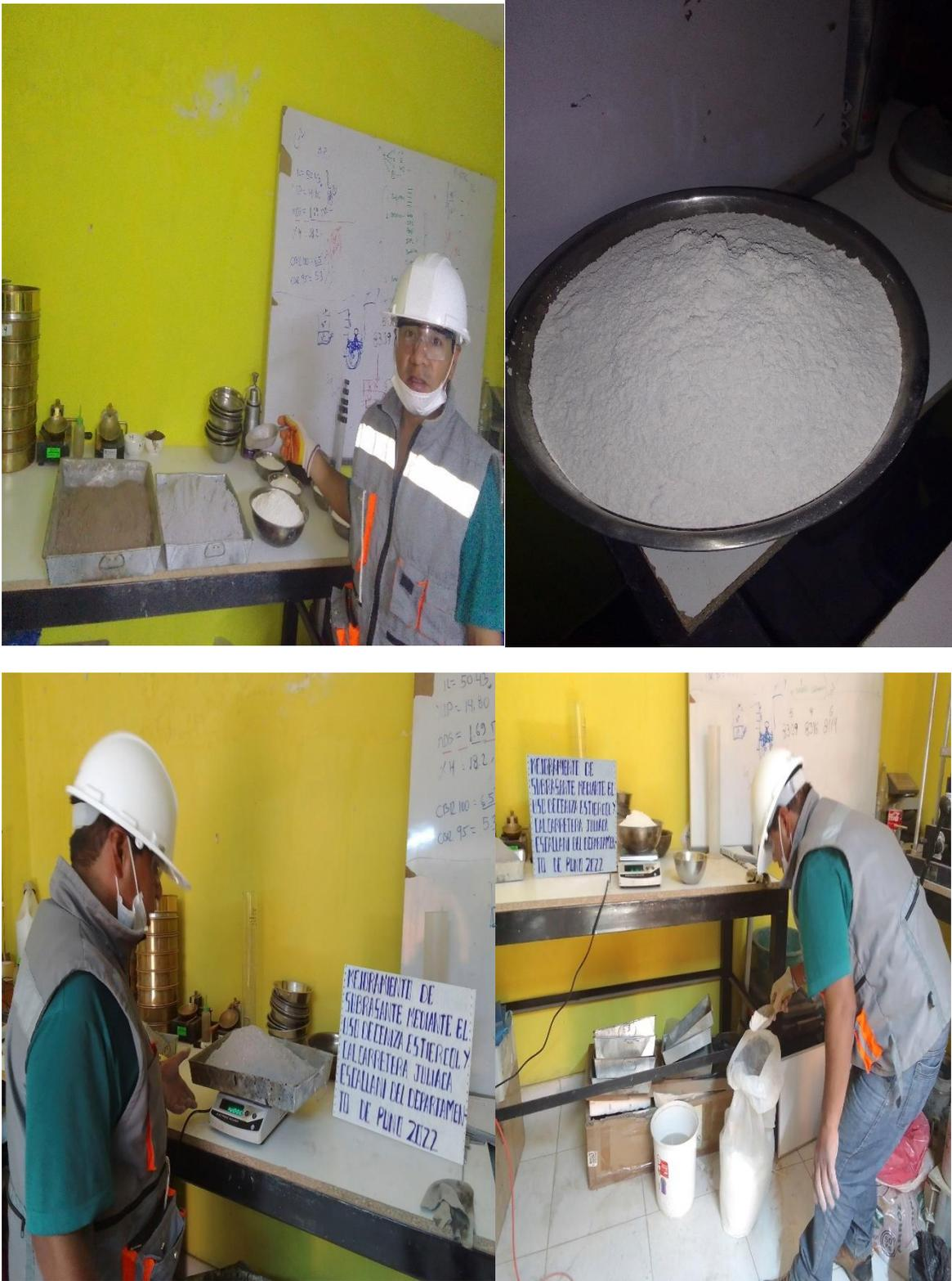
**Figura 15: Proctor modificado Visualización de la toma de datos para el ensayo de C.B.R. Fuente: Elaboración Propia**
