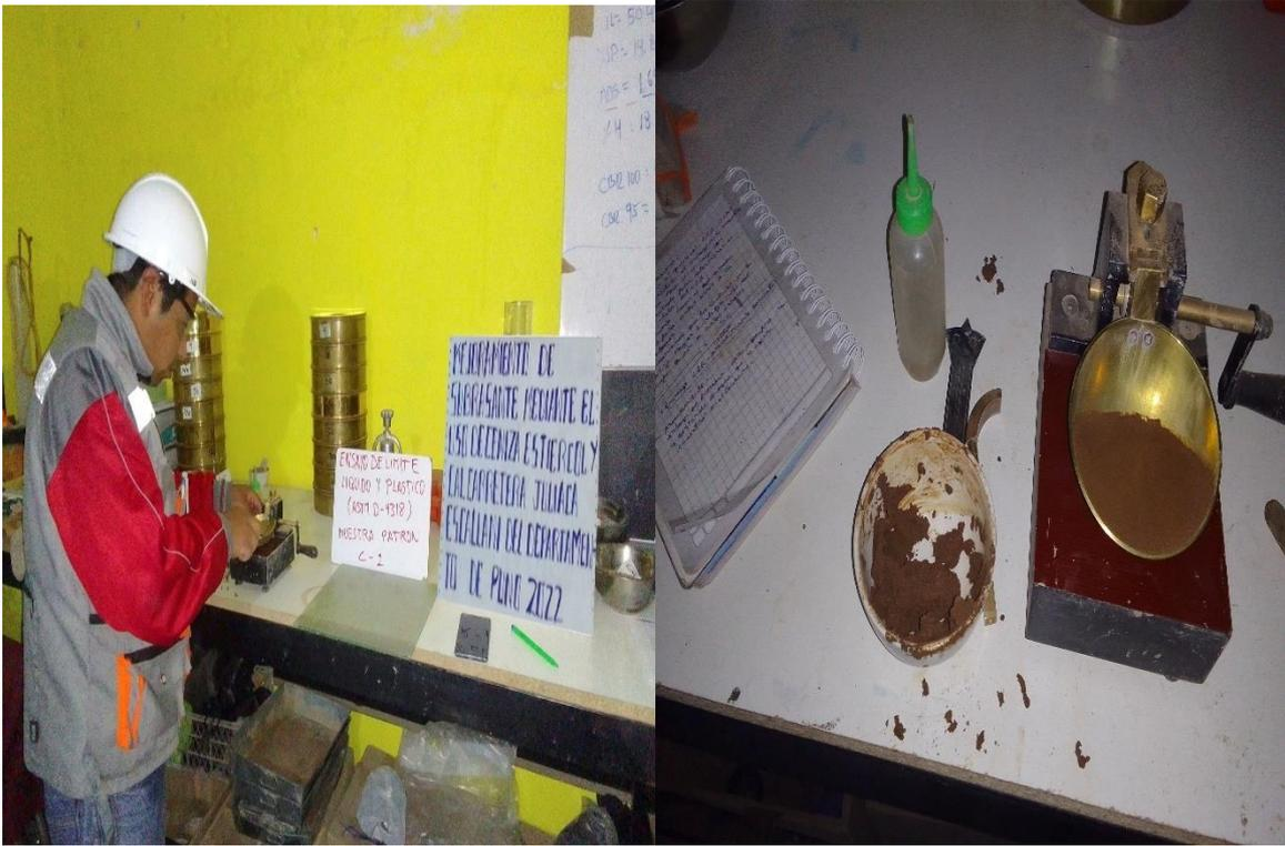
**Figura 14: peso de las muestras para combinación de ceniza estiércol bovino y cal par el ensayo de Proctor modificado**
