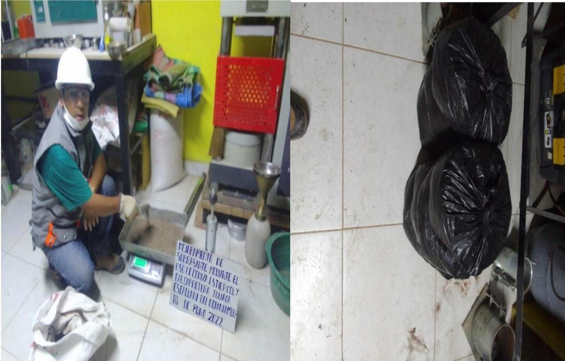
**Figura 14: pesado de las muestras para para el ensayo granulometría y limite liquido limite plástico**
