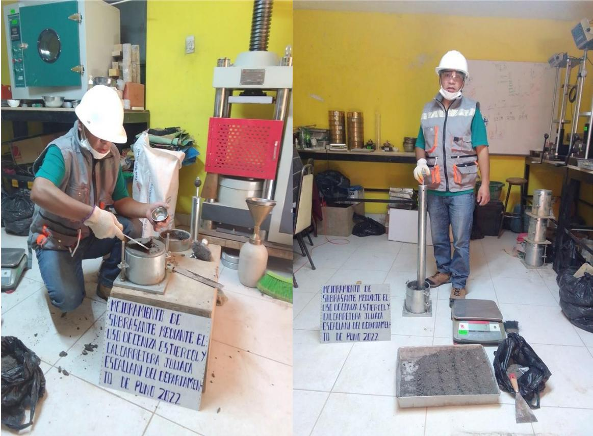
**Figura 18: ensayo de expansión de CBR sumergido a 4 días 96 horas con los materiales para el ensayo**
