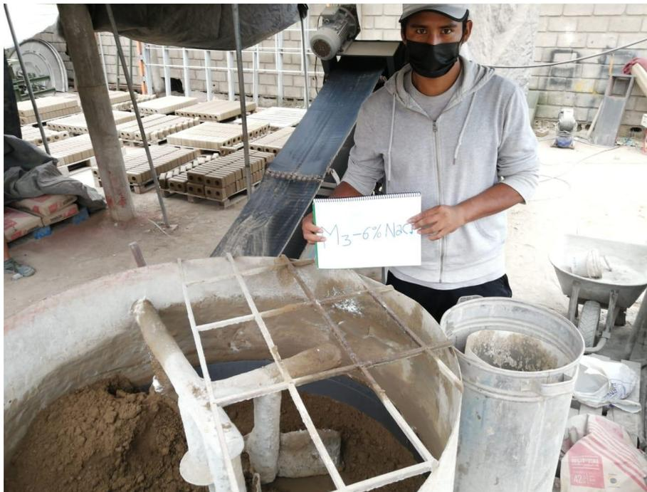
Foto 7. Preparación de la mezcla 3 con 6%NaCl
