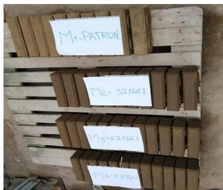
Figura 22. Curado de bloques de tierra comprimida
