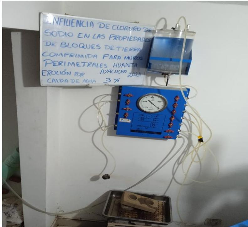
Foto 14. Ensayo de erosión de BTC 3%NaCl
