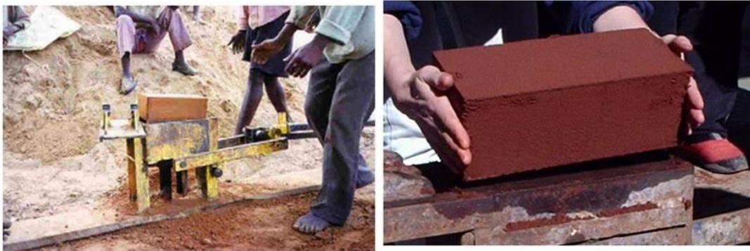
*Figura 6. Bloque de tierra comprimida*
