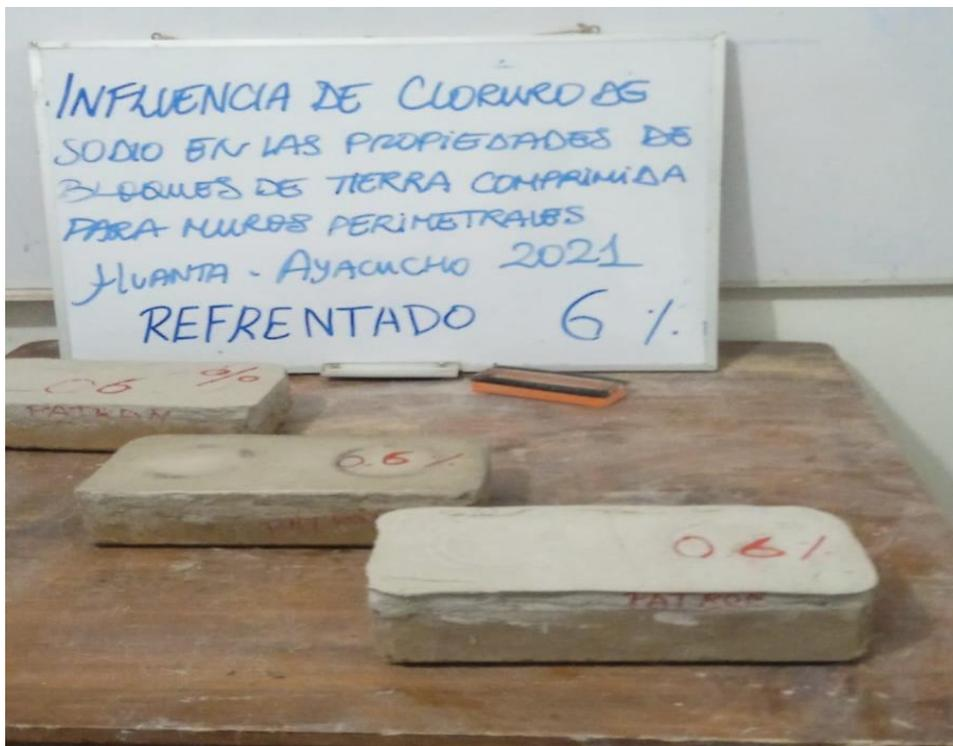
Foto 29. Refrentado de BTC con 6% NaCl
