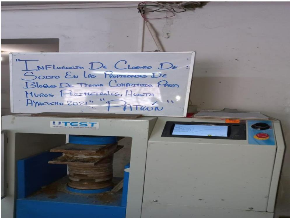
Foto 31. Ensayo de compresión de la Muestra patrón
