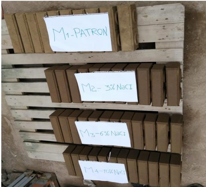
Foto 12. Curado de bloques de tierra comprimida (BTC)
