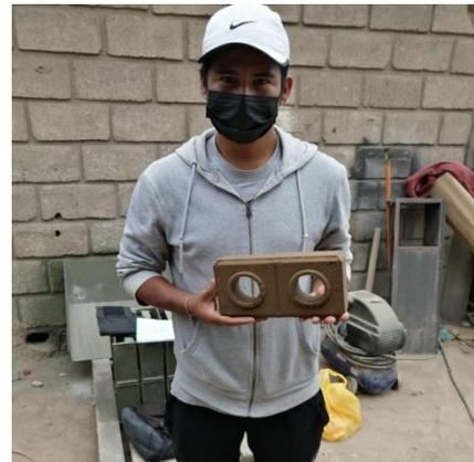
Figura 21. Bloque de tierra comprimida
