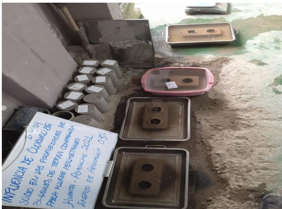
Foto 23. Ensayo de absorción de la muestra 2 con 3%NaCl
