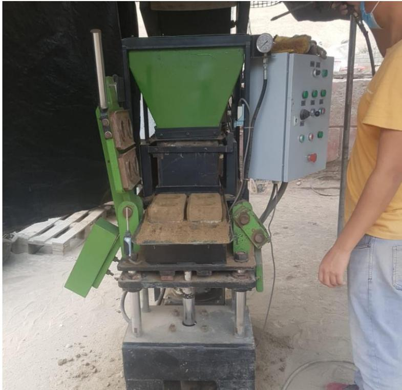
Foto 10. Proceso de fabricación de BTC con hueco
