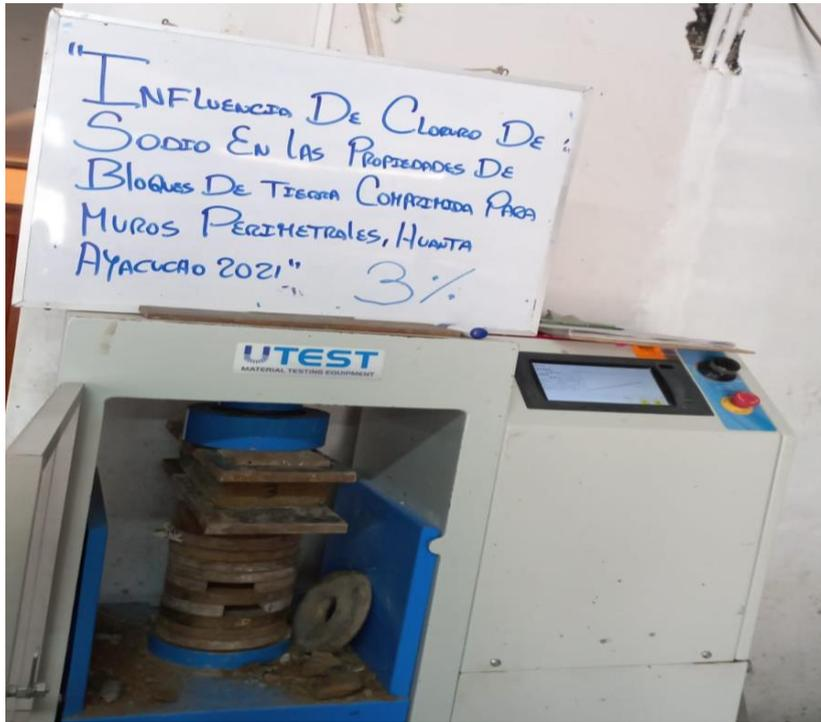
Foto 32. Ensayo de compresión de la Muestra 1 con 3% NaCl
