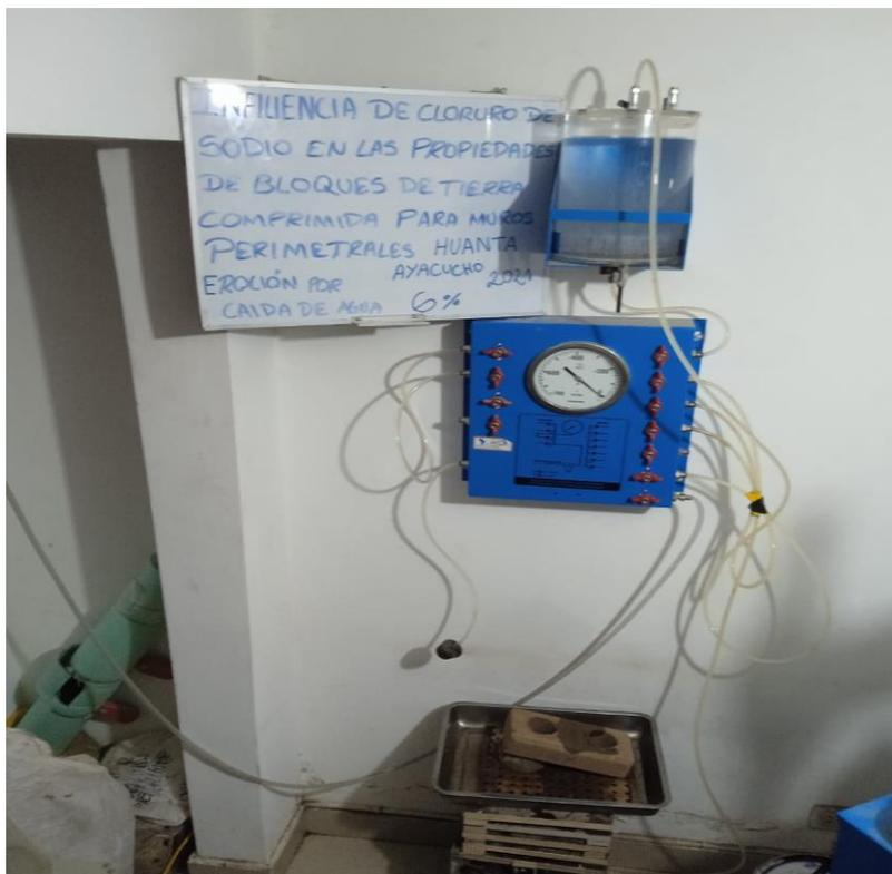
Foto 15. Ensayo de erosión de BTC 6%Na
