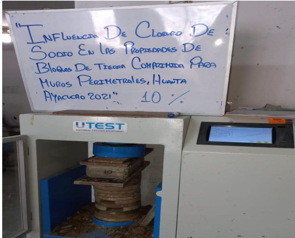
Foto 34. Ensayo de compresión de la Muestra 1 con 10% NaCl
