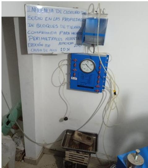
Figura 27. Ensayo de erosión de BTC (Patron,3%,6% y 10%)
