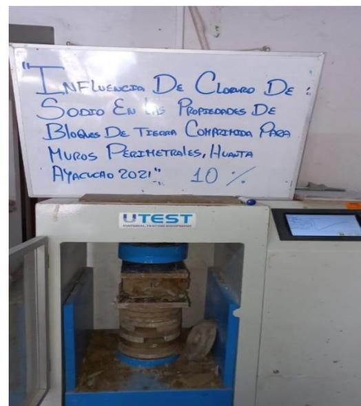
Figura 31. Ensayo de compresión BTC (Patrón,3%,6% y 10%)
