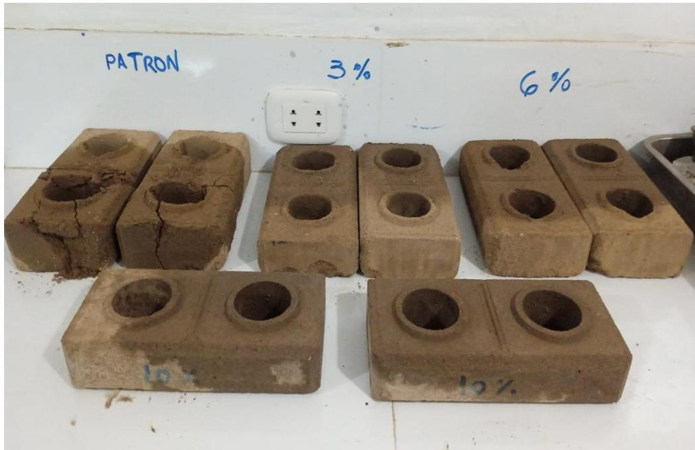
Foto 17. BTC después de someterse al ensayo de erosión
