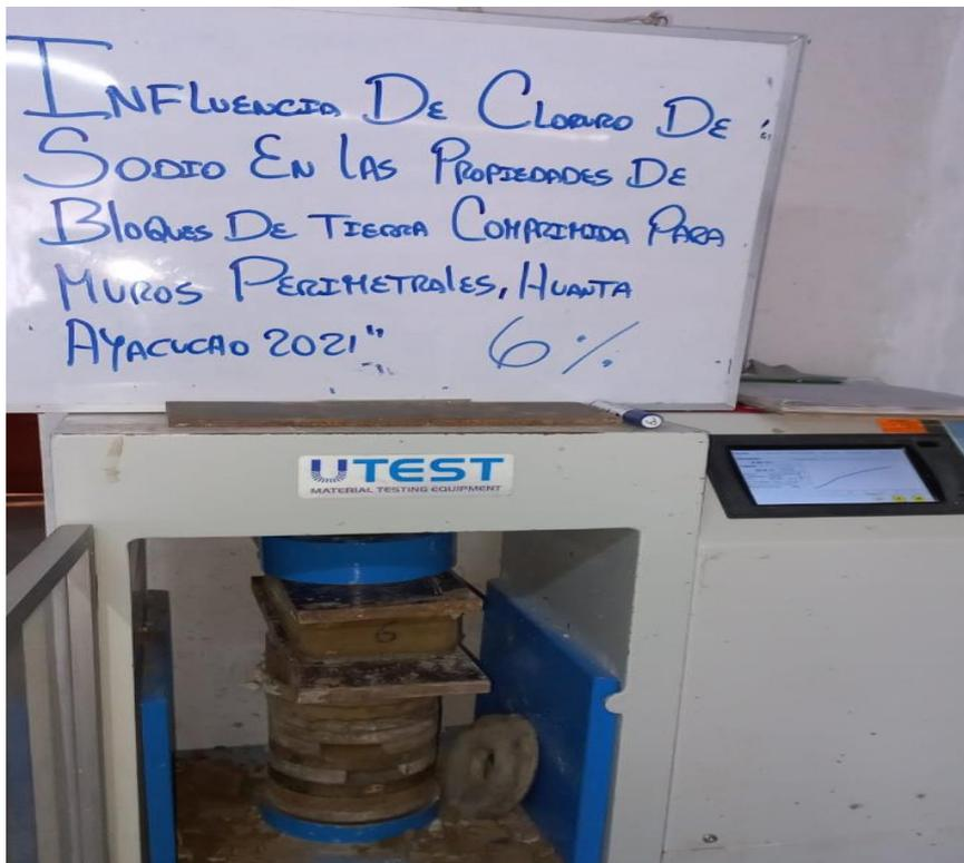
Foto 33. Ensayo de compresión de la Muestra 1 con 6% NaCl
