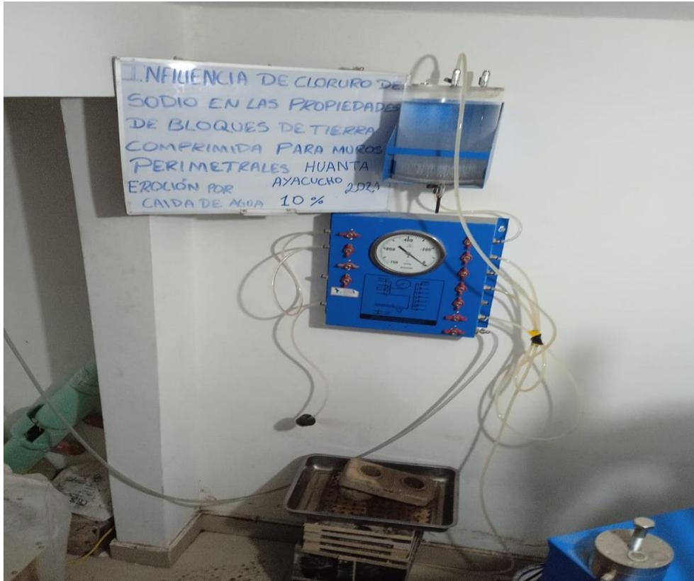
Foto 16. Ensayo de erosión de BTC 10%NaCl
