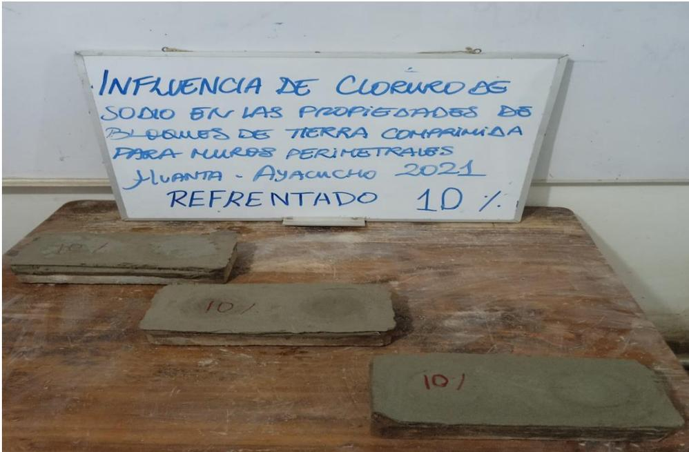
Foto 30. Refrentado de BTC con 10% NaCl
