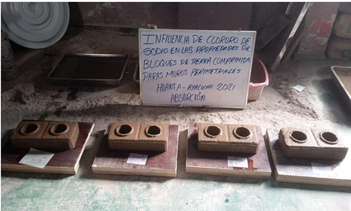
Foto 26. Especímenes después de someterse a la absorción por 24h
