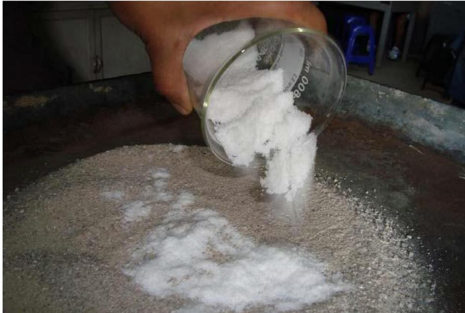
*Figura 5.* Cloruro de sodio como estabilizante de suelos.
