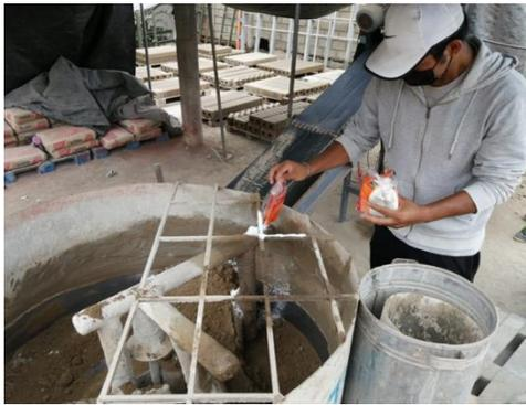
Figura 18. Dosificación del cloruro de sodio
