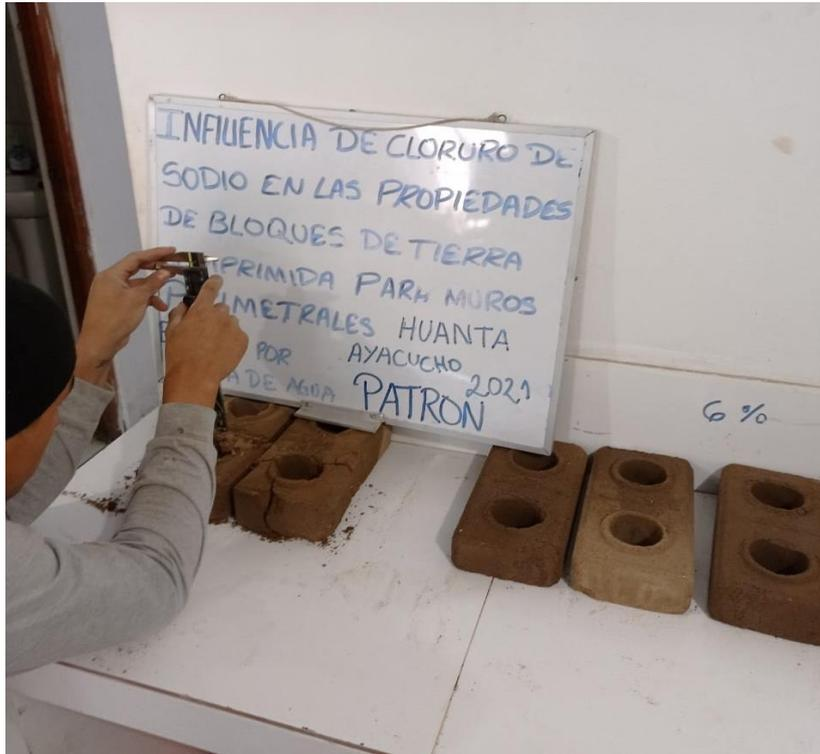
Foto 18. Evaluación de profundidad de erosión de BTC patrón
