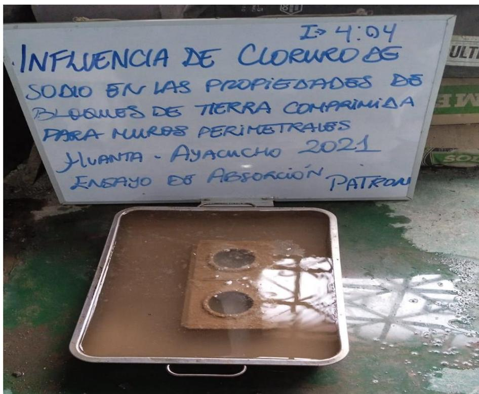
Foto 22. Ensayo de absorción de la muestra patrón
