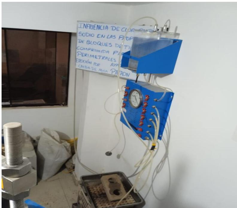
Foto 13. Ensayo de erosión de la muestra patrón
