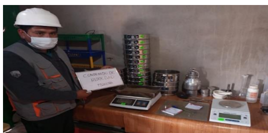
Figura 26. Ensayo de contenido de humedad.
