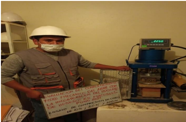
Figura 36. Aplastamiento del 100% de unidad de cubo en adobes
