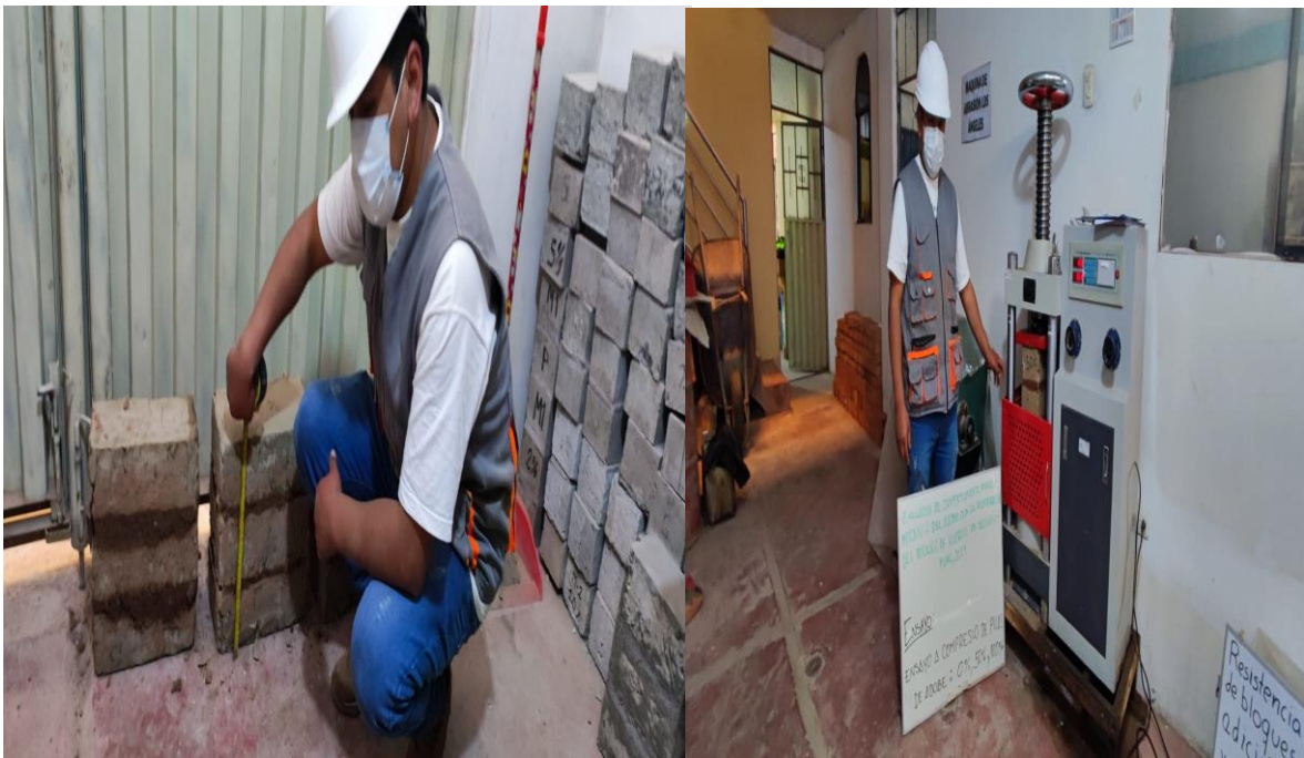
12. Medición y rompimiento de pilas de adobe
