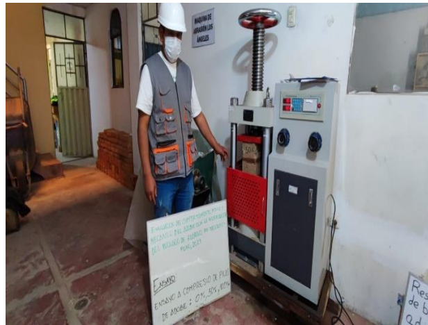
Figura 20. Aplastamiento de pilas de adobe
