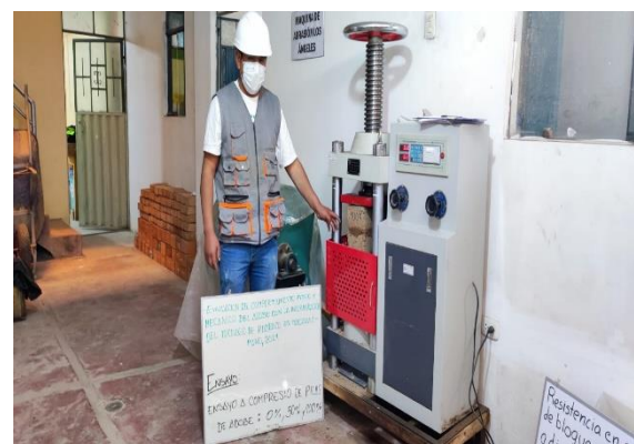
Figura 39. Aplastamiento en pilas de adobe
