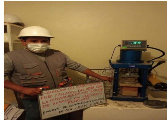
Figura 37. Aplastamiento del 50% de unidad de cubo en adobes
