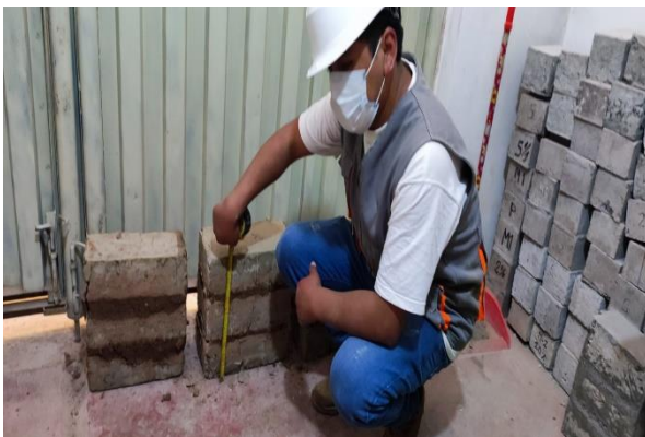
Figura 40. Medición de pilas de adobe con juntas
