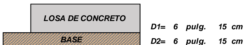
Gráficos y Figuras 6: Espesor propuesto para el paquete estructural del pavimento Rígido.
