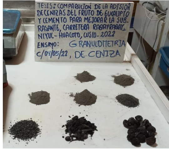
Foto 26. Ensayo de granulometría de la ceniza del fruto de eucalipto.
