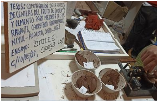
Foto 27. Ensayo de límites de consistencia con 1.5% de ceniza.
