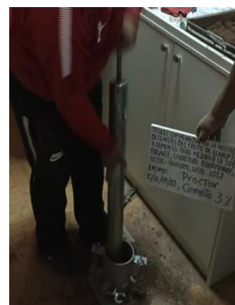
Figura 31. Ensayo de Proctor modificado con adición de cemento al 1.5%, 2% y 3%
