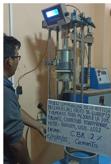
Figura 36. Ensayo de CBR con adición de cemento al 1.5%, 2% y 3%
