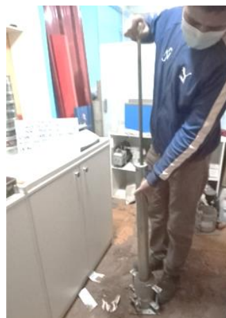
Foto 24. Ensayo de Proctor modificado calicata C-04.
