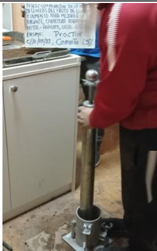
Foto 39. Ensayo de Proctor modificado con 1.5% de cemento.
