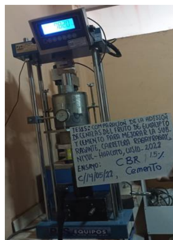
Foto 42. Ensayo de CBR con 1.5% de cemento.
