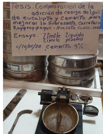
Foto 38. Ensayo de límites de consistencia con 3% de cemento
