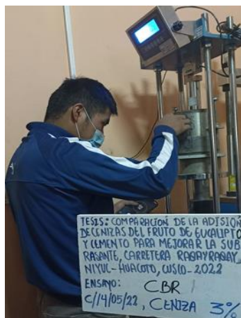
Foto 35. Ensayo de CBR con 3% de ceniza.
