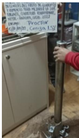
Figura 30. Ensayo de Proctor modificado con adición de CFE al 1.5%, 2% y 3%
