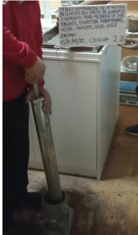
Foto 31. Ensayo de Proctor modificado con 2% de ceniza.
