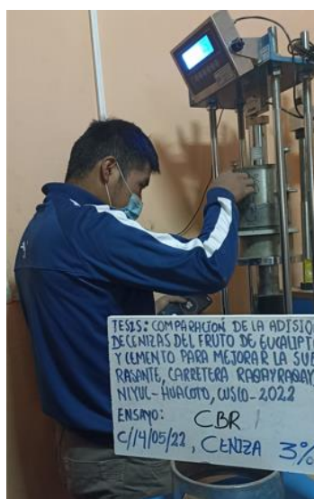
Figura 35. Ensayo de CBR con adición de CFE al 1.5%, 2% y 3%
