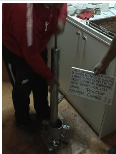
Foto 41. Ensayo de Proctor modificado con 3% de cemento.
