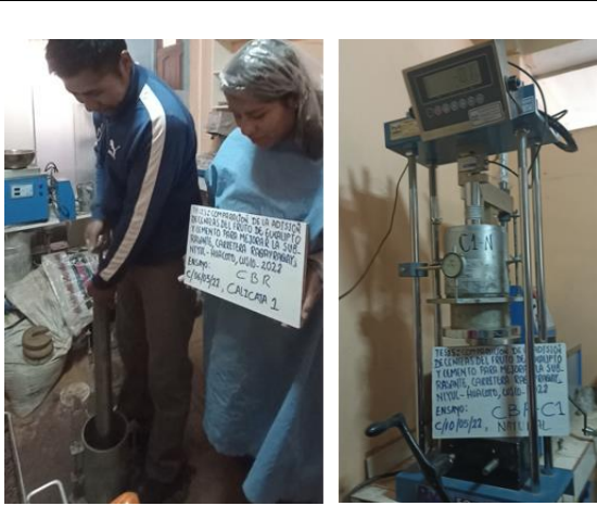
Foto 13. Ensayo de CBR. Calicata C-01.
