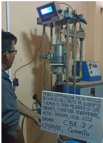
Foto 44. Ensayo de CBR con 2% de cemento.
