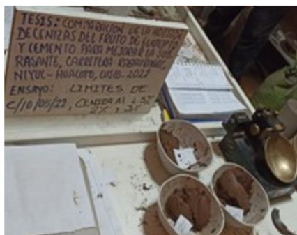
Figura 25. Ensayo de límites de Atterberg con adición de CFE al 1.5%, 2% y 3%
