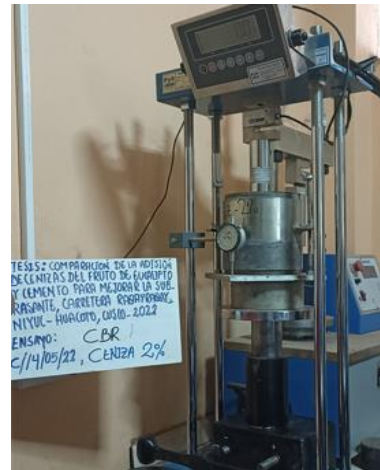
Foto 34.. Ensayo de CBR con 2% de ceniza.
