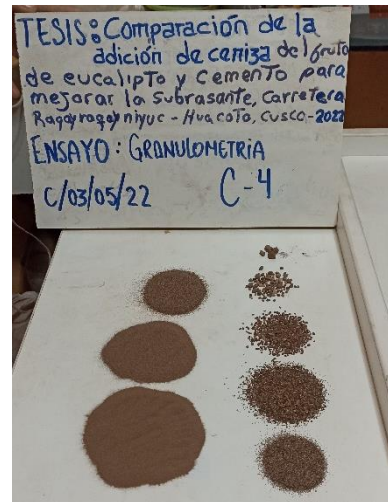
Foto 22. Ensayo de granulometría de la calicata C-04
