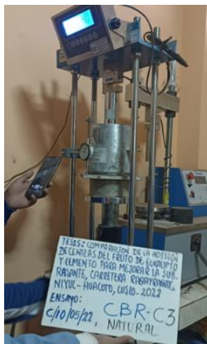
Foto 21. Ensayo de CBR. Calicata C-03.
