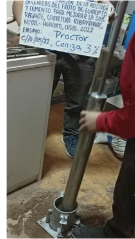
Foto 32. Ensayo de Proctor modificado con 3% de ceniza.
