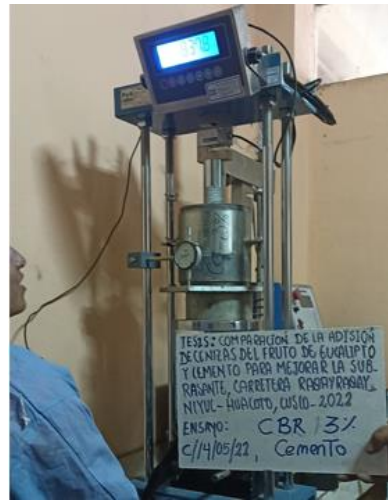
Foto 45. Ensayo de CBR con 3% de cemento.
