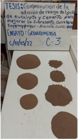
Foto 18. Ensayo de granulometría de la calicata C-03
