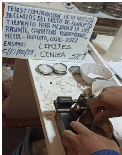
Foto 29. Ensayo de límites de consistencia con 3% de ceniza.
