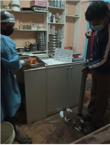
Foto 16. Ensayo de Proctor modificado calicata C-02.
