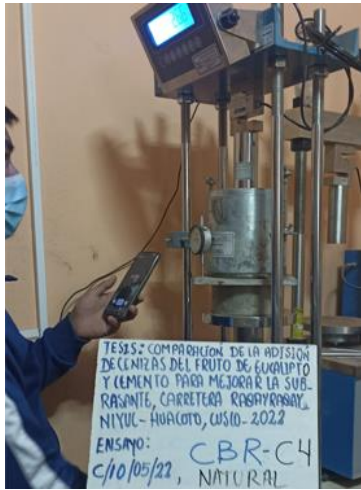
Foto 25. Ensayo de CBR. Calicata C-04.
