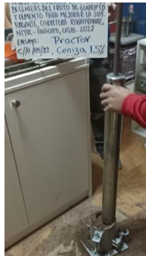
Foto 30. Ensayo de Proctor modificado con 1.5% de ceniza.
