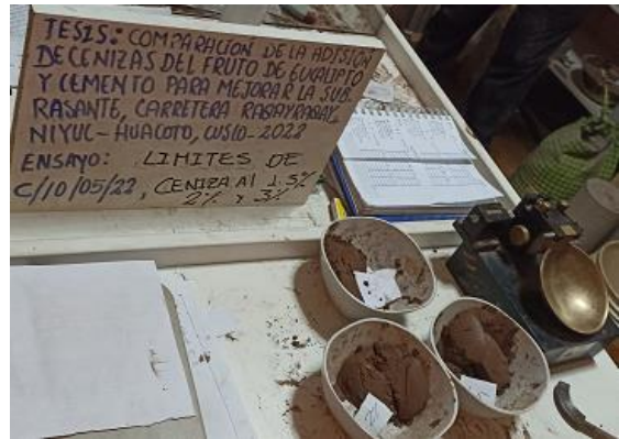
Foto 28. Ensayo de límites de consistencia con 2% de ceniza.
