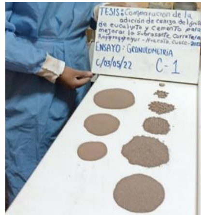
Foto 10. Ensayo de granulometría de la calicata C-01.
