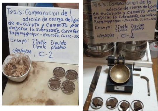
Foto 15. Ensayo de límites de consistencia de la calicata C-02.
