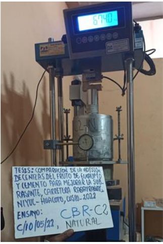
Foto 17. Ensayo de CBR. Calicata C-02.
