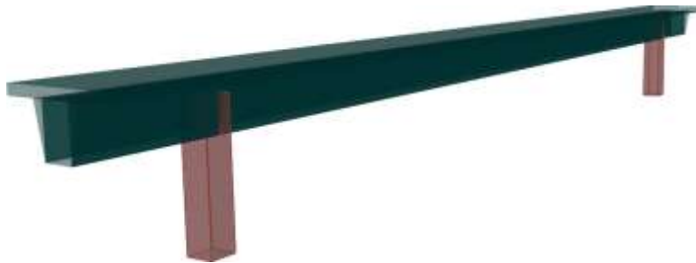
Figura 22: Modelo tridimensional de puente peatonal San Luis, elaborado en SAP 2000. Fuente: Elaboración propia.
