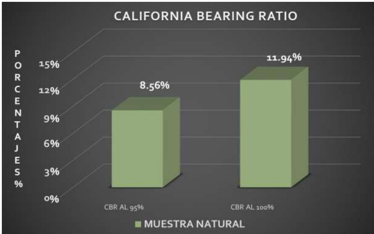
Figura N° 13: Gráfico del California Bearing Ratio (CBR) de la muestra Natural
