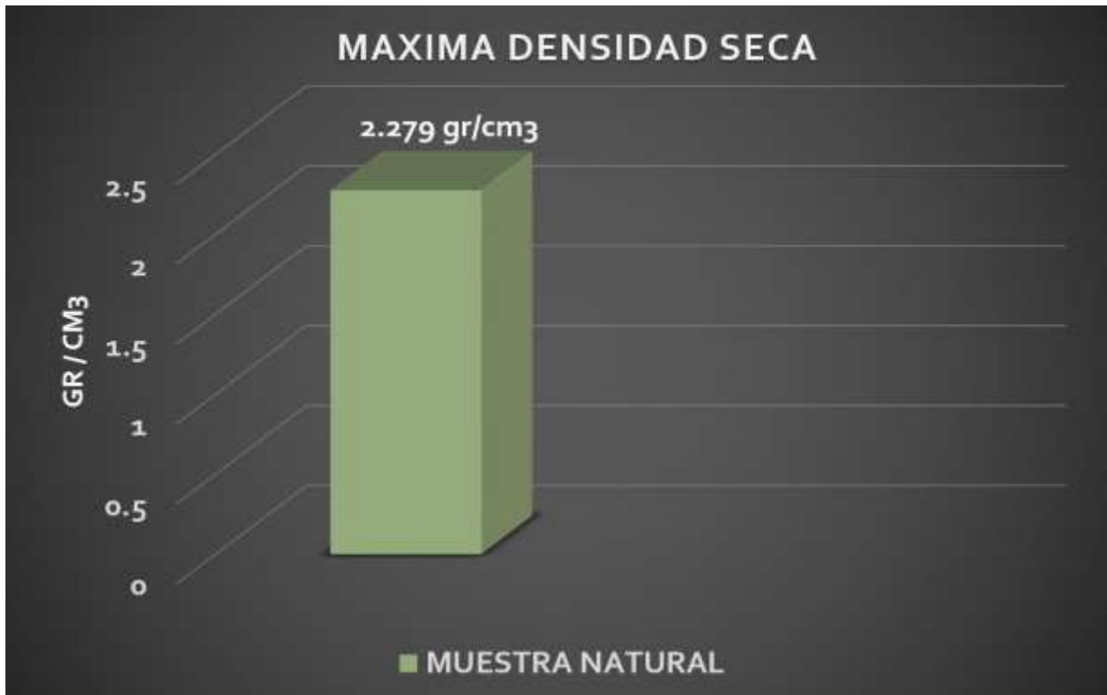
Figura N° 12. Gráfico de Máxima Densidad Seca de la muestra inicial.
