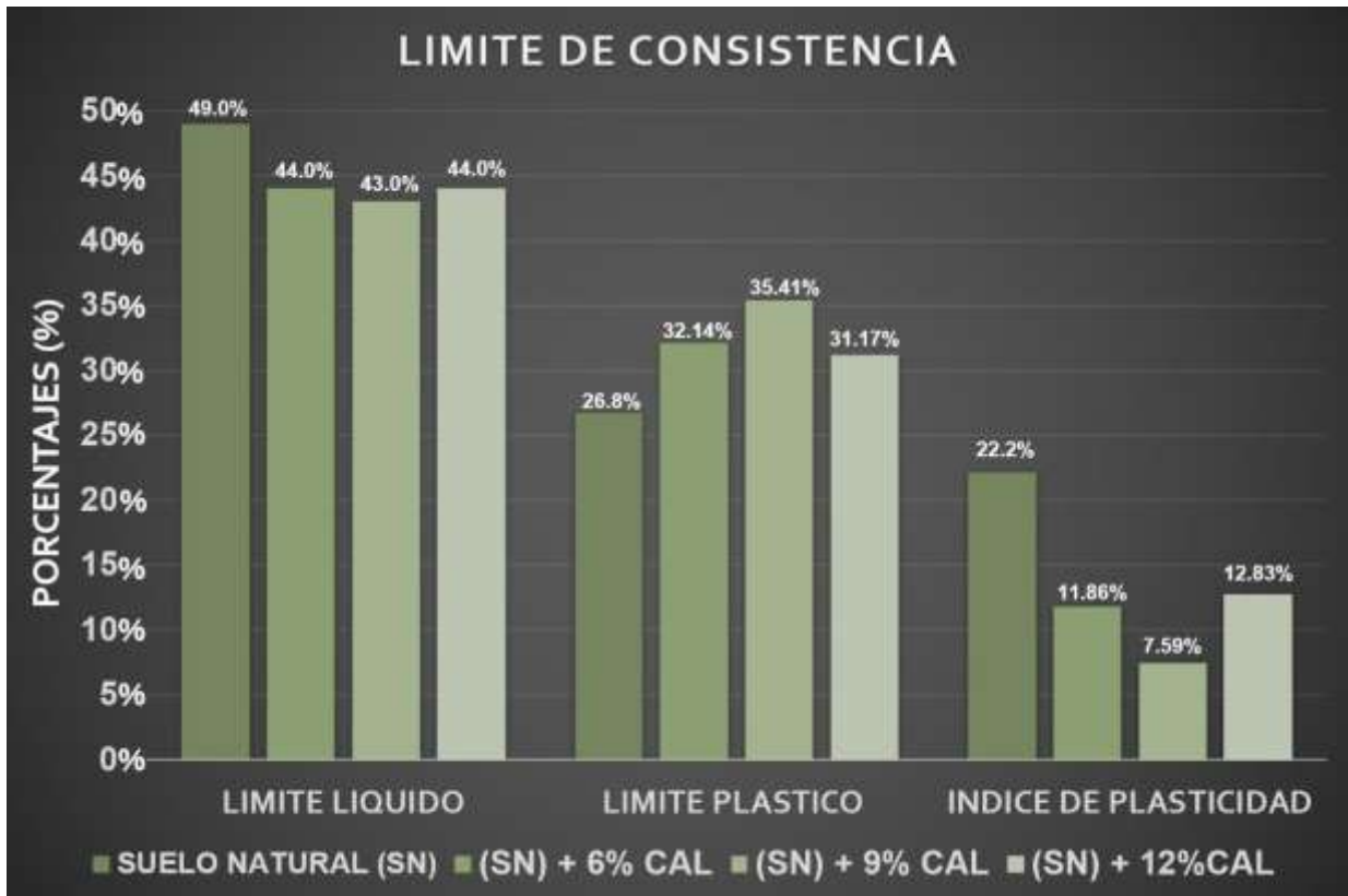
Figura N° 19: Gráfico del Ensayo de Atterberg con la incorporación del Óxido de Calcio.
