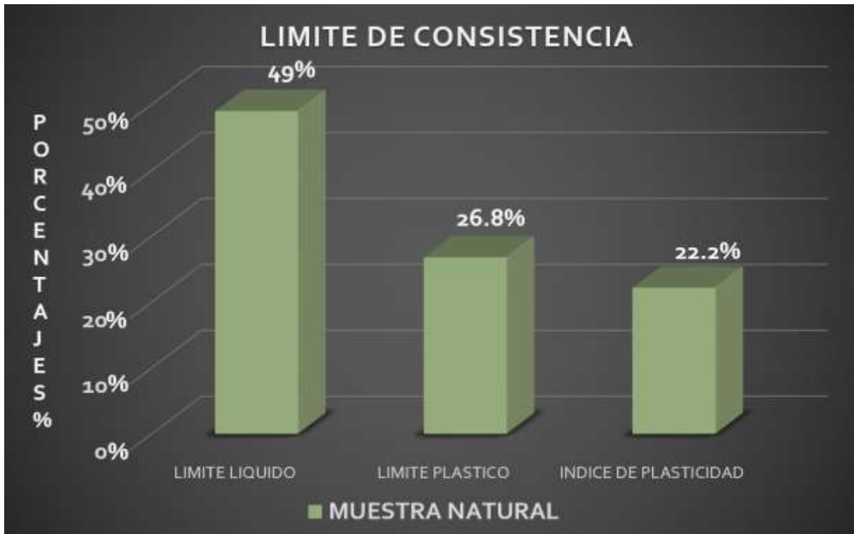
Figura N° 10: Gráfico del límite de consistencia de la muestra natural.
