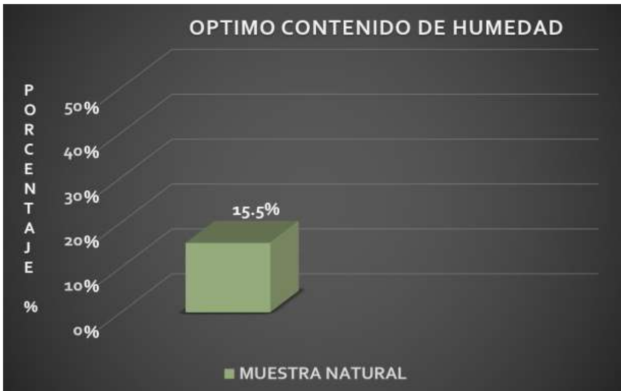
Figura N° 11: Gráfico del Optimo Contenido de Humedad inicial.
