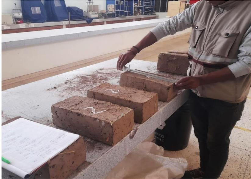
**Figura 15.** Ensayo de Variación Dimensional
