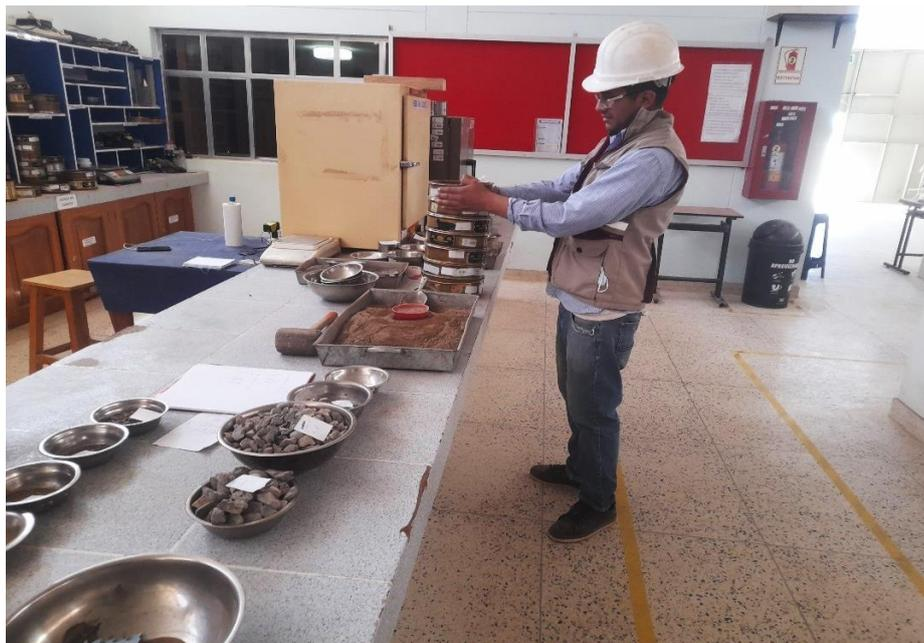
**Figura 33.** Realización del ensayo de Limites de consistencia
