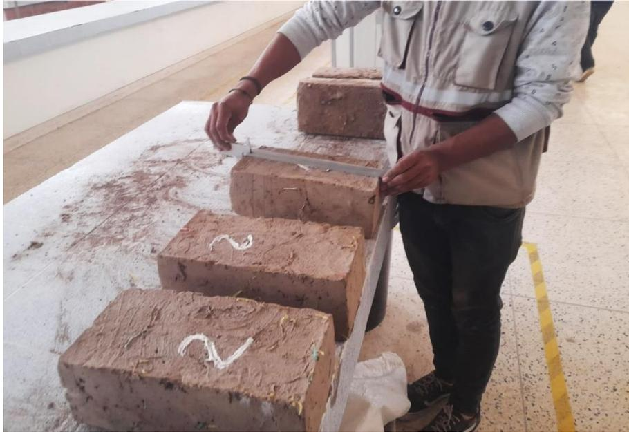
**Figura 38.** Realización del ensayo de alabeo
