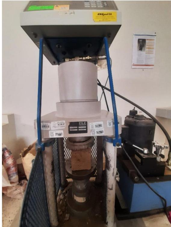
**Figura 11.** Máquina de Ensayo a la Rotura
