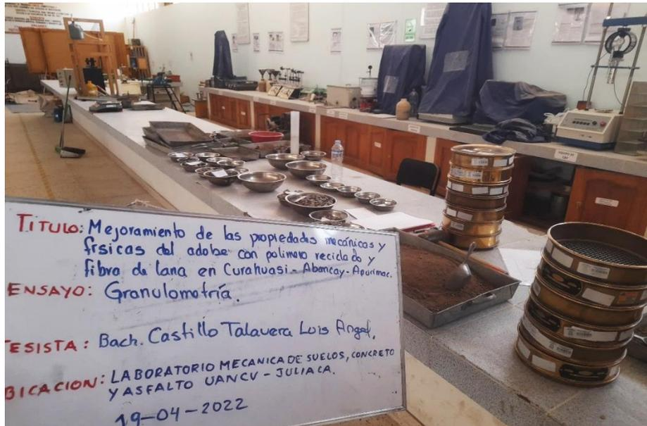
**Figura 34.** Realización del ensayo de granulometría
