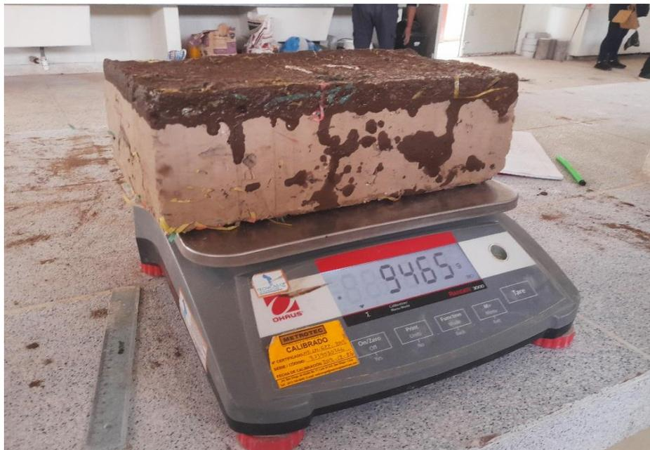
**Figura 35.** Realización de ensayo de succión
