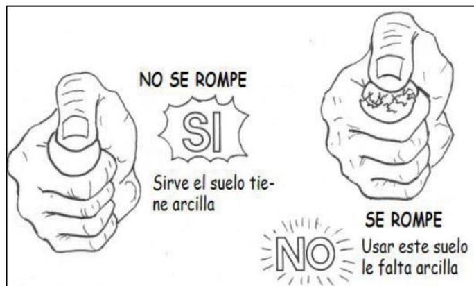
**Figura 4.** Prueba de presencia de Arcilla – Paso 2
