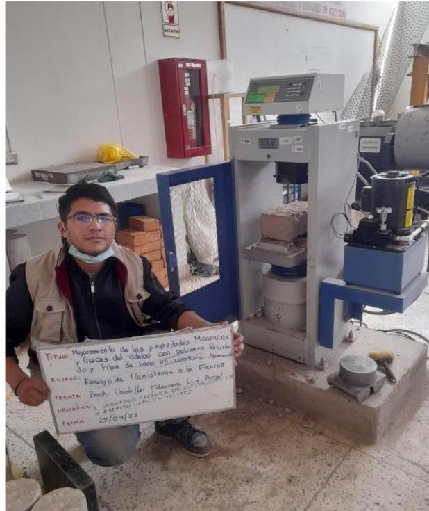
**Figura 17.** Máquina de Ensayo a la Rotura
