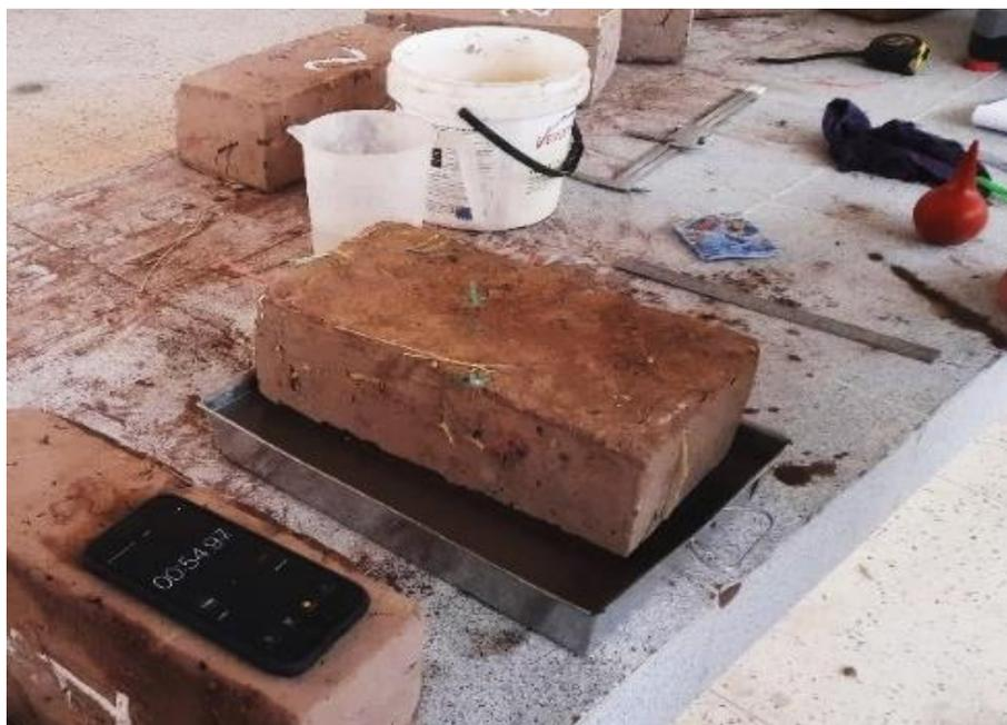
**Figura 14.** Ensayo de Succión
