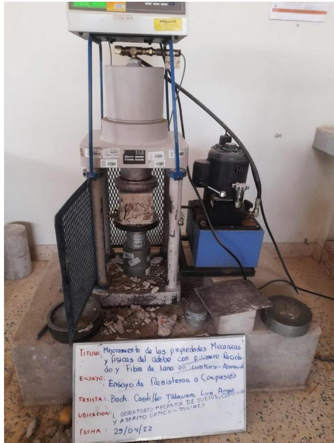
**Figura 36.** Maquina de rotura
