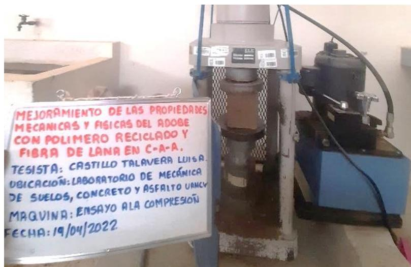
**Figura 16.** Rotura de bloques de adobe
