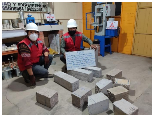
Figura 19. Vigas fraccionadas a L/3 de su longitud.
