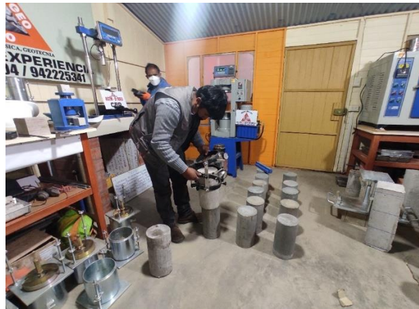
Figura 27. Colocado de anillos de sujeción y diales para módulo de elasticidad
