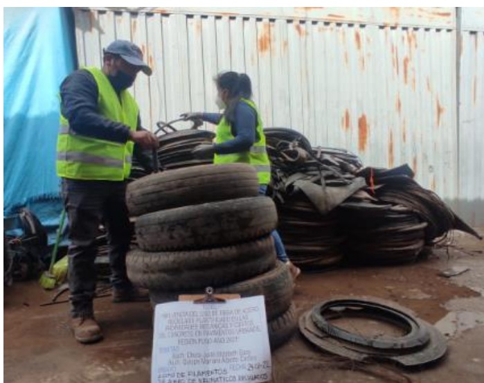
Figura 41. Acopio y corte del talón de las llantas en desuso.
