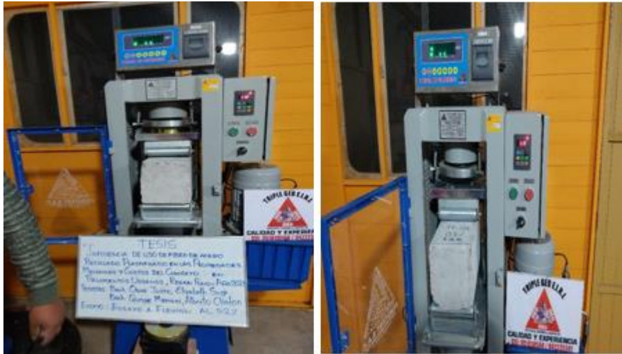
Figura 18. Rotura de vigas para flexión.
