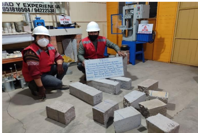
Figura 15. Observamos las vigas de concreto que serán sometidas al ensayo.
