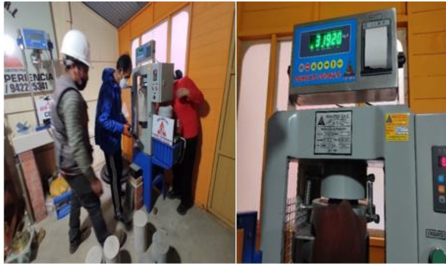
Figura 11. Colocado de la Probeta de Concreto en Prensa Hidráulica.
