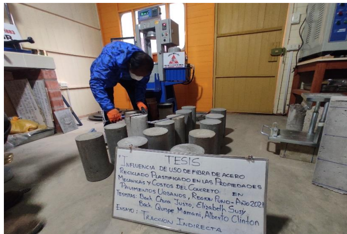
Figura 21. Medición del diámetro y longitud de las Probetas de Concreto
