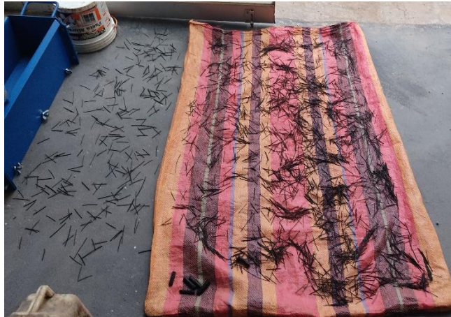
Figura 46. Las fibras de acero reciclado en su proceso de secado.
