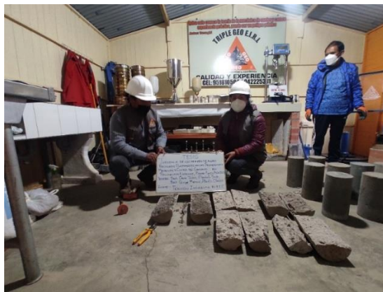
Figura 25. Muestras ensayadas y sección de corte.
