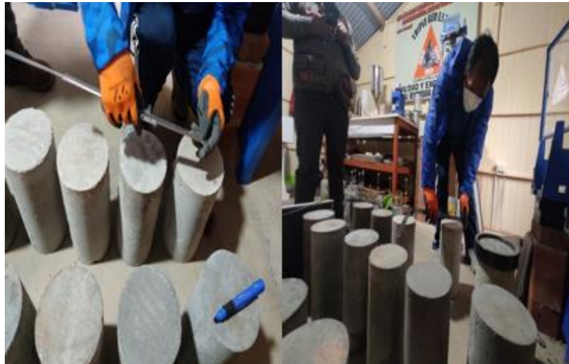
Figura 10. Medición de las Probetas de concreto con vernier.
