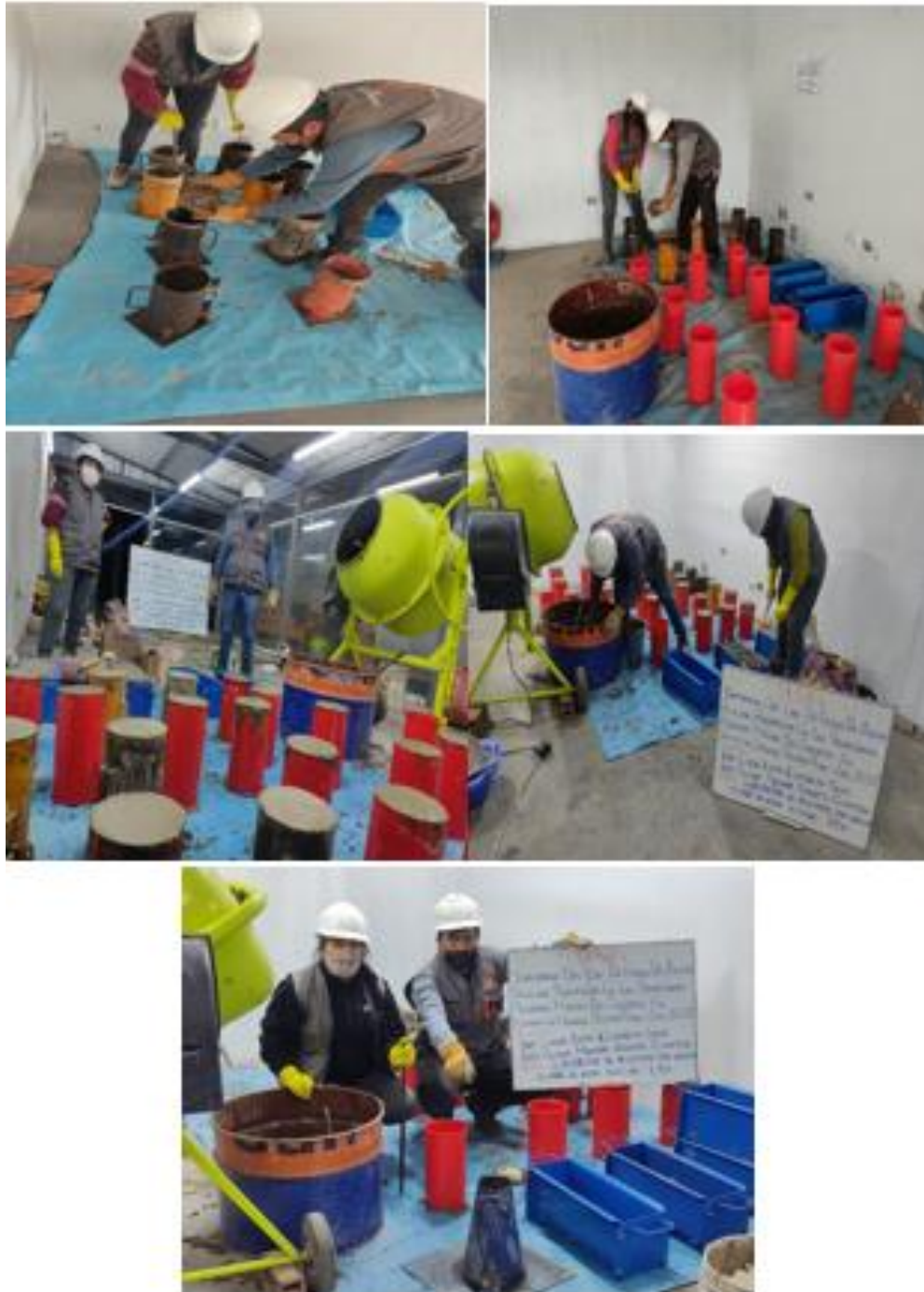
Figura 56. Se observa el desarrollo de las probetas de concreto
