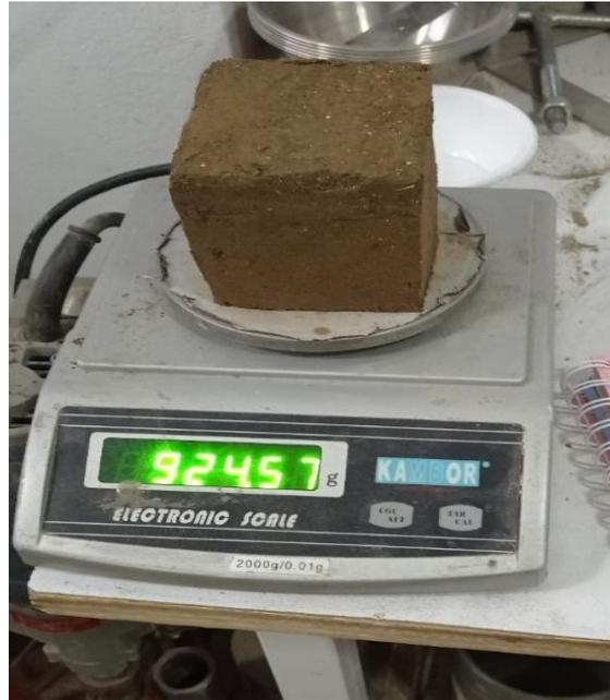
Figura 7. Peso del muestreo para la determinación del peso volumétrico
