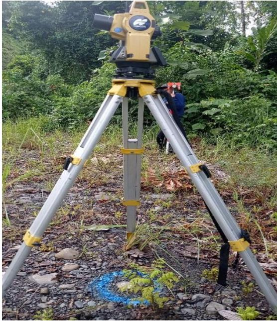
Figura 1. Levantamiento topográfico con estación total
