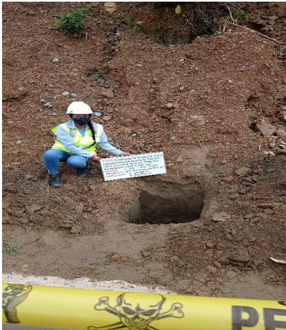
Figura 2. Obtención de muestra en calicata km 346+976 al km 347+032
