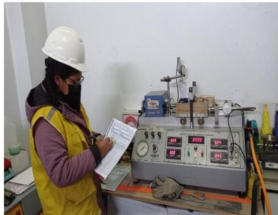
Figura 8. Ensayo de corte directo
