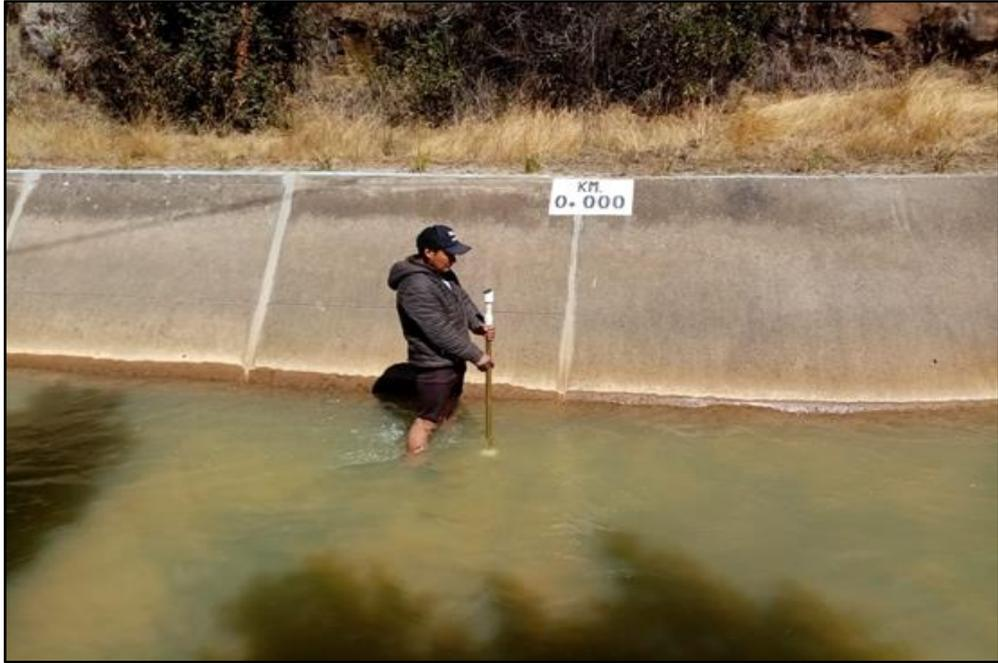
**Figura 12.** Aforo en la Prog. 0+000 Km – Tramo I.
