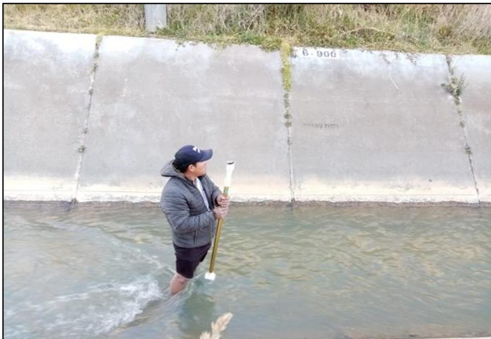
**Figura 13.** Aforo en canal de ingreso a la presa Prog. 6+900 Km
