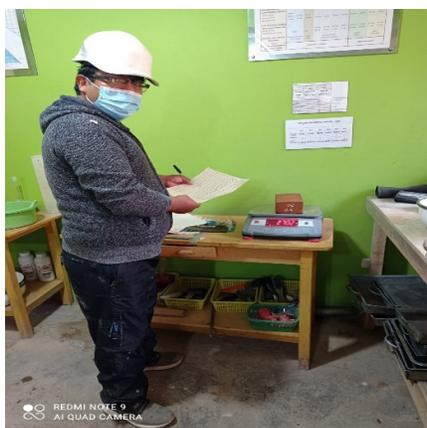
*Figura 64.* Definición del peso del ladrillo artesanal de arcilla incorporado con lodo en 0%, 5%, 10%, 15% y 20%
