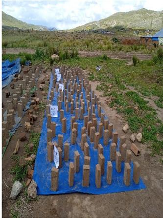
*Figura 11.* Proceso de secado de los especímenes
