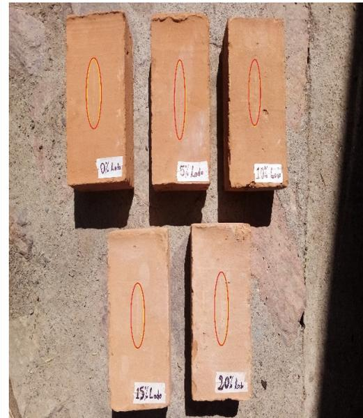
*Figura 20.* Determinación de color, textura, solidez y dureza del ladrillo artesanal con incorporación de lodo.
