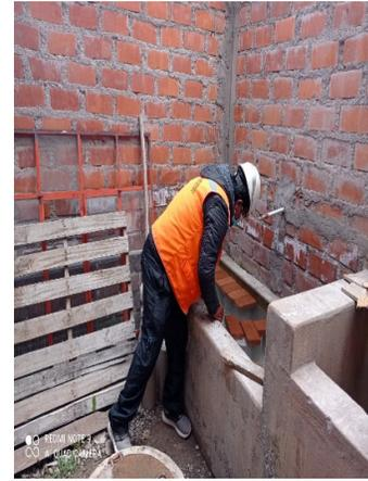
*Figura 33. Extracción de especímenes de tanque de agua*
