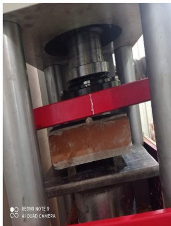
Figura 46. Resistencia de tracción con apoyos
