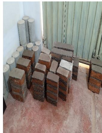
*Figura 14.* Elaboración de los primas de albañilería
