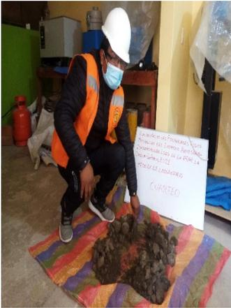
*Figura 17.* Cuarteo de muestra lodo de la PTAR
