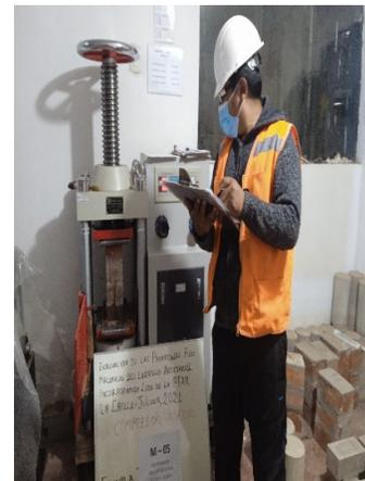
*Figura 44.* Resistencia a la compresión uniaxial M-06
