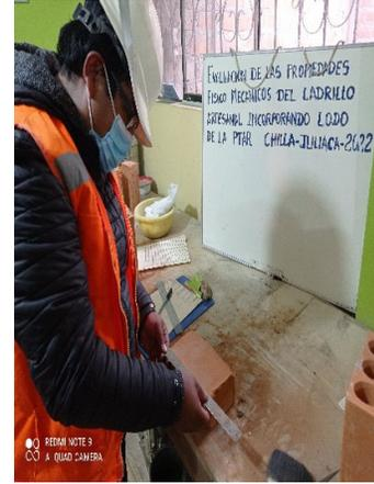
*Figura 22.* Medición de la altura del espécimen
