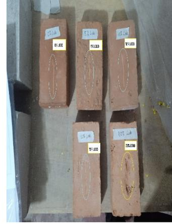
*Figura 52.* Determinación de la textura de los especímenes
