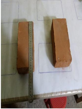
*Figura 20.* Medición del largo del espécimen
