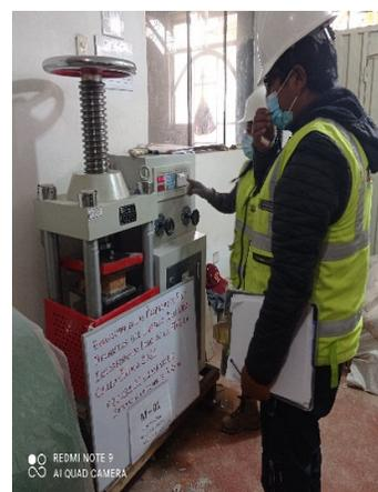
Figura 40. Resistencia a la compresión del espécimen con 5% de lodo
