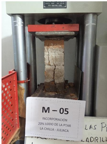
*Figura 19.* Falla a la compresión uniaxial en prismas
