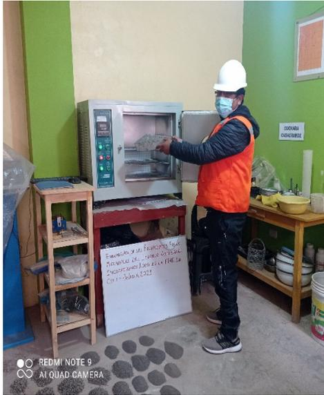
**Figura 05.** Ingreso al horno electrónico de muestra de lodo.
