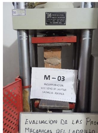
*Figura 43.* Resistencia a la compresión uniaxial M-03
