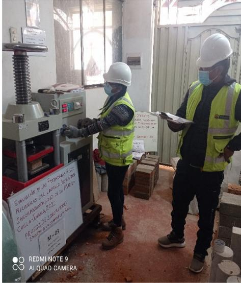
**Figura 13.** Ensayos de compresión axial
