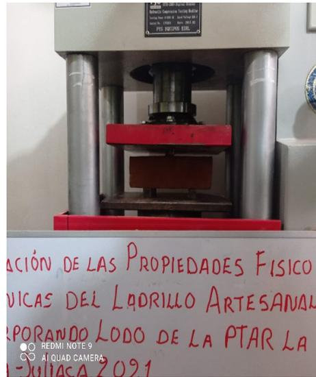
**Figura 14.** Ensayo de tracción por flexión de la unidad de albañilería
