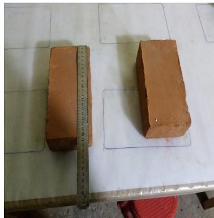
*Figura 60. Determinación de la variación dimensional del ladrillo 5% incorporado de lodo*
