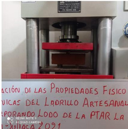
*Figura 61. Ensayo de resistencia a la compresión axial al ladrillo de 15% incorporado de lodo*
