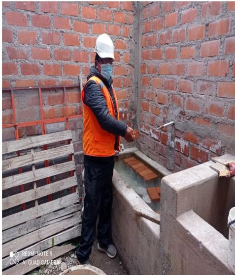
*Figura 11.* Sumergido de ladrillo en agua para determinación al succión.
