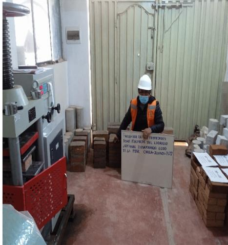
*Figura 17.* Endurecimiento de testigos de albañilería (prismas) por 28 días.
