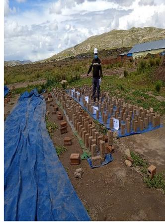
*Figura 12.* Verificación de secado de especímenes
