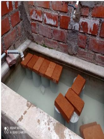
*Figura 31. Colocado al tanque de agua de los especímenes*
