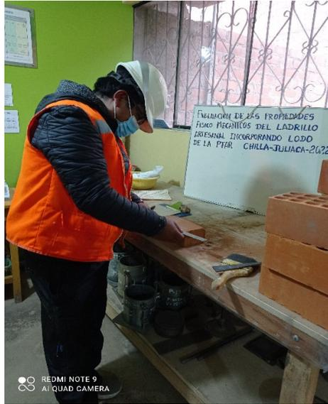
*Figura 09.* Determinación de variación dimensional
