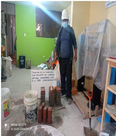
**Figura 15.** Elaboración de prismas de albañilería
