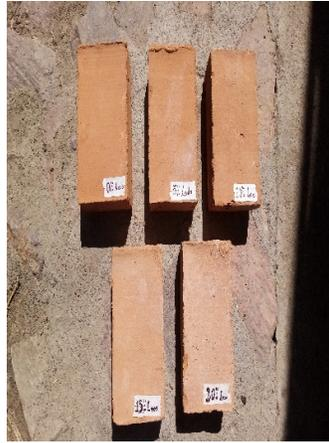
*Figura 51.* Determinación del color de los especímenes
