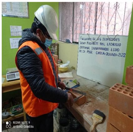
*Figura 59. Determinación del alabeo del ladrillo 10% de incorporado de lodo*
