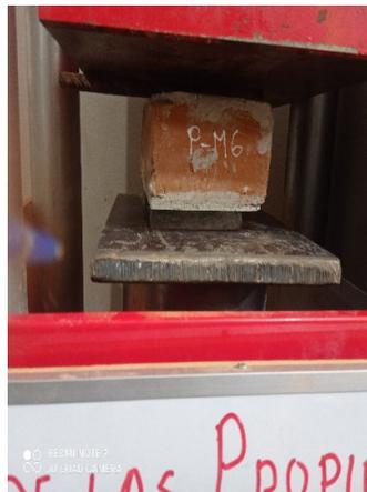
Figura 39. Rotura de ladrillo con 20% de lodo
