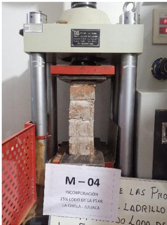
*Figura 42.* Resistencia a la compresión uniaxial M-04
