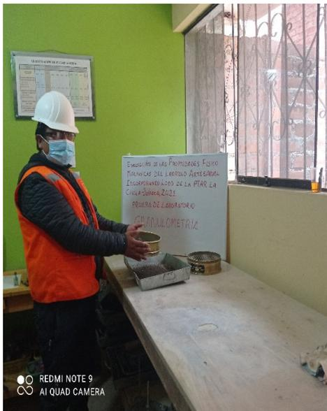
**Figura 07.** Ensayo del análisis granulométrico del lodo de la PTAR.
