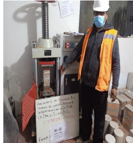
*Figura 18.* Ensayo de resistencia a la compresión uniaxial en prismas de albañilería.
