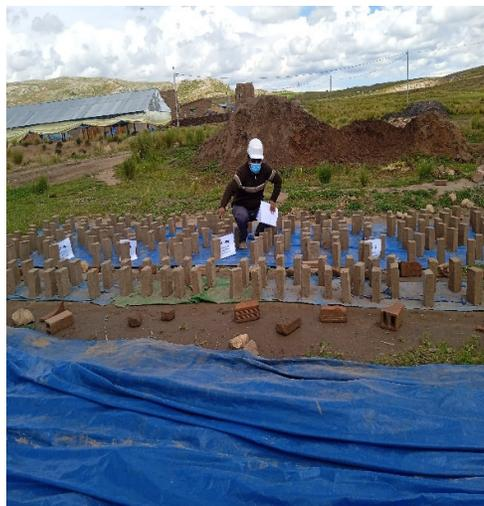
*Figura 03.* Secado de ladrillo a temperatura ambiente (14 días)
