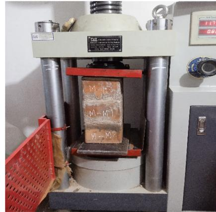
*Figura 62. Ensayo de resistencia a la compresión uniaxial de prismas de ladrillo con incorporación de 20% de lodo*
