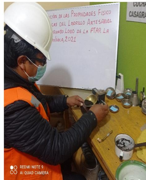
**Figura 08.** Ensayo para determinar en límite líquido en la copa de Casagrande del lodo de la PTAR
