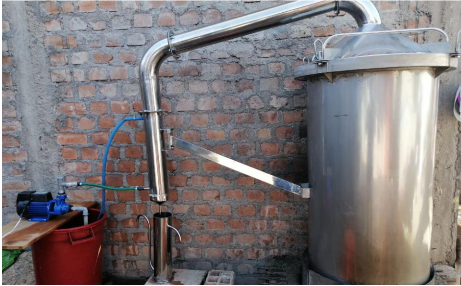
Figura No. 1: Equipo por arrastre de vapor de material de acero quirúrgico, para la obtención de hidrolato de Molle.
