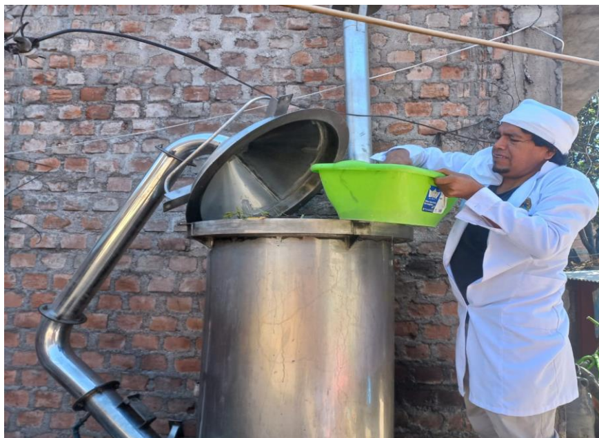
Figura No. 4: Cargado la materia prima al destilador por arrastre por vapor, para procesar hidrolato de molle.
