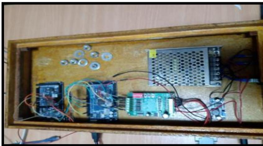
**Figura N° 12 Ensamblaje del controlador electrónico de la mesa vibratoria**
