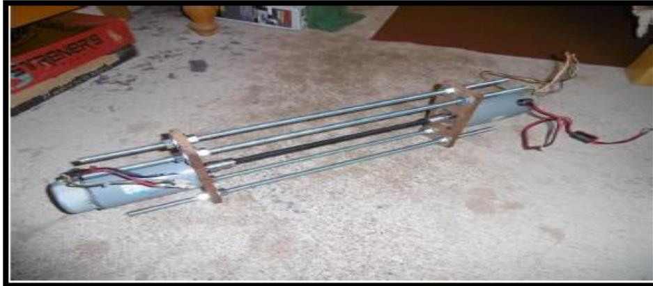
Figura N°7 Armado del actuador Mecánico
