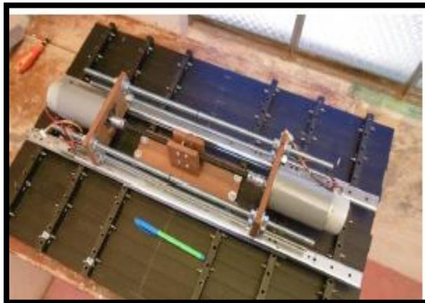
**Figura N° 10 Colocación del motor a la plataforma de la mesa vibratoria**
