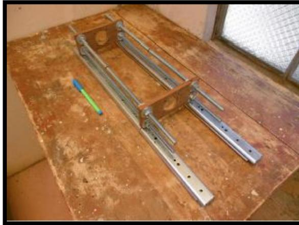
**Figura N°9 Empernado de los rieles de desplazamiento**
