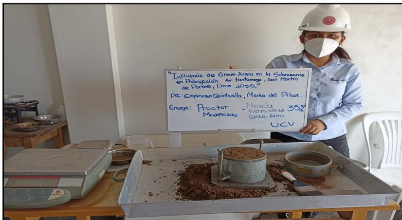
**Figura n° 27:** Ensayo Proctor Modificado al SN+ 35% GA.
