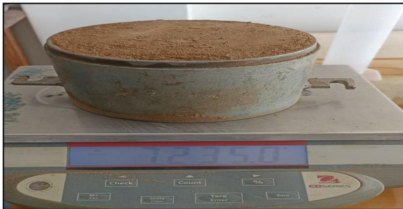
**Figura n° 25:** Ensayo Proctor Modificado al SN+ 15%GA.
