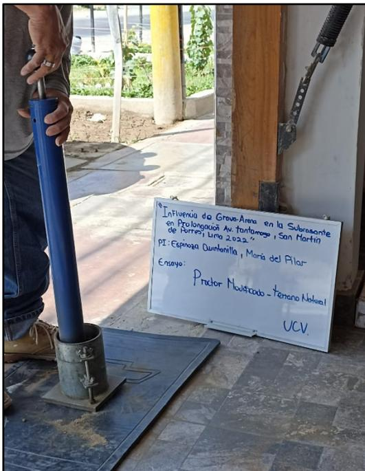
Ensayo de Proctor Modificado - TN.
