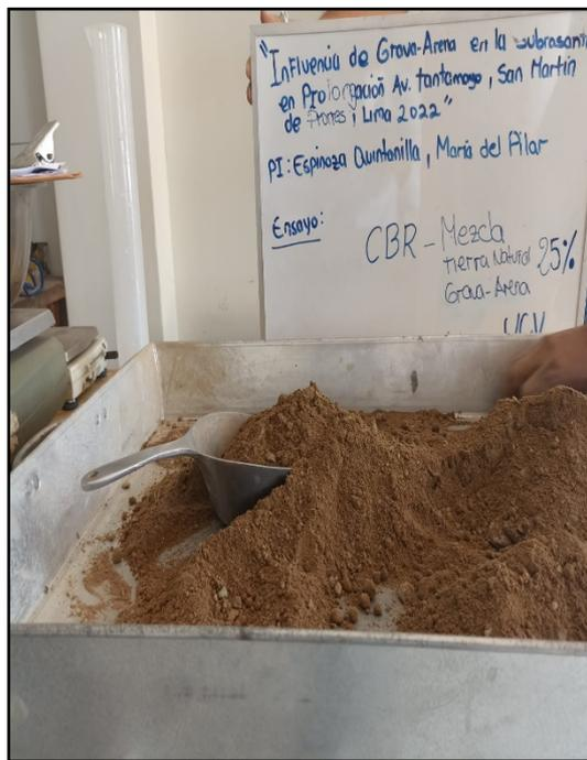
Ensayo C.B.R. para la muestra 25%.
