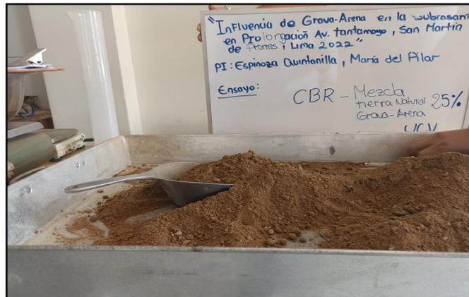
**Figura n° 34:** Ensayo de C.B.R. al 25%GA
