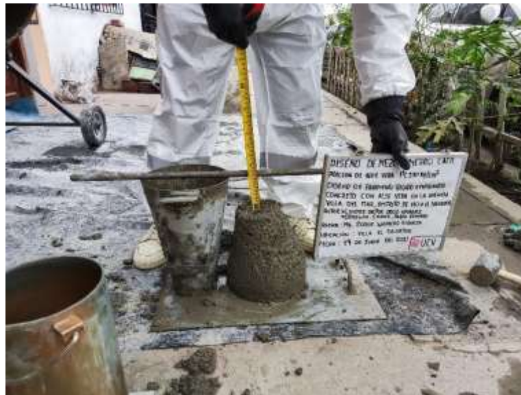
Figura 25 Concreto con 1.9% A.V SLUMP
