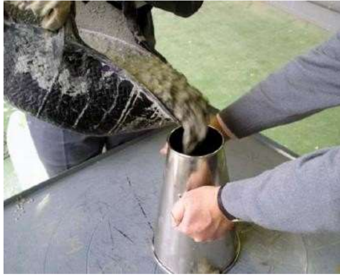
Figura 44 Llenado del cono de Abrams.
