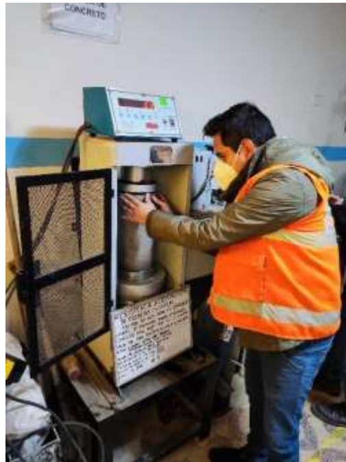
Figura 53 Puesta de especímenes en la prensa
