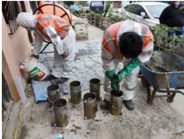
Figura 47 Varillado del espécimen
