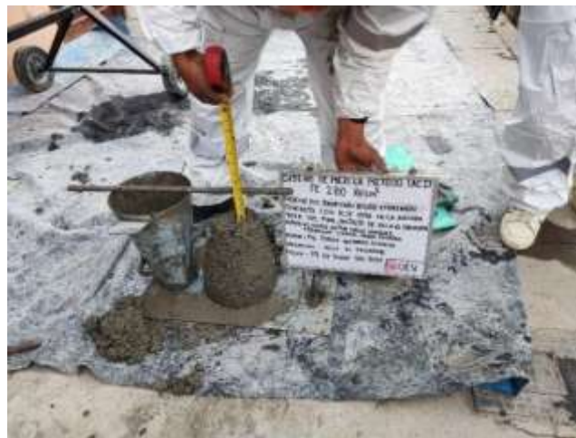
Figura 41 SLUMP de concreto patrón
