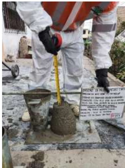
Figura 43 SLUMP concreto con 6% aloe vera.
