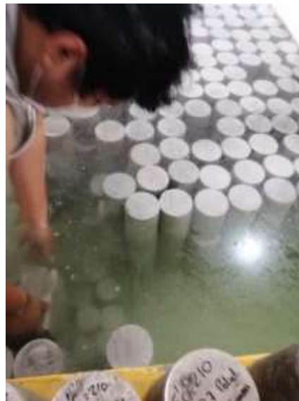
Figura 49 Especímenes en proceso de curado
