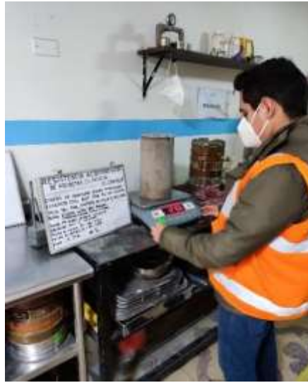
Figura 54 Peso de los especímenes.
