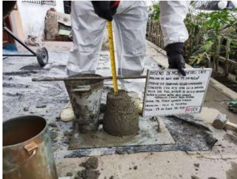
Figura 42 SLUMP concreto con 1.9% aloe vera.
