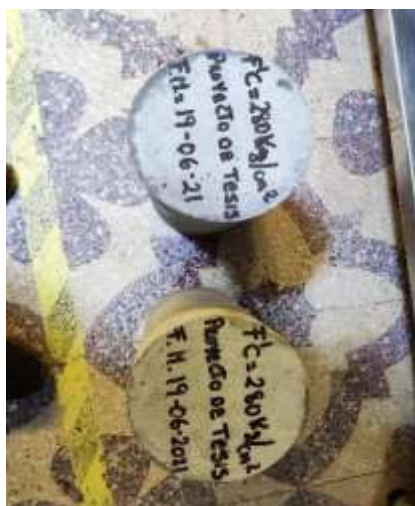
Figura 51 Especímenes preparados para el ensaño.
