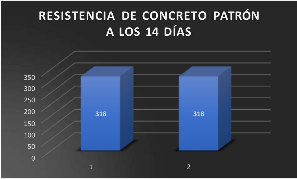
Figura 28 Resistencia patrón en 14 días
