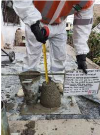
Figura 26 Concreto con 6% A.V SLUMP
