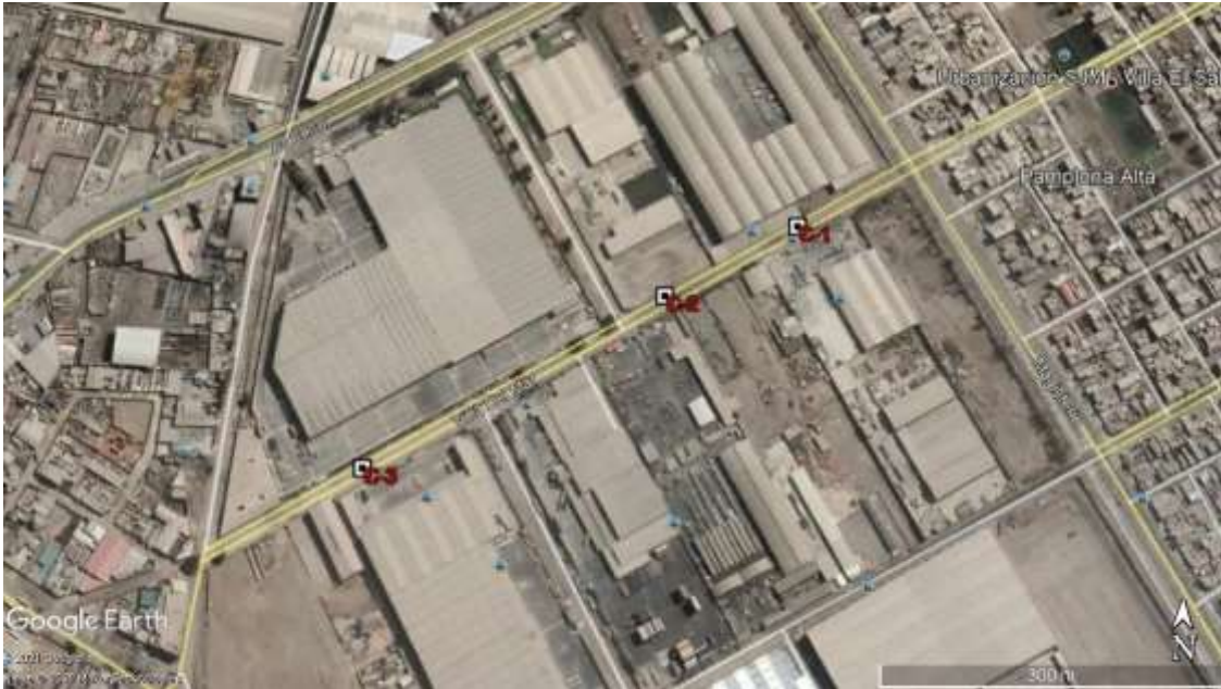
Figura 7 Ubicación de calicatas del área de estudio de mecánica de suelos
