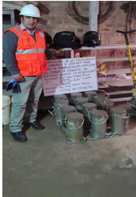
Figura 10. Vaciado de probetas
