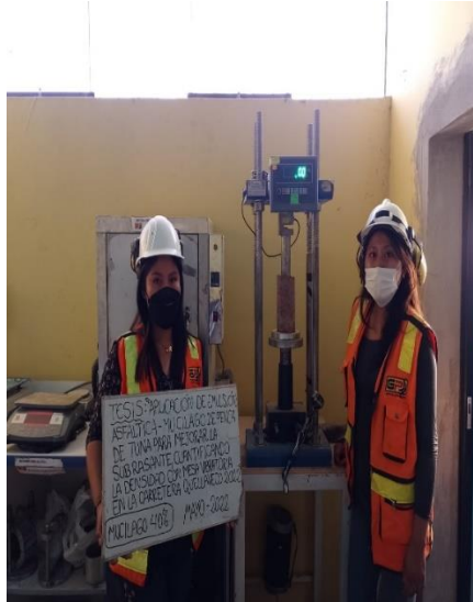
Figura 26. Ensayo de CBR ASTM D1883
