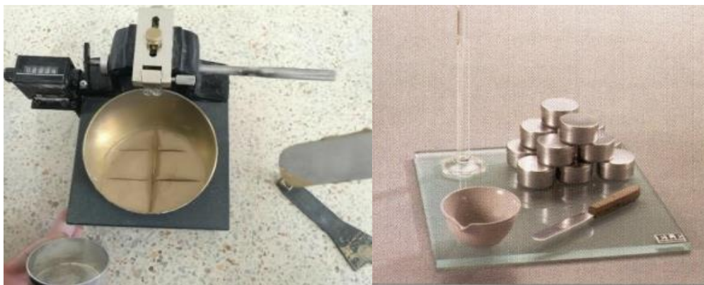
Figura 12. Ensayos para el índice de plasticidad
