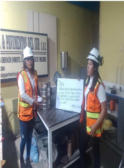
Fotografía 15. Inicio del Ensayo de granulometría
