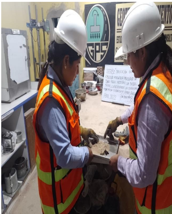
Fotografía 43. Ensayo de limite aplicado con mucilago de la penca de tuna. Emulsión asfáltica
