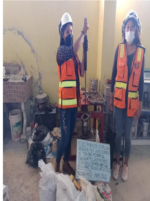
Fotografía 54. Ensayo de compactación de muestra de CBR con MT
