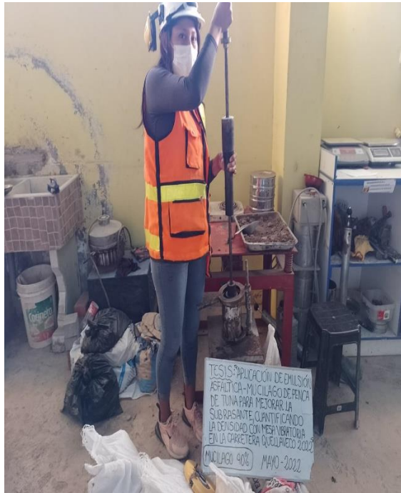
Fotografía 53. Ensayo de compactación de muestra de CBR con EA
