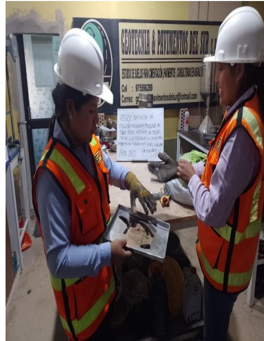
Fotografía 46. Ensayo de limite aplicado con emulsión asfáltica.
