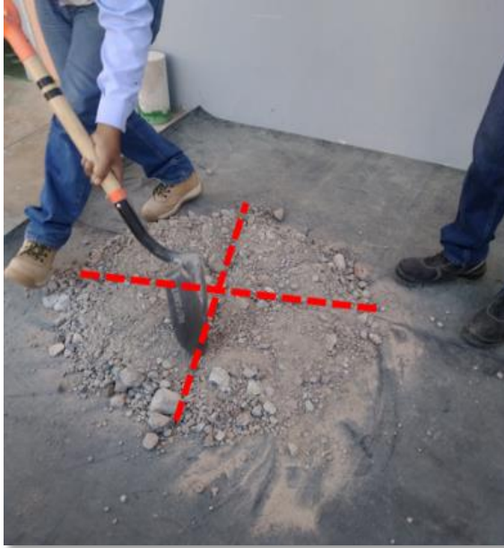
Fotografía 37. Realizamos el cuarteo con la muestra.
