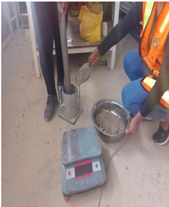
Fotografía 47. Pesaje de muestra para ensayo de límites de consistencia
