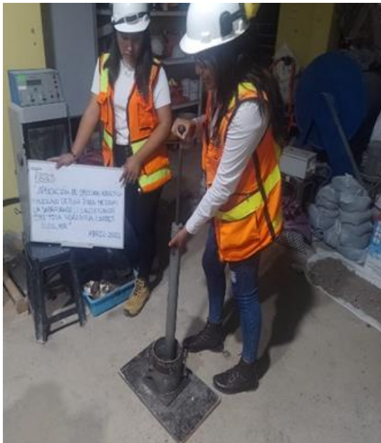
Figura 37. Ensayo ASTM D-1557 Proctor modificado
