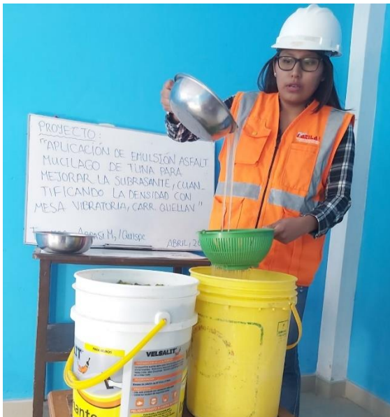
Fotografía 35. Colado del mucilago de la penca de tuna.
