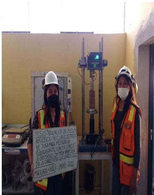
Fotografía 55. Ensayo de CBR con dosificaciones de MT
