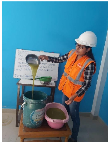
Fotografía 36. Obtención del mucilago de la penca de tuna.
