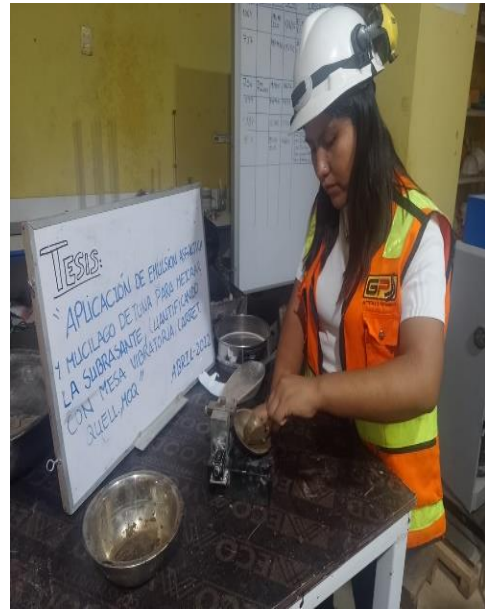
Fotografía 38. Realizando el ensayo L.L. con la cuchara casa grande.
