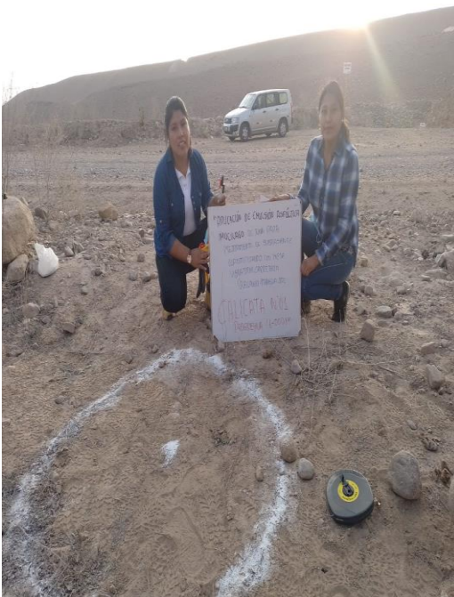
Fotografía 3. Demarcación de la calicata N°01 en el km 16+000
