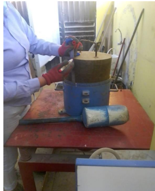
Figura 38. Ensayo ASTM D-4253 - Mesa vibratoria
