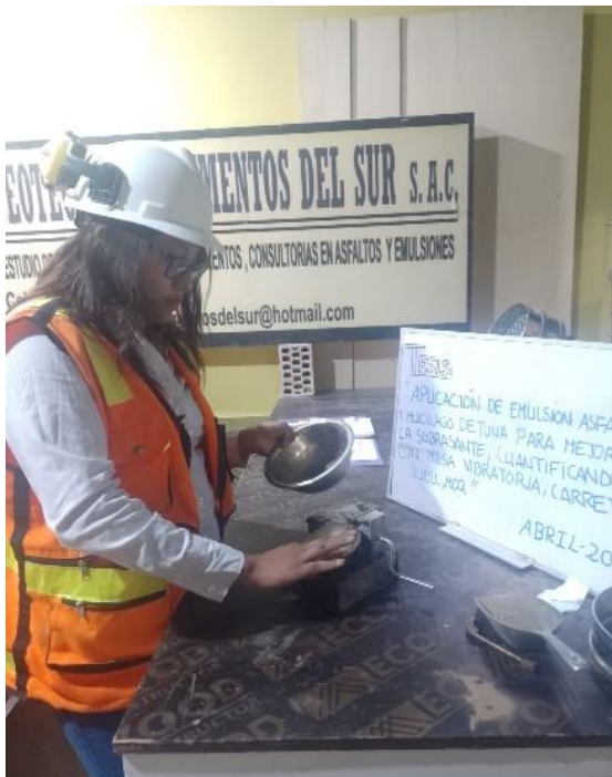
Fotografía 39. Ensayo de límite con la cuchara casa grande.
