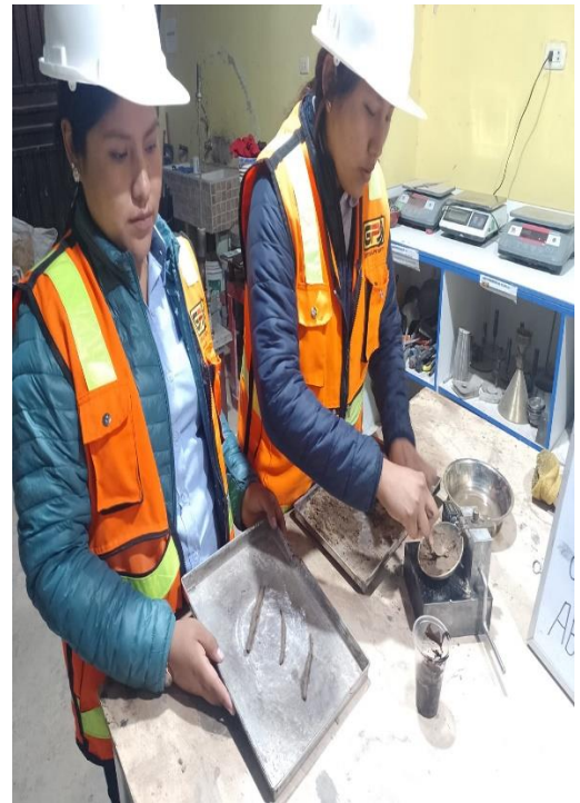
Fotografía 44. Ensayo de limite aplicado con mucilago de la penca de tuna.
