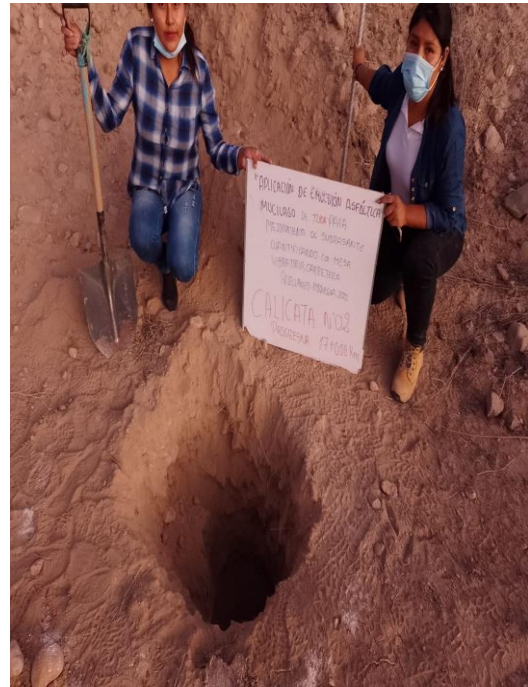
Fotografía 12. Exploración a 1.50 m en la calicata N°02.
