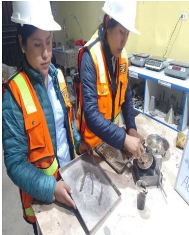
Figura 32. Límites de consistencia con adición de EA
