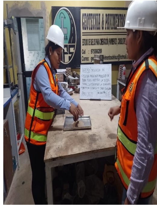
Fotografía 42. Mezclando la emulsión al 6%.
