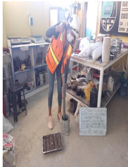
Fotografía 48. Realizamos el ensayo de compactación con Proctor modificado (MT)
