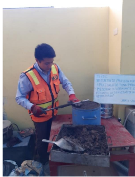
Fotografía 50. Ensayo de compactación aplicando la (MV)
