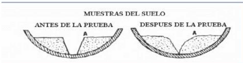
Figura 1: Aparato manual para límite líquido
