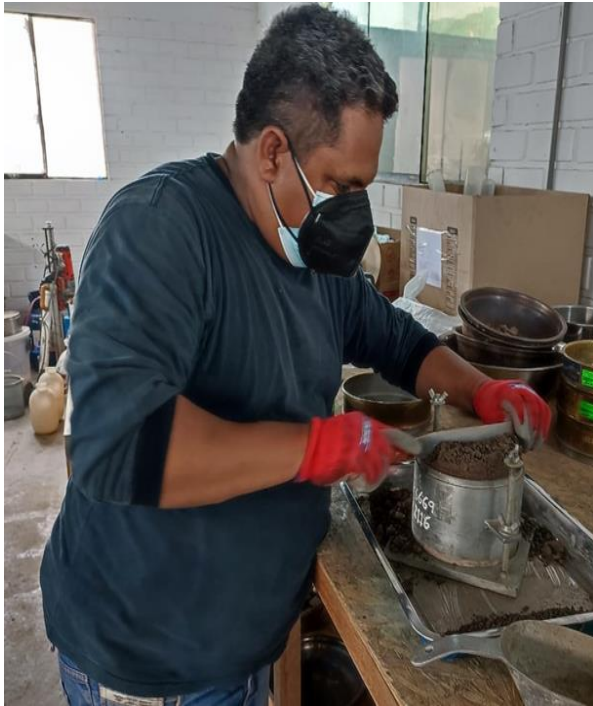
Foto 9: Muestra añadida en Molde de Proctor Modificado
