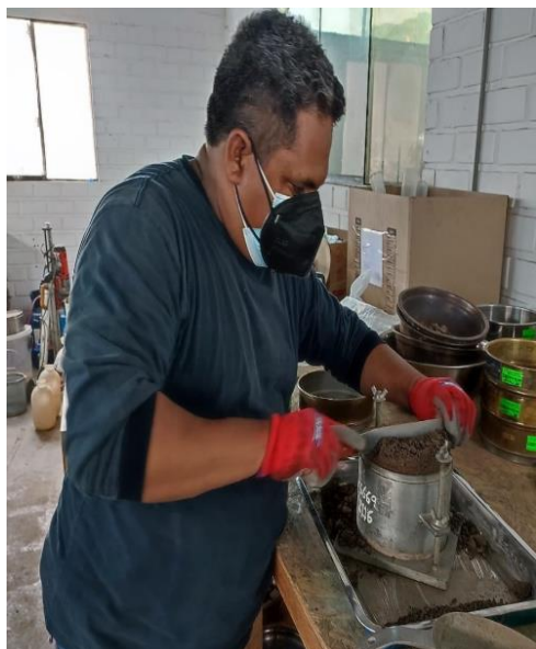
Figura 15. Ensayo Proctor Modificado Patrón + 4%, 6% y 8% de ceniza de bagazo de caña
