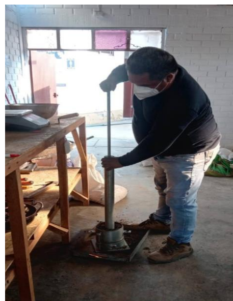
Figura 16. Compactación por capa del Patrón + 4%, 6% y 8% de ceniza de bagazo de caña
