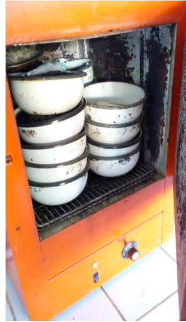
Figura 18: Contenido de Humedad de los Agregados
