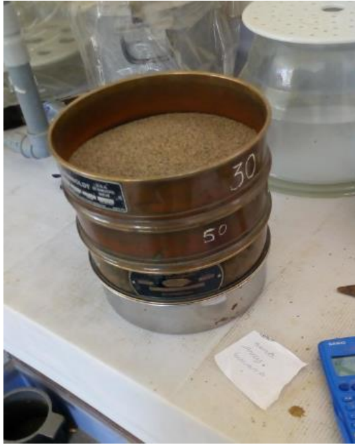
Figura 17: Granulometría de los Agregados
