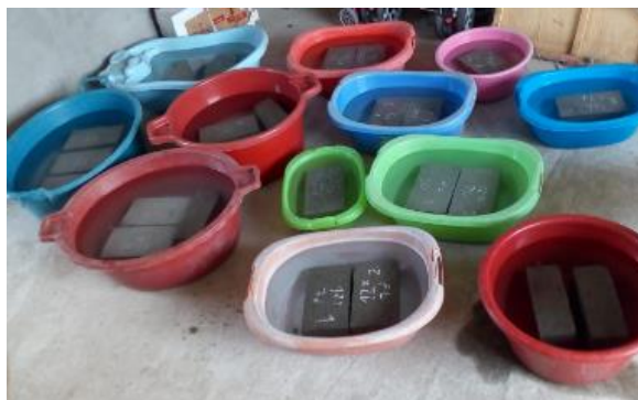
Figura 26: Curado de ladrillos sumergidos en agua
