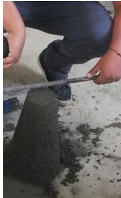
Figura 23: Asentamiento de 0 pulgadas
