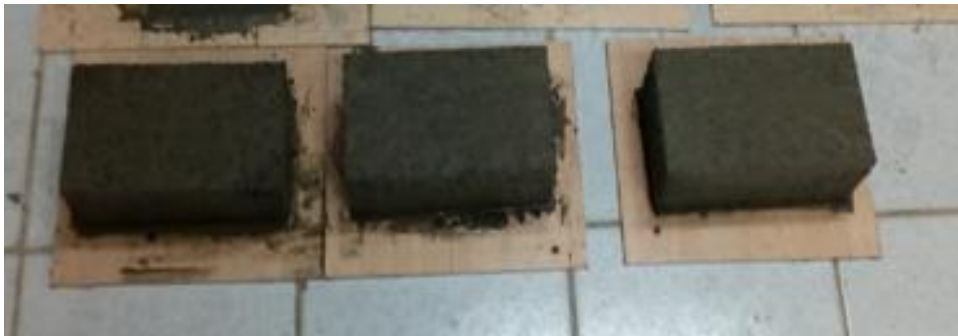
Figura 25: Ladrillos elaborados de concreto
