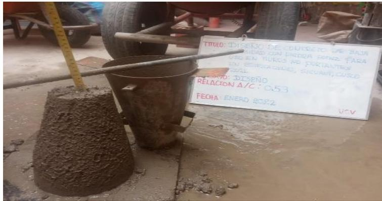
**Figura 74.** Slump diseño
