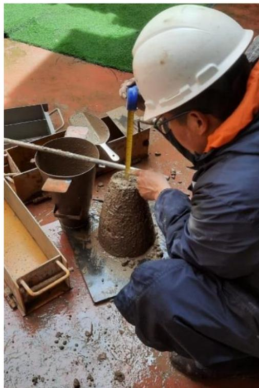
**Figura 34.** SLUMP según los diseños seleccionados.
