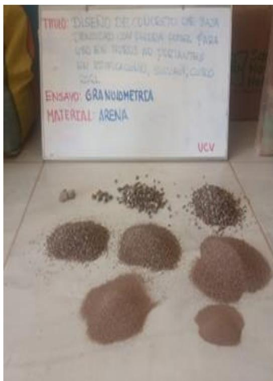
**Figura 19.** Resultado granulométrico de la arena gruesa.
