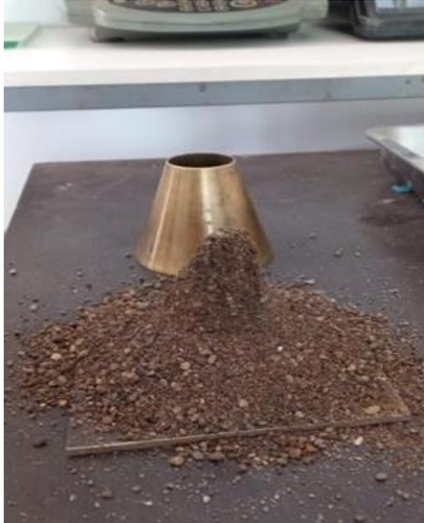
**Figura 25.** Condición óptima de humedad para el ensayo.
