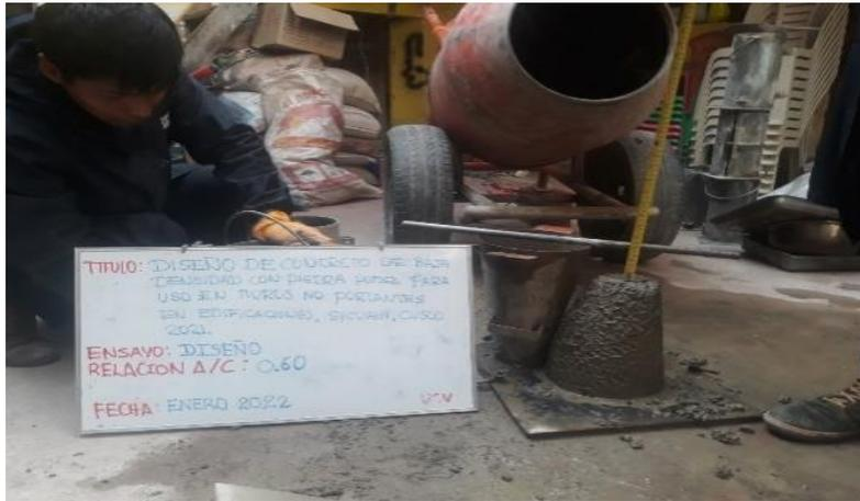
**Figura 71.** Slump de diseño.
