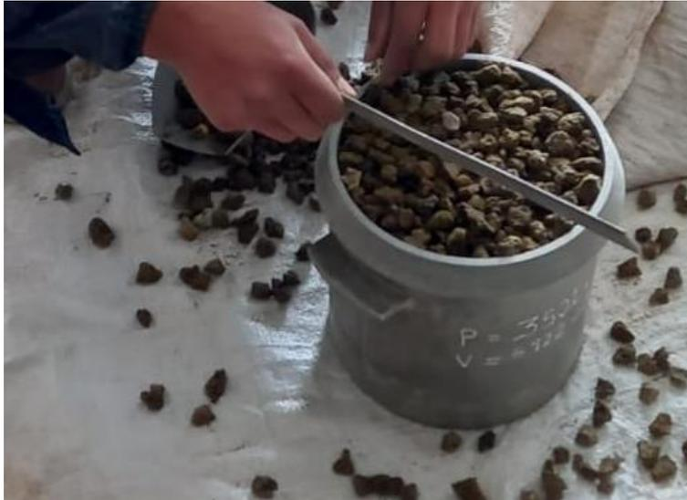
**Figura 11.** Moldeado y enrazado de grava suelta y compactado.
