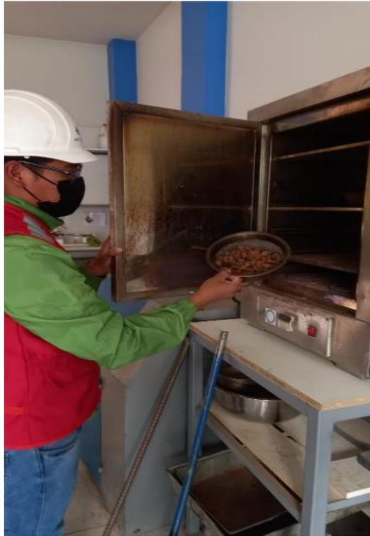
**Figura 52.** Secado del agregado.
