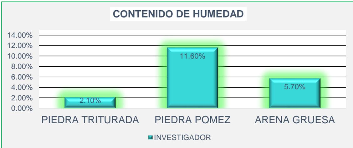
**Figura 53.** Contenido de humedad de los agregados.
