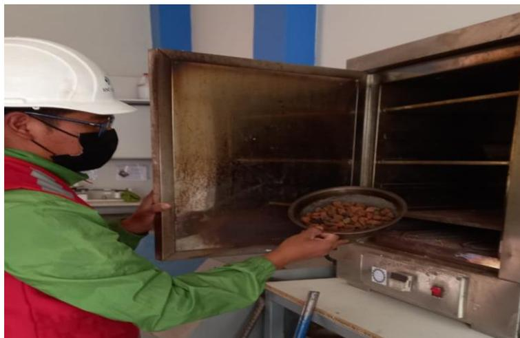
**Figura 7.** Muestra llevada al horno a 100 °C/24 horas.
