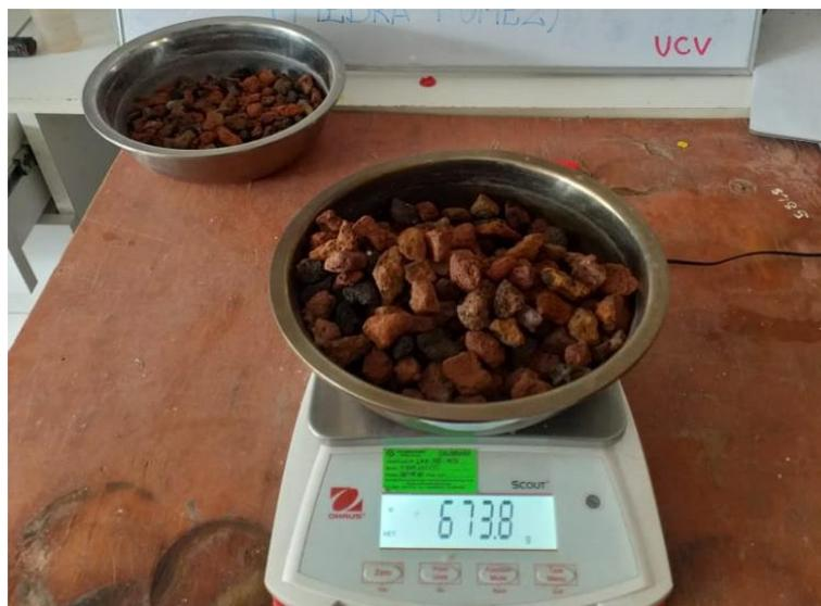
**Figura 13.** Durabilidad al sulfato de magnesio.
