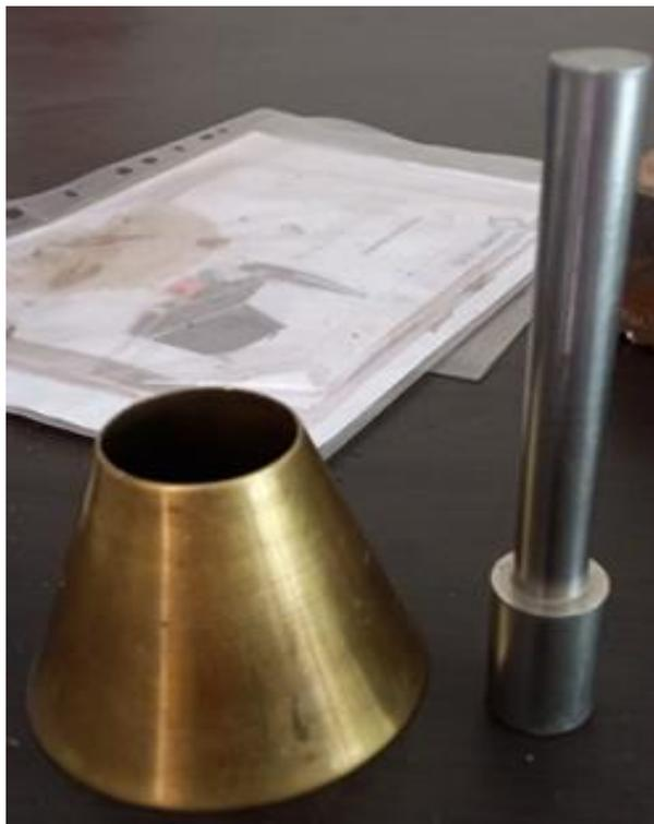
**Figura 24.** Molde de metal de forma troncocónica y compactador metálico.
