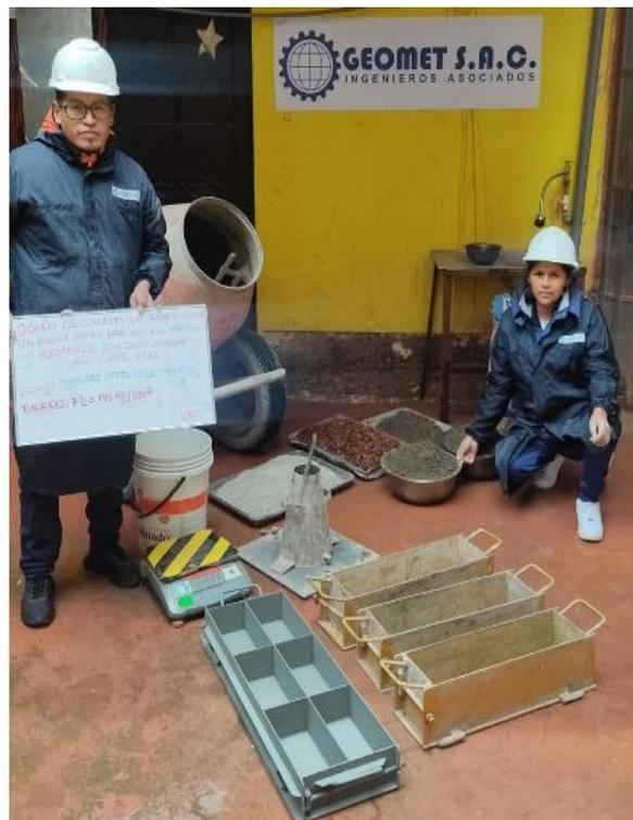
**Figura 38.** Vista de la elaboración de unidades de concreto de baja densidad.
