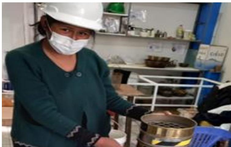
**Figura 18.** Proceso de tamizado de la arena gruesa.
