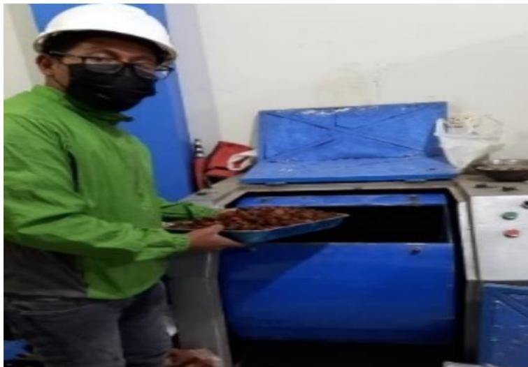
**Figura 14.** Ensayo de abrasión de la grava por el método B.
