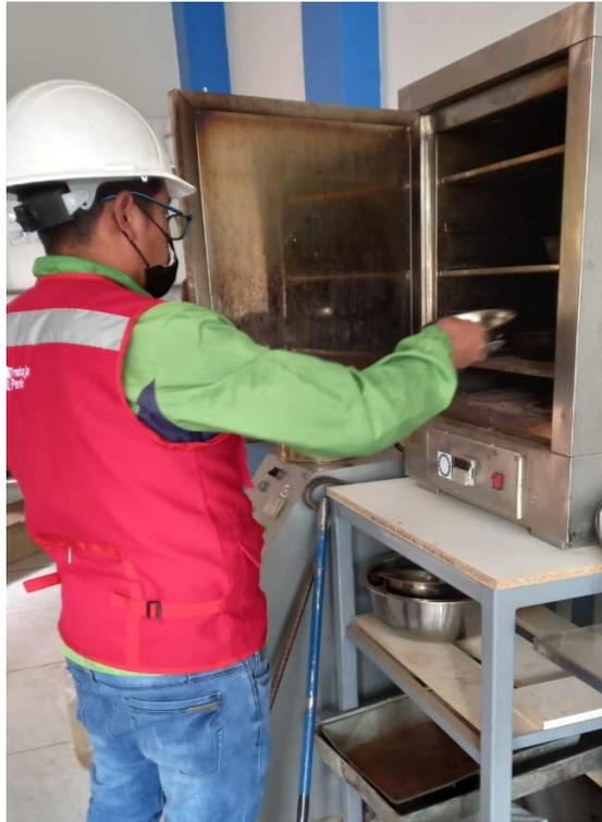
**Figura 30.** Colocación de la muestra para su secado.
