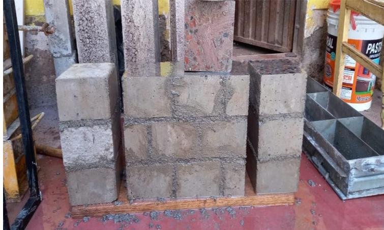
**Figura 39.** Pilas y murete elaborado para los ensayos y verificar su comportamiento.
