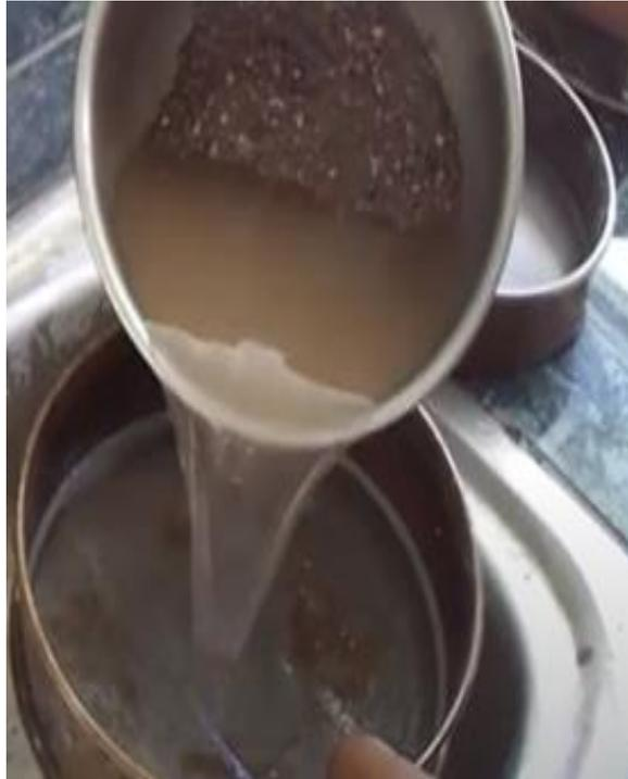
**Figura 31.** Lavado de muestra para disgregar arcilla.
