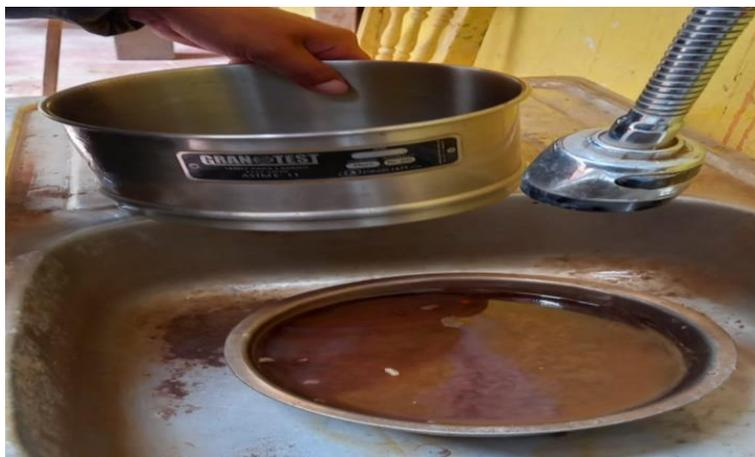
**Figura 8.** Lavado de la muestra para determinar el pasante de la malla N°200.
