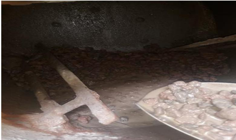
**Figura 72.** Dosificación de agregado.
