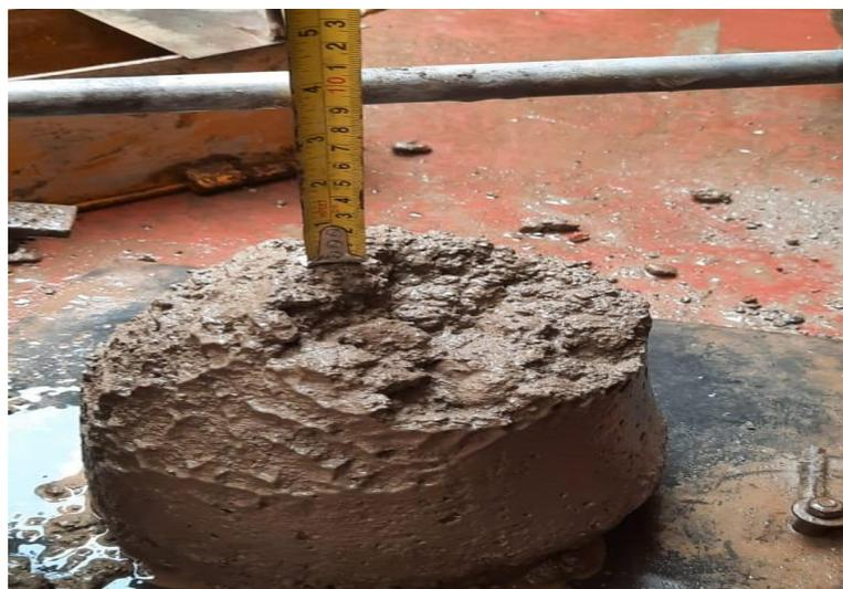
**Figura 78.** Slump asentamiento (consistencia)
