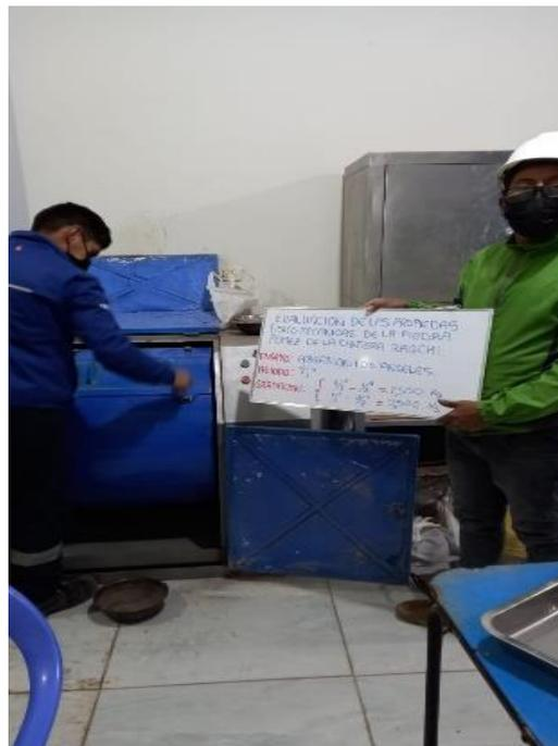
**Figura 64.** Método “A” Abrasión.
