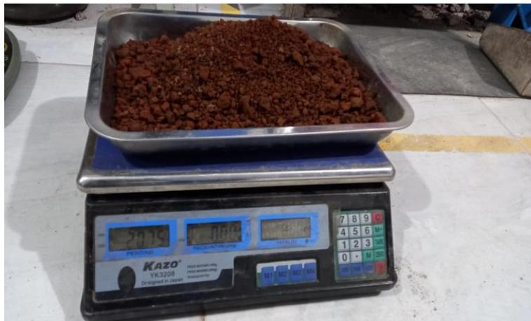
**Figura 16.** Peso de la muestra retenida por el tamiz N°12.
