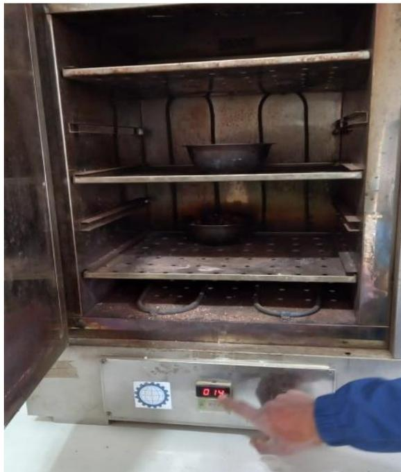
**Figura 32.** Colocado de muestra al horno para su secado.
