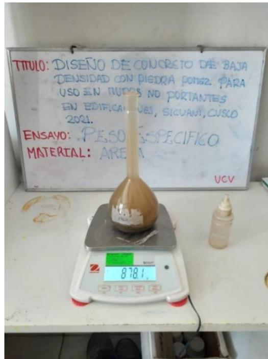
**Figura 56.** Peso específico del agregado fino.
