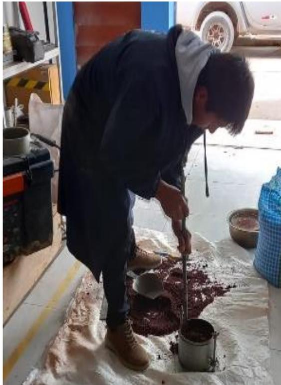
**Figura 20.** Compactado con 25 golpes con varilla de  $\frac{5}{8}$ " para cada  $\frac{1}{3}$  del molde Proctor para el PUC.
