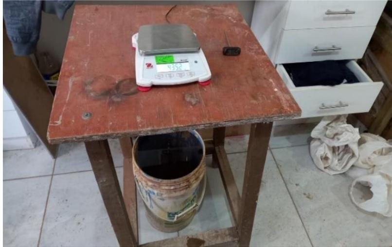
**Figura 10.** Grava sumergida en agua a 25 °C.
