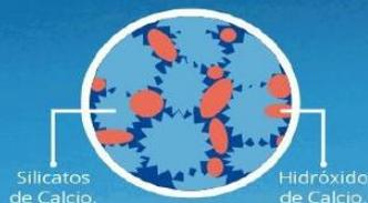
El cemento Tipo I produce un 75% de silicatos de calcio (resistencia), el otro 25% es hidróxido de calcio que no ofrece resistencia y es susceptible a los ataques químicos, produciendo erosiones y/o expansiones.
