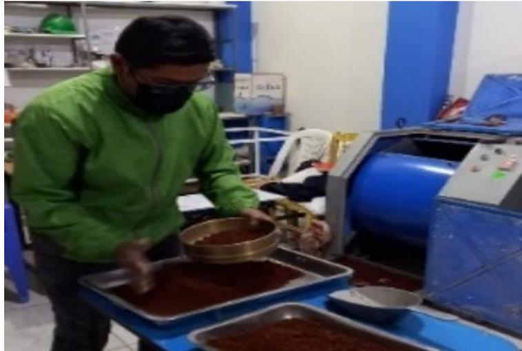
**Figura 15.** Tamizado para determinar los pesos y porcentaje de desgaste.
