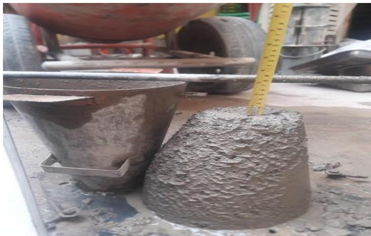
**Figura 75.** Slump asentamiento
