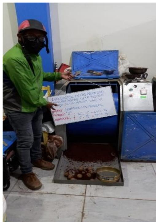
**Figura 65.** Método “B” Abrasión.
