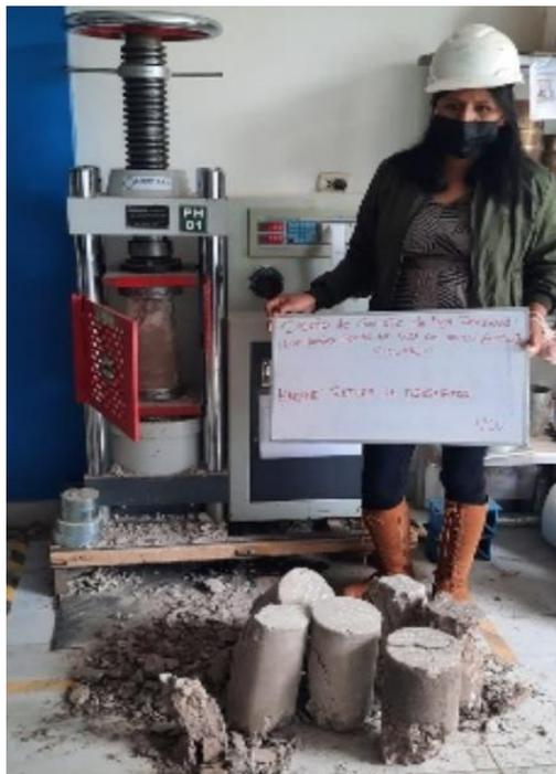
**Figura 36.** Proceso de rotura de briquetas en la prensa hidráulica.
