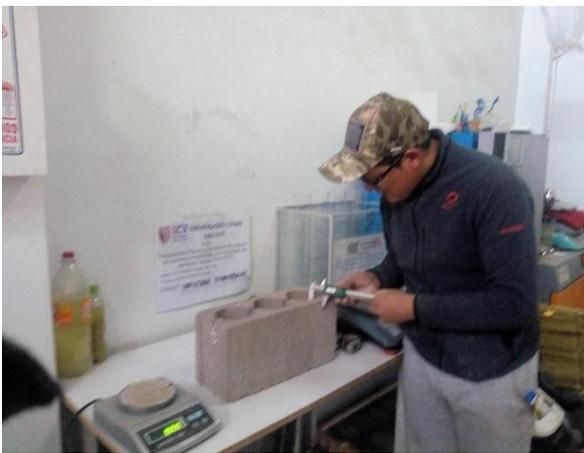
Vista 31: Se observa el ensayo de variación dimensional
