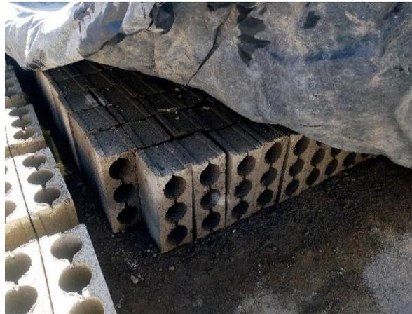
Vista 20: Se observa proceso de secado de los bloques de concreto
