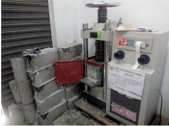
Vista 29: Se observa el ensayo de la resistencia a compresión
