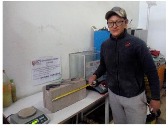
Vista 30: Se observa el ensayo de variación dimensional
