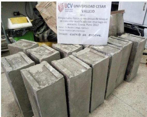
Vista 25: Se observa el capeo de los bloques de concreto
