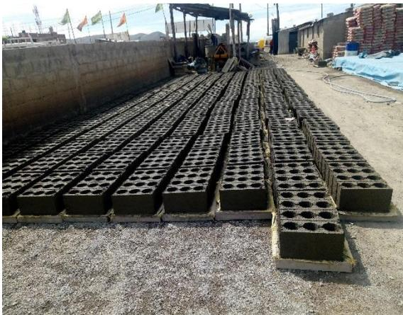
Vista 19: Se observa proceso de secado de los bloques de concreto
