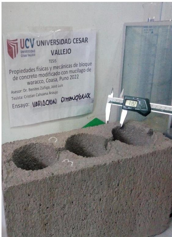
*Figura 12.* Ensayo variación dimensional
