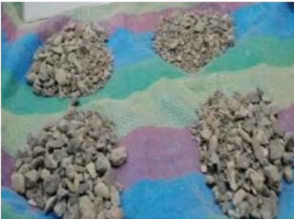
Vista 13: Se observa el cuarteo para realizar el análisis granulométrico
