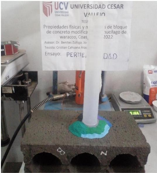
Vista 35: Se observa el ensayo de permeabilidad
