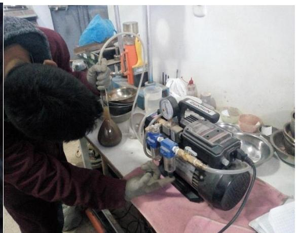
Vista 16: Se observa la extracción vacíos de la muestra
