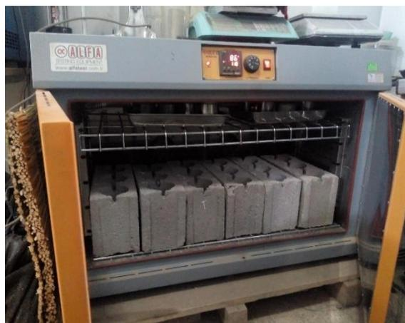
Vista 21: Se observa el secado del bloque para obtener el peso seco
