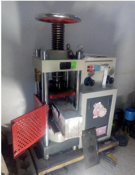
Figura 19. Resistencia a compresión
