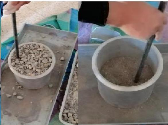
Vista 14: Se observa peso unitario o varillado del agregado fino y grueso
