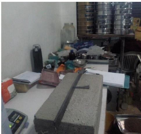
Vista 33: Se observa el ensayo de alabeo
