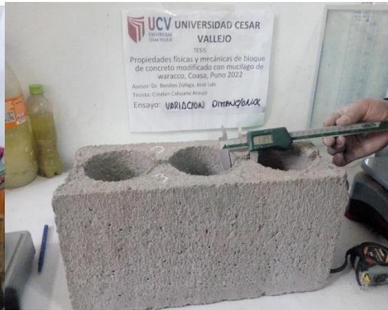
Vista 32: Se observa el ensayo de variación dimensional
