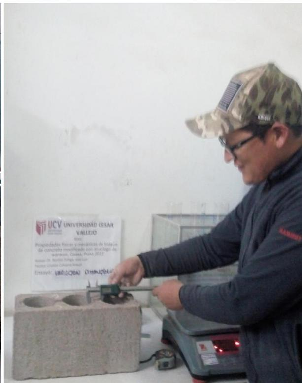
*Figura 13.* Ensayo variación dimensional
