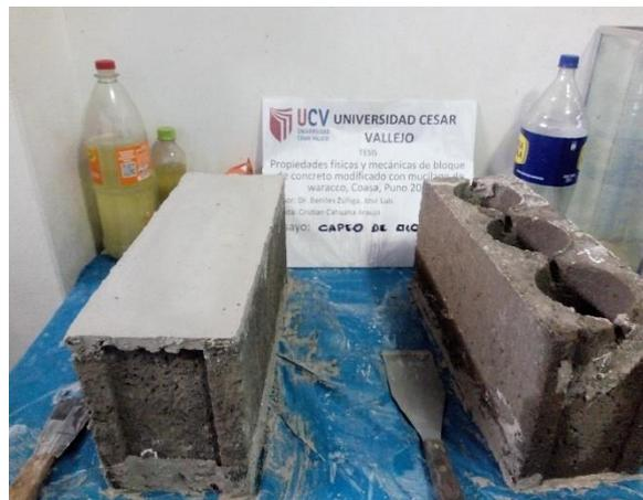
Vista 26: Se observa el capeo de los bloques de concreto
