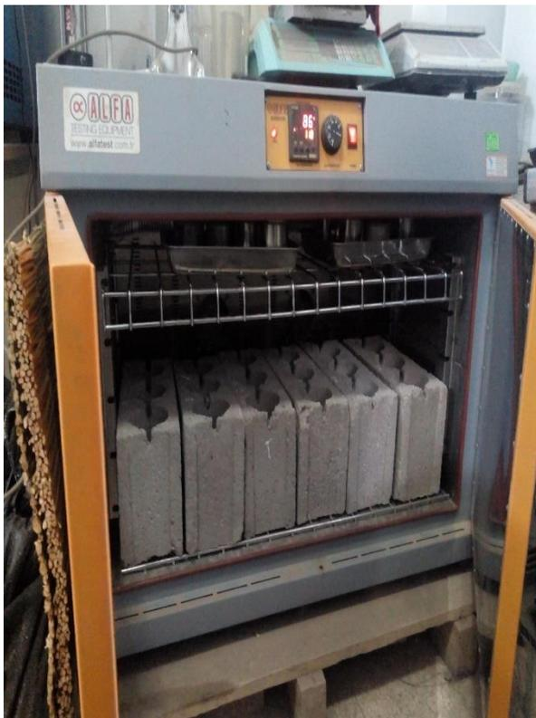
*Figura 15.* Ensayo de absorción
