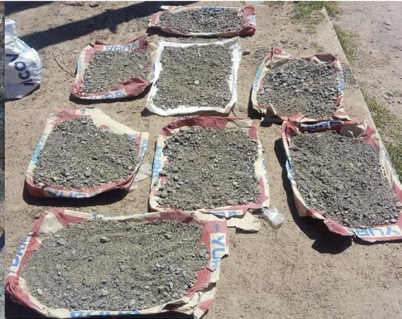
Vista 12: Se observa el proceso de secado para realizar el diseño de mezclas
