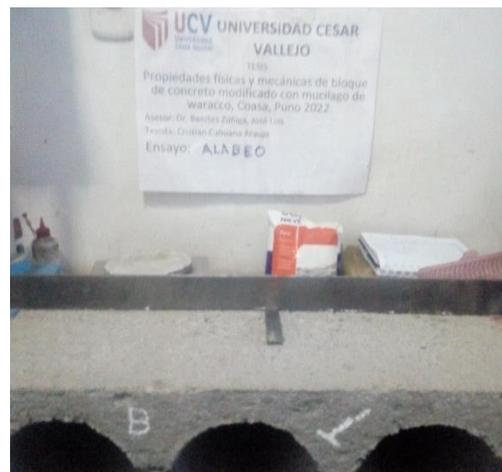
Vista 34: Se observa el ensayo de alabeo
