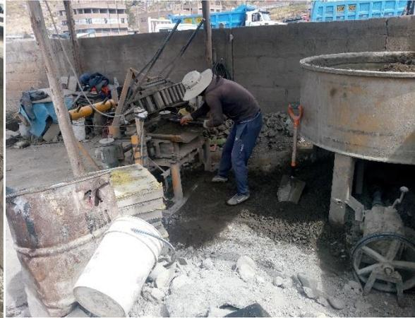
Vista 18: Se observa el proceso de fabricado de bloques de concreto
