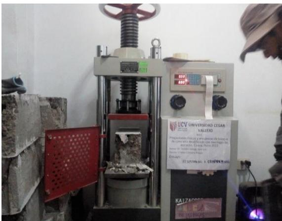
Vista 27: Se observa el ensayo de la resistencia a compresión
