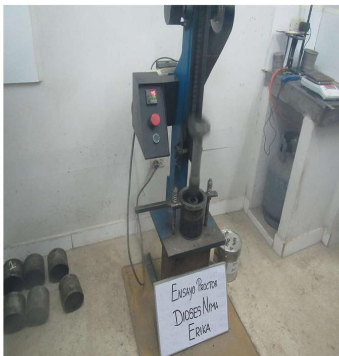
**Figura N°30:** Muestra colocada en la compactadora mecánica
