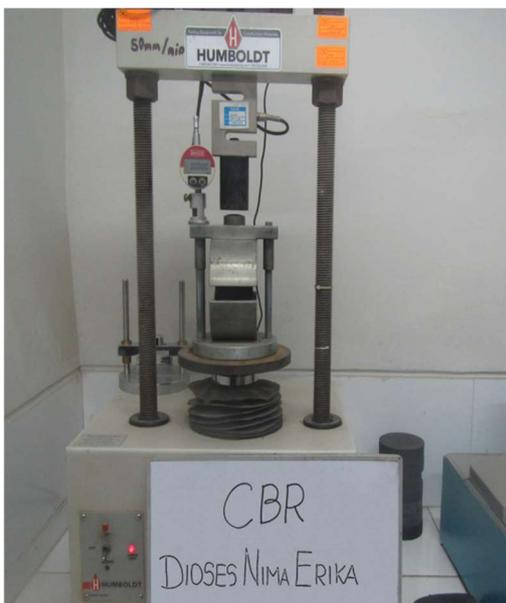
**Figura N° 23:** Ensayo de CBR
