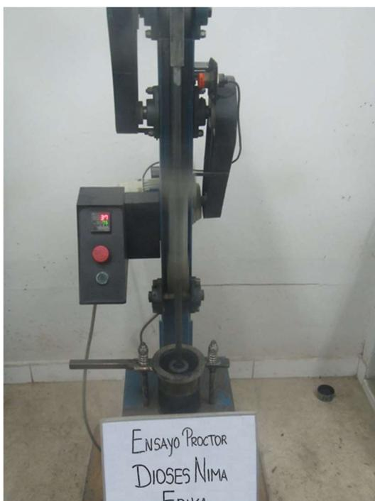
**Figura N°29:** Ensayo de Proctor Modificada
