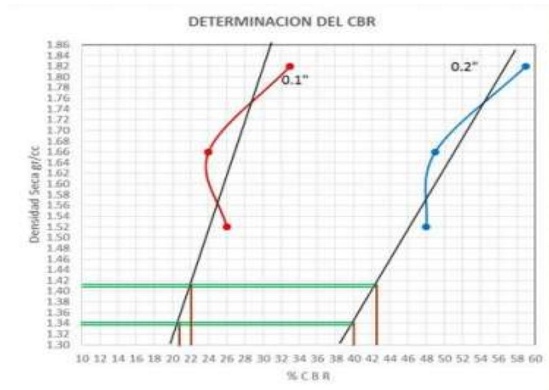
**Figura N° 20:** C.B.R. vs densidad seca de la calicata C-1 adicionando el 7% de ceniza de cáscara de arroz
