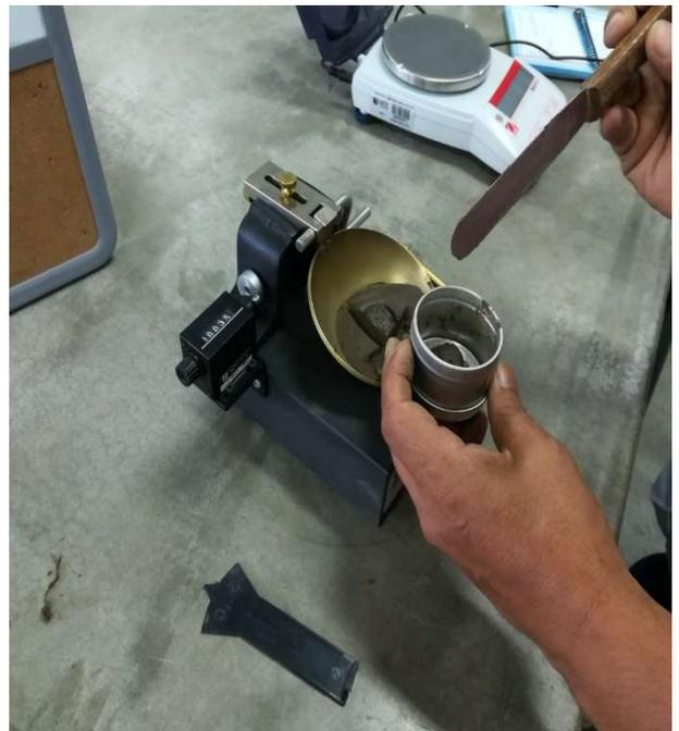
**Figura N°27:** Ensayo de Límites de Atterberg
