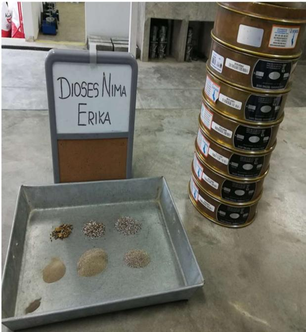
**Figura N°26:** Ensayo de Análisis Granulometrico
