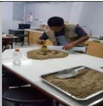
Foto 4. Adición de agua al suelo para el ensayo de Proctor modificado (C-01)
