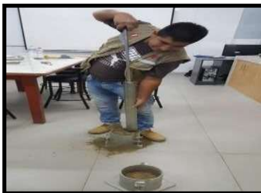
Figura 24: Aplicación del pisón Proctor modificado
