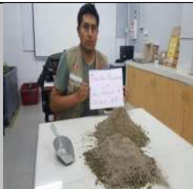
Foto 3. Mezcla del suelo - cenizas de caña de azúcar para ensayo de Proctor
