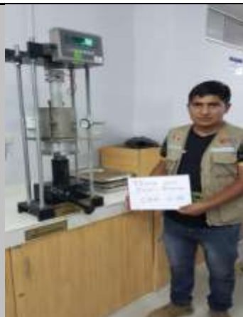
Foto 6. Ensayo de CBR para la calicata (C-01)
