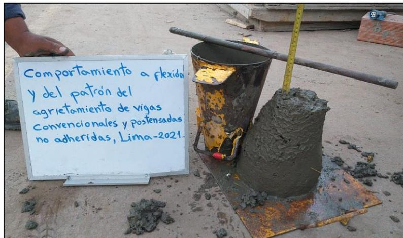
Figura 15. Ensayo de asentamiento
