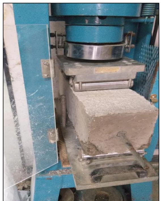
Viga postensada lista para ser ensayada.
