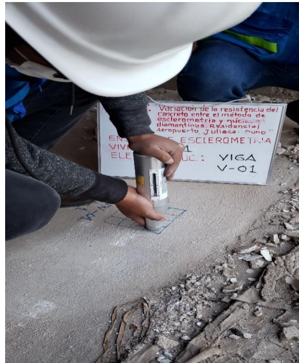
Fotografía 1 y 2: Se realizó los ensayos con esclerómetro en los elementos estructurales (columnas y vigas) de las viviendas Residencial Aeropuerto.
