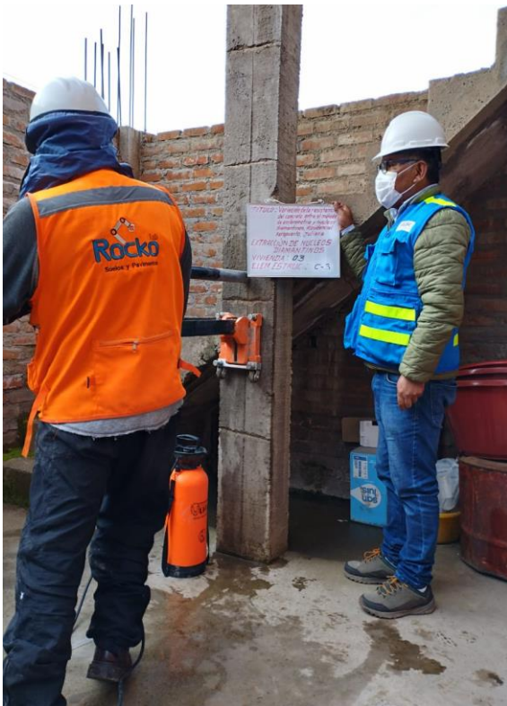
Fotografía 16, 17, 18 y 19: Se muestra realizando ensayos de extracción de núcleos diamantinos en elementos estructurales (columnas y vigas).
