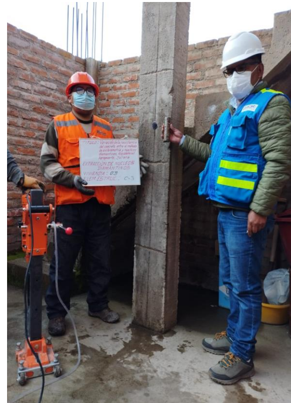
Fotografía 16, 17, 18 y 19: Se muestra realizando ensayos de extracción de núcleos diamantinos en elementos estructurales (columnas y vigas).
