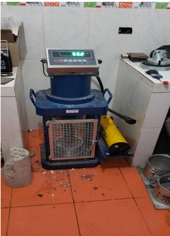
Fotografía 20, 21, 22 y 23: Se muestra realizando ensayos de resistencia a la compresión a los núcleos diamantinos de los elementos estructurales (columnas y vigas)
