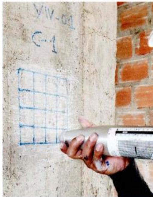
FOTO N°2: DETALLE DE CUADRÍCULA EN SUPERFICIE DE IMPACTO
