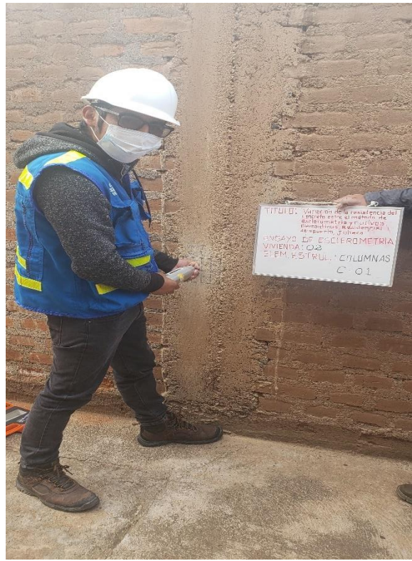
Fotografía 12, 13, 14 y 15: Se muestra realizando ensayos de esclerometría en elementos estructurales (columnas y vigas).
