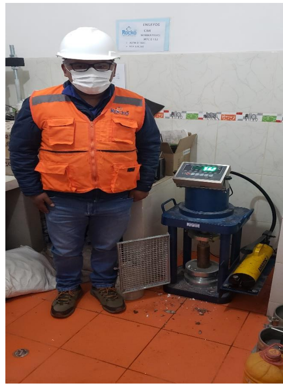
Fotografía 20, 21, 22 y 23: Se muestra realizando ensayos de resistencia a la compresión a los núcleos diamantinos de los elementos estructurales (columnas y vigas)
