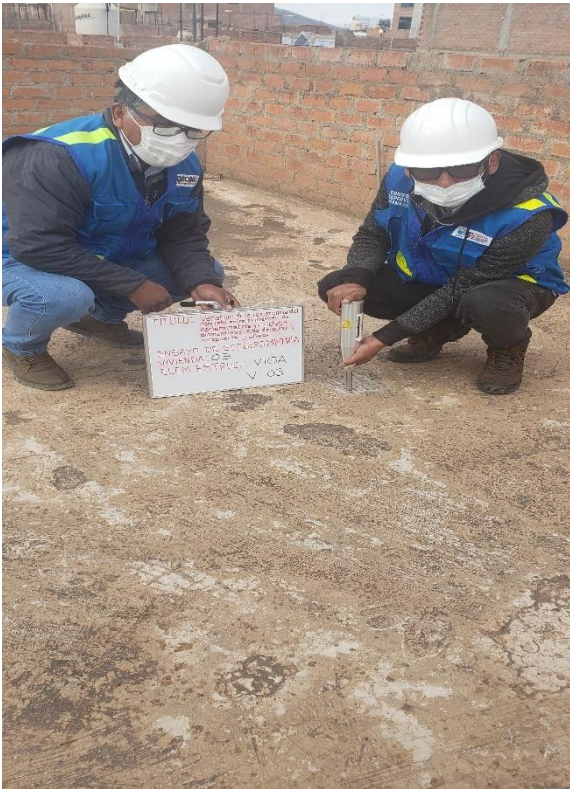
Fotografía 12, 13, 14 y 15: Se muestra realizando ensayos de esclerometría en elementos estructurales (columnas y vigas).
