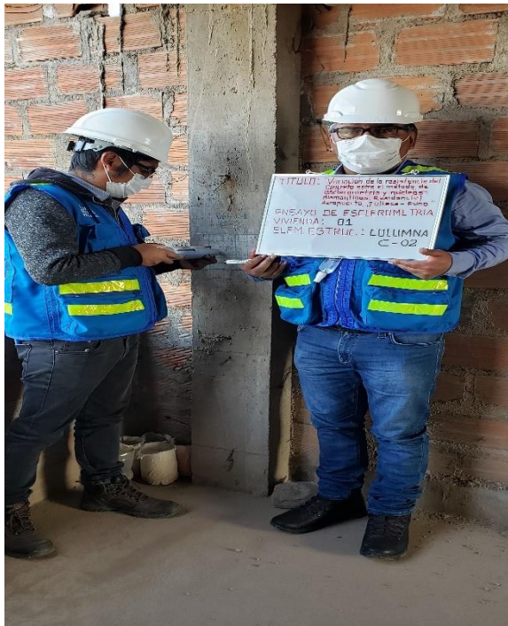
Fotografía 1 y 2: Se realizó los ensayos con esclerómetro en los elementos estructurales (columnas y vigas) de las viviendas Residencial Aeropuerto.
