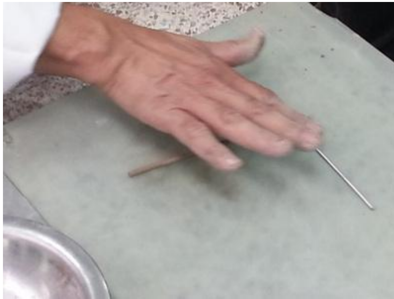
Figura 11: Barritas formadas para determinar la plasticidad
