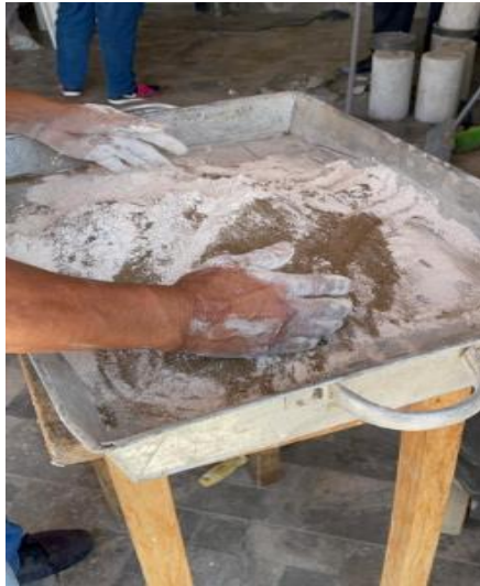
Figura 27: Procedimiento de mezclado C-03, C-04 (SUELO NATURAL+8% de CAL).
