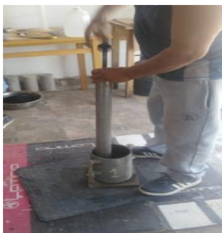
Figura 24: Ensayo de Compactación C-01, C-02 (ESTADO NATURAL) (Proctor Modificado)
