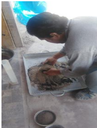
Figura 29: Procedimiento de mezclado C-01, C-02 (SUELO NATURAL+8% de CAL).
