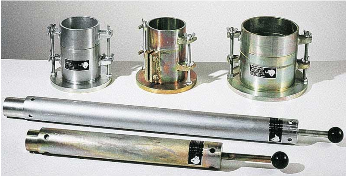
Figura 14: Equipo utilizado para la realización del ensayo de Proctor modificado
