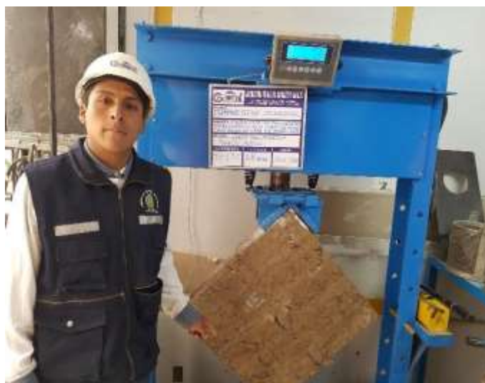
Figura 4.16 Ensayo a compresión diagonal
