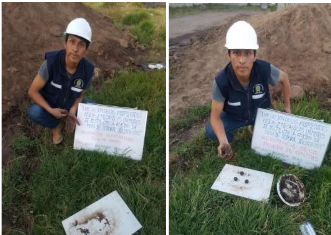
Fotografía 4: Prueba de cinta de barro y resistencia seca del material
