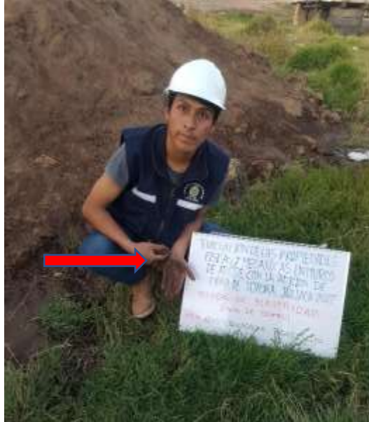
Figura 4.4 Prueba de elasticidad (cinta de barro)
