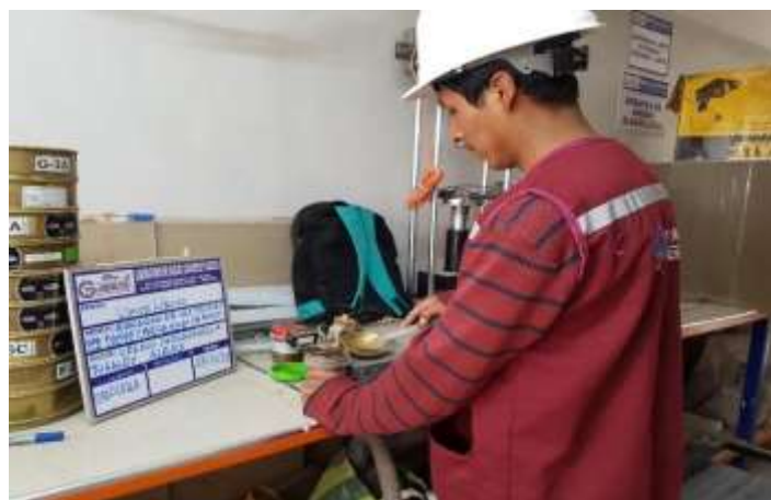
Figura 3.4 Ensayo de copa de casagrande
