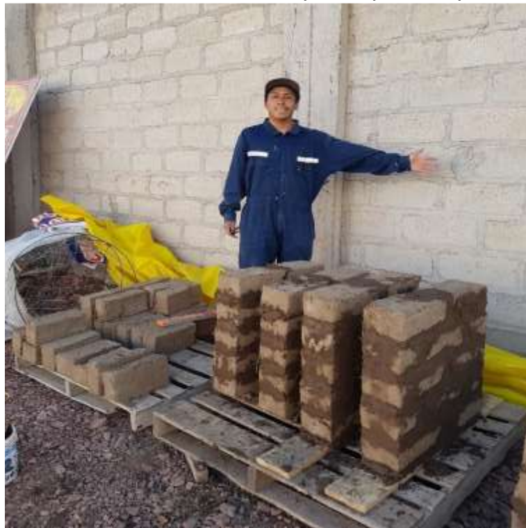
Fotografía 14: Elaboración de los muretes patrón para las pruebas mecánicas
