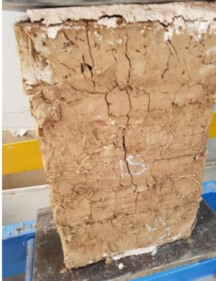
Fotografía 17: Prueba de resistencia a compresión axial
