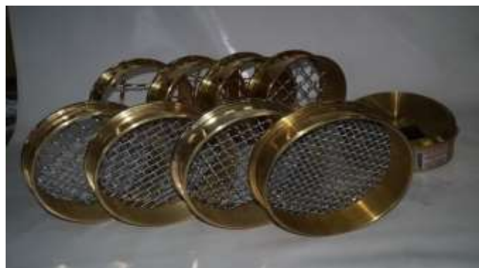
Figura 2.10 Granulometría por tamices
