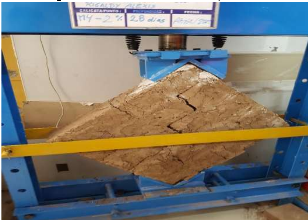
Fotografía 18: Prueba de resistencia a compresión axial
