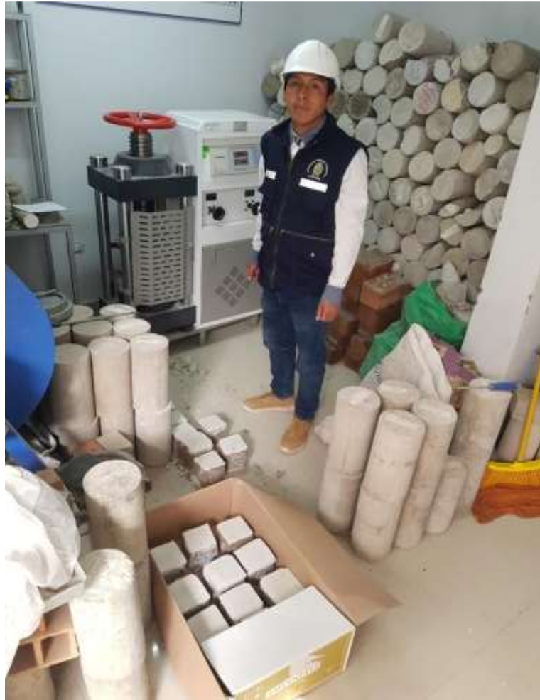
Fotografía 16: Especímenes P+0.5% y P+1.0% de muretes de adobe con adición de totora
