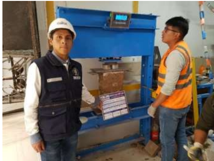
Figura 4.14 Ensayo de resistencia a compresión de pilas
