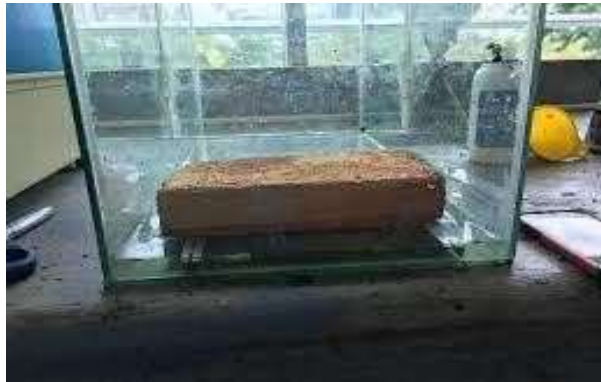
Figura 2.5 Ensayo de absorción del adobe
