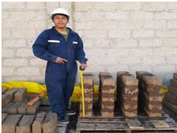
Figura 3.13 Elaboración de pilas y muretes para los ensayos
