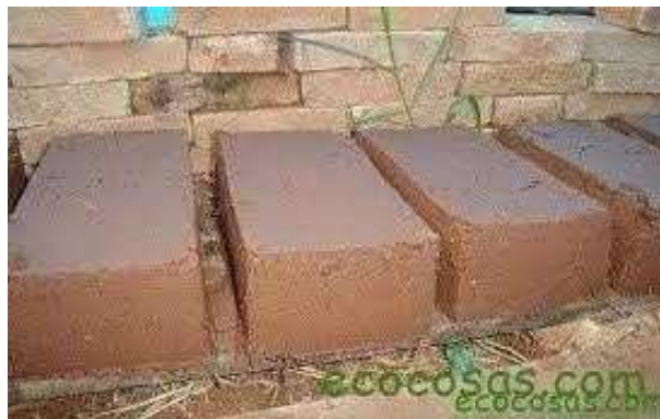
Figura 2.1 Fabricación del adobe
