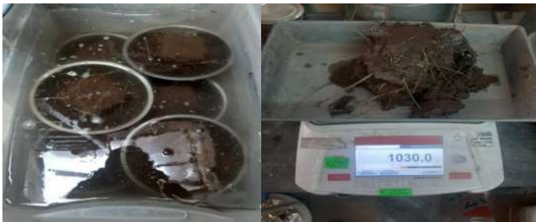
Figura 4.10 Ensayo de absorción del adobe
