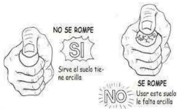
Figura 2.3 Ensayo de presencia de arcilla (fuente: norma E0.80)
