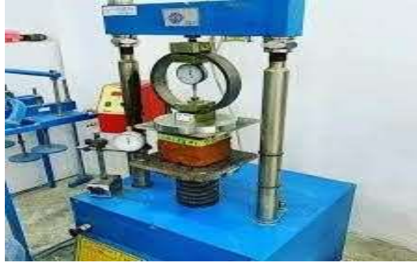
Figura 2.6 Ensayo de compresión simple
