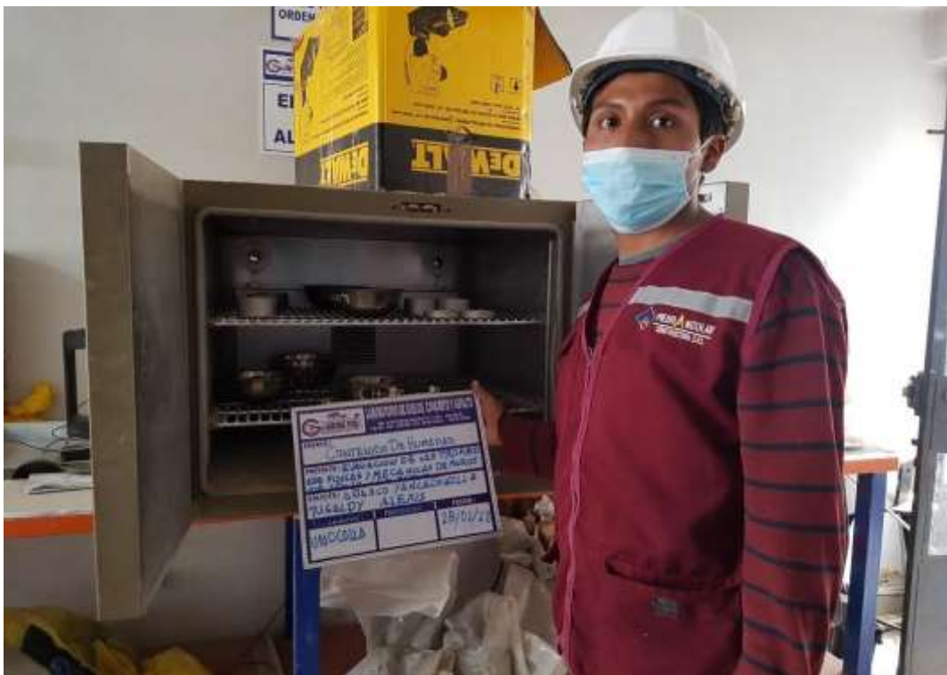
Fotografía 2: Ensayo de contenido de humedad de las muestras de suelo
