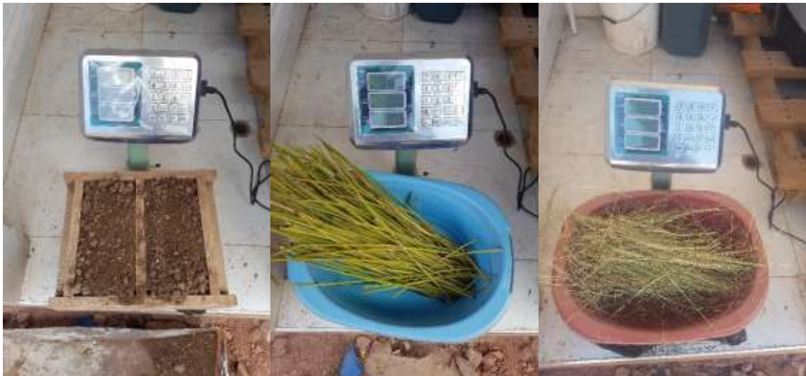
Fotografía 6: Peso de las totoras y paja en relación al peso del suelo
