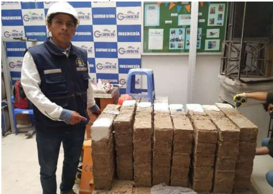
Fotografía 16: Especímenes P+0.5% y P+1.0% de muretes de adobe con adición de totora
