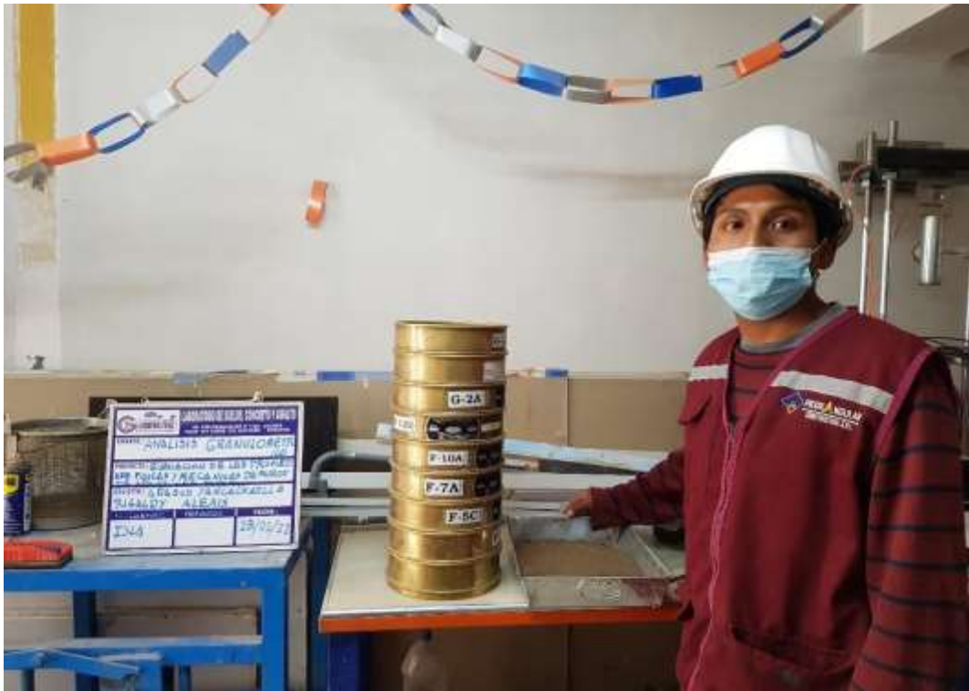
Fotografía 1: Análisis granulométricos de las muestras de suelo.
