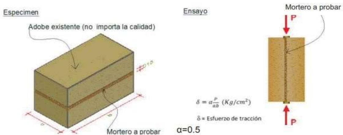
Figura 7. Ensayo de resistencia del mortero a la tracción
