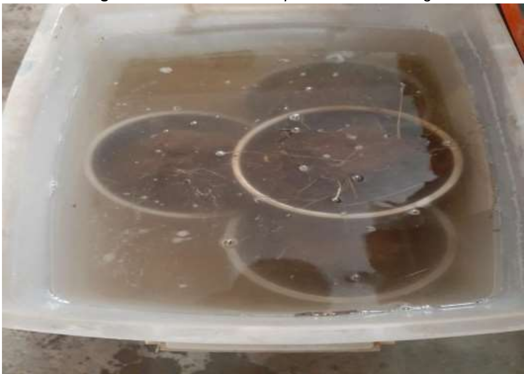
Fotografía 12: Muestra de bloque de adobe sumergida
