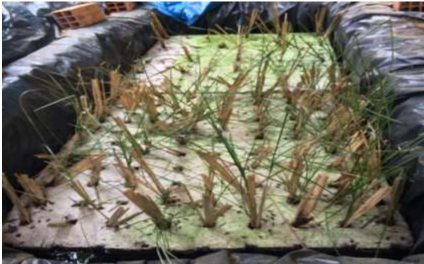
Figura N° 4: Posas de oxidación con pasto vetiver.
