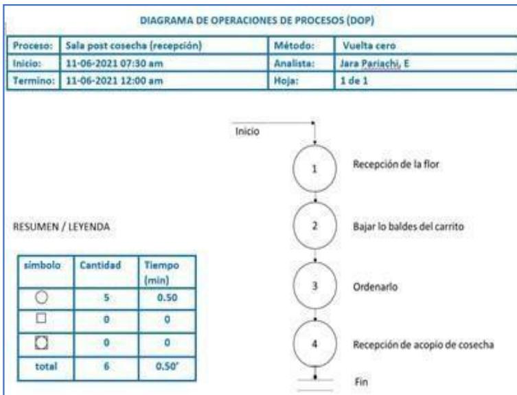
**Figura 6: Diagrama de operaciones del proceso de recepción**
