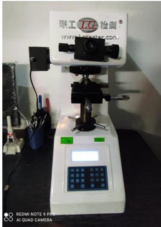
“Microdurómetro Vickers Electrónico” (LG-HV 100) con Vernier Digital, Mitutoyo 200mm
