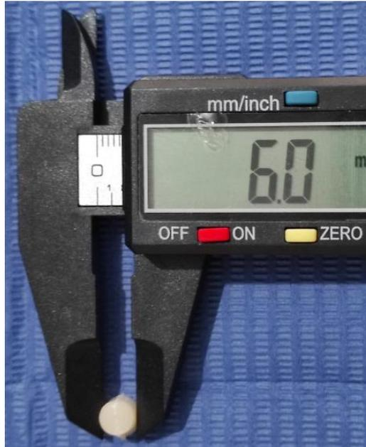
Calibración de Cilindros de resina compeusta a 6mm de diámetro
