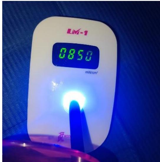
Calibración de lampara Led RTA Mini S (Woodpecker) en 850 mW/cm<sup>2</sup>
