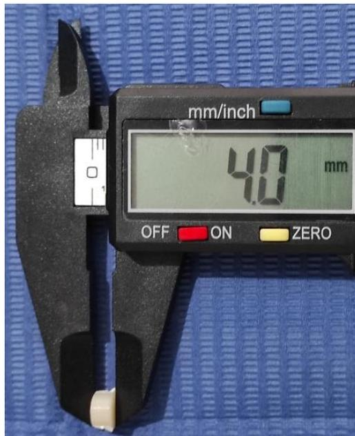
Calibración de Cilindros de resina compeusta a 4mm de altura
