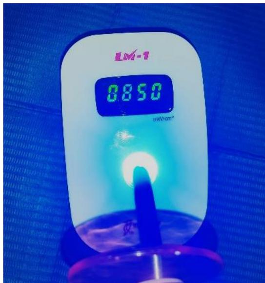
Calibración de lampara Led RTA Mini S (Woodpecker) en 850 mW/cm<sup>2</sup>
