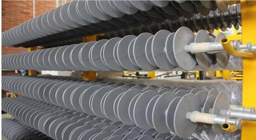
*Figura 08:* Aisladores poliméricos para líneas de transmisión.
