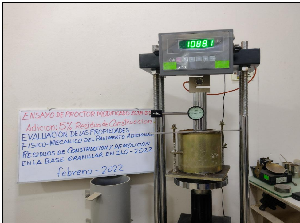
Ensayo de Proctor modificado para la primera dosificación del 5%
