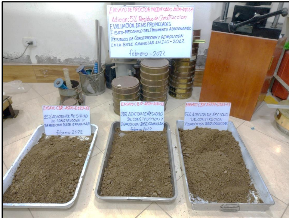
Ensayo de Proctor modificado para la primera dosificación del 5% de material base granular y residuos de construcción y demolición.
