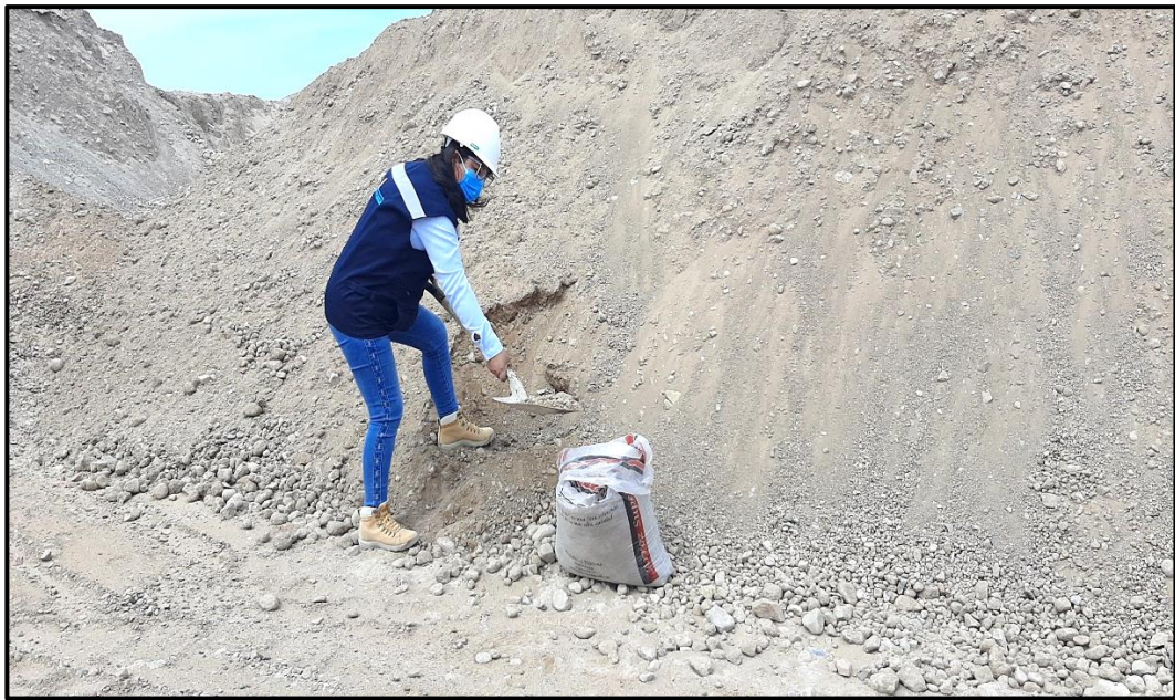
Recojo del Material granular de la cantera Belu Ninaja
