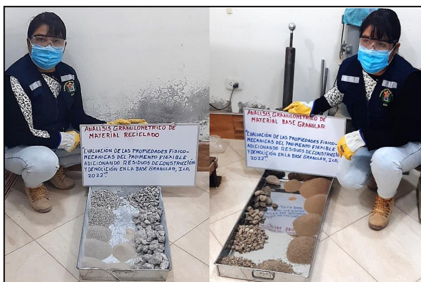
Figura 29. Ensayo de muestra tamizado de RCD y material base granular
