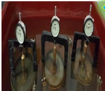
Ensayo de CBR
