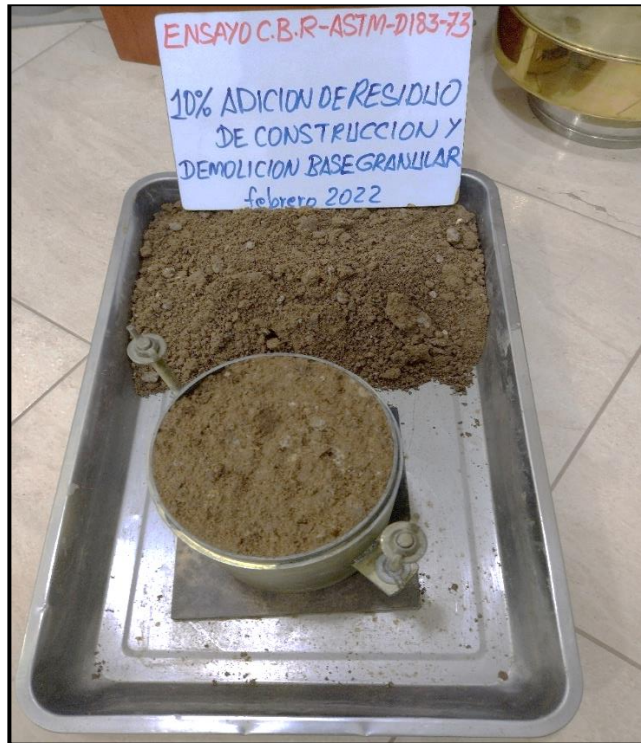
Ensayo de CBR para la primera dosificación del 10% de material base granular y residuos de construcción y demolición.
