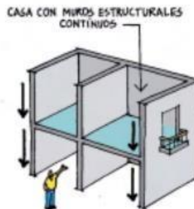
Figura 4. Sistema estructural de muros estructurales.
